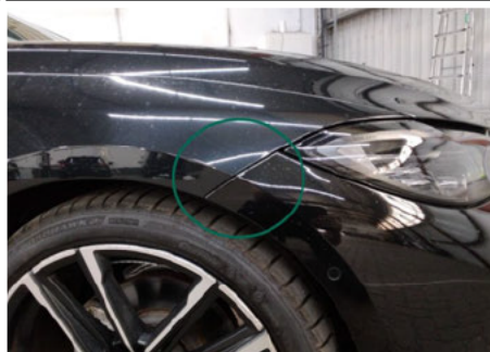
Stoßfänger / Vorne / Schlecht Repariert
