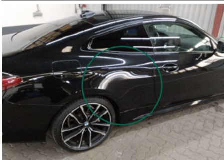
Seitenwand / Rechts / Schlecht Repariert
