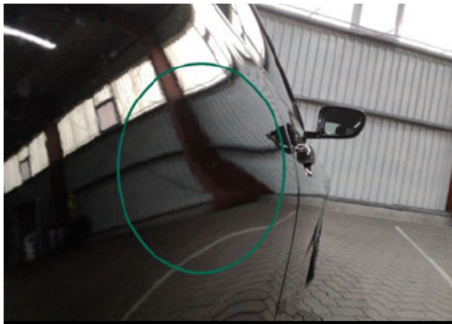
Seitenwand / Rechts / Schlecht Repariert
