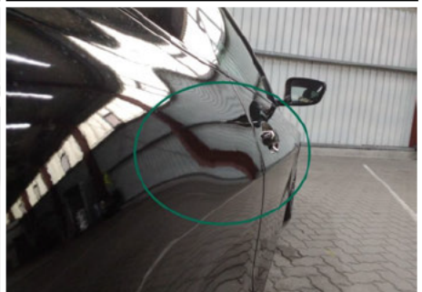
Seitenwand / Rechts / Schlecht Repariert
