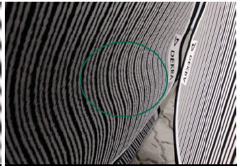
Tür / Vorne Rechts / Schlecht Repariert
