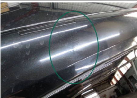
Dachholm / Rechts / Schlecht Repariert
