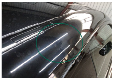
Dachholm / Rechts / Schlecht Repariert
