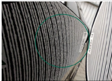
Tür / Vorne Rechts / Schlecht Repariert
