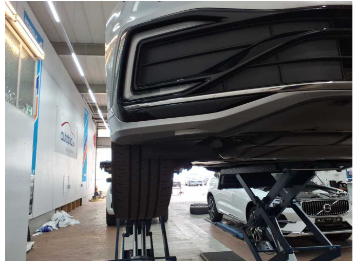
Damage 6: Front bumper: Front bumper (Mit Blenden L und Zierleiste L+ Spoiler) - Deformed - repair according to calculation
