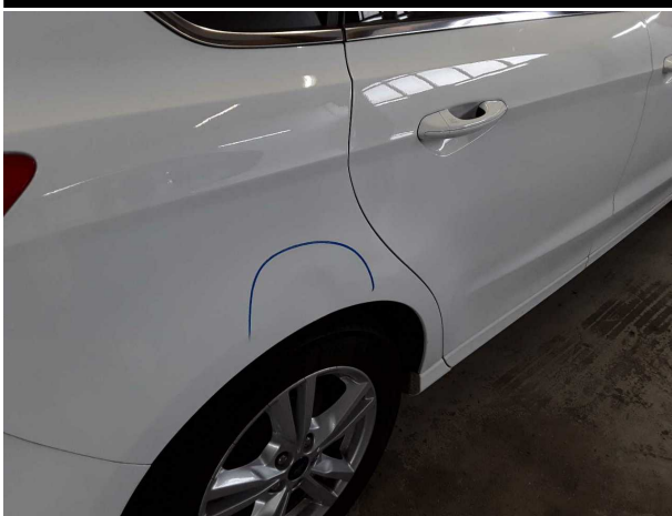
Beschädigung #8: Seitenwand rechts: Seitenwand - Delle(n) - instandsetzen und lackieren
