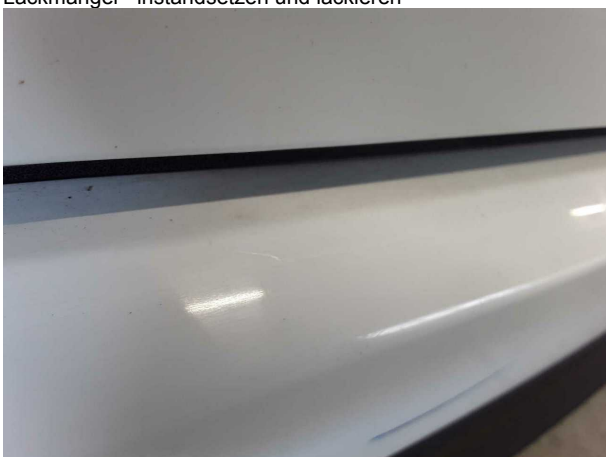
Beschädigung #7: Stossfänger hinten: Stossfänger hinten - Lackmangel - instandsetzen und lackieren
