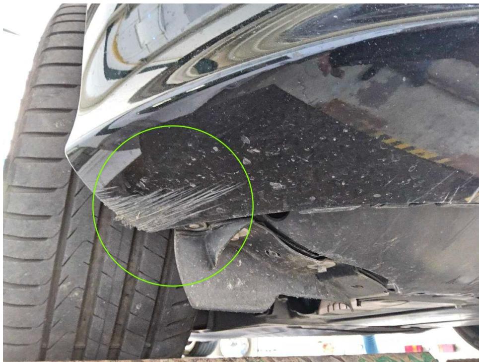
Bild 21 : Stoßfänger vorn zerkratzt
