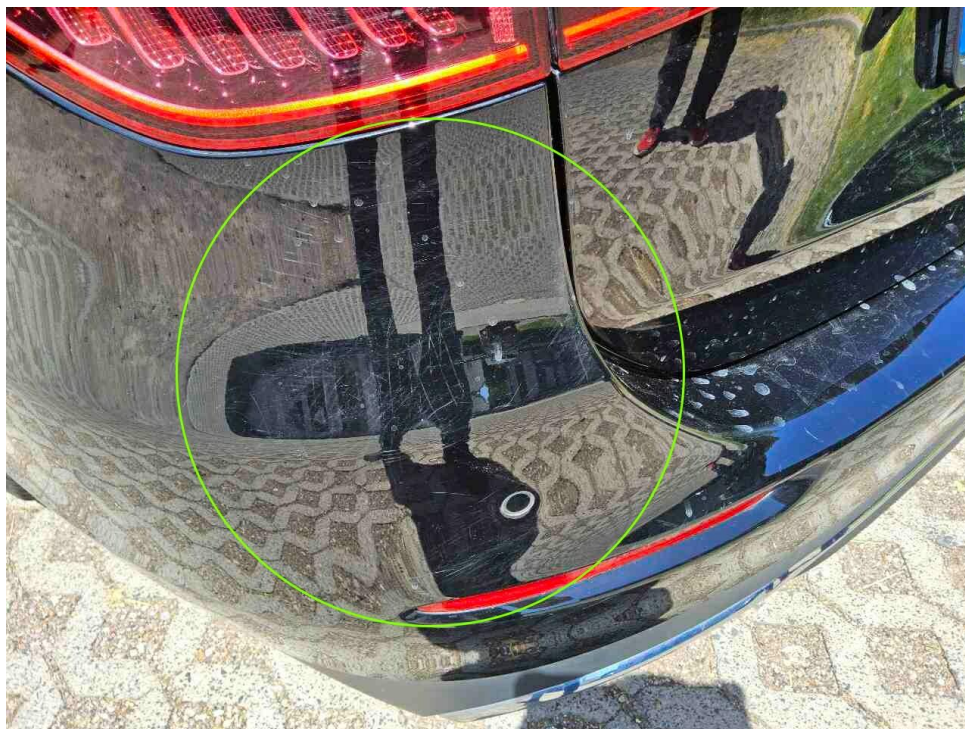
Bild 15 : Stoßfänger hinten zerkratzt
