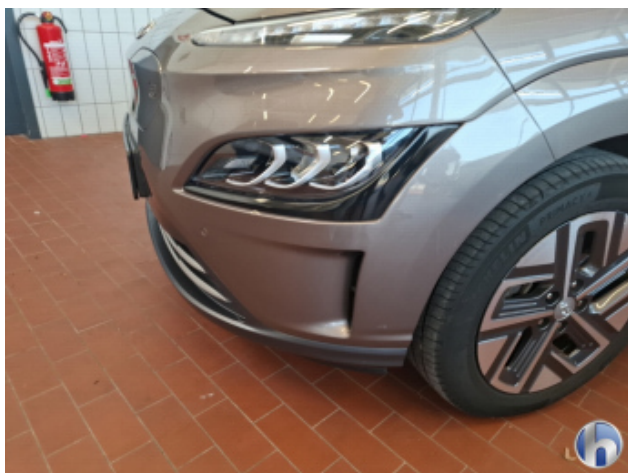
1. Stoßfänger Vorne Abschürfung - Smart Repair
