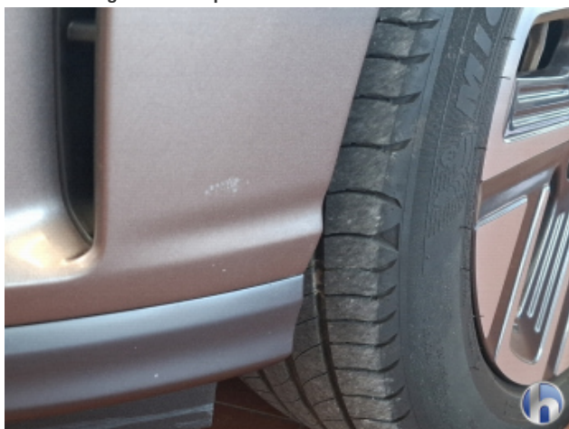
1. Stoßfänger Vorne Abschürfung - Smart Repair
