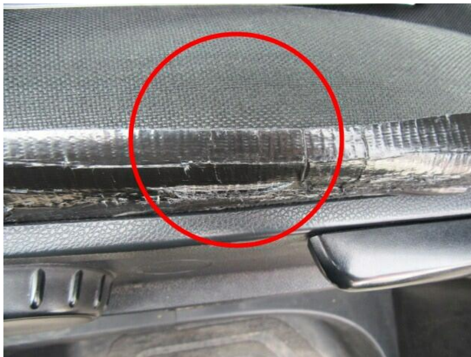
Bild 12 : Sitzbezug und Polster vorne links schadhaft
