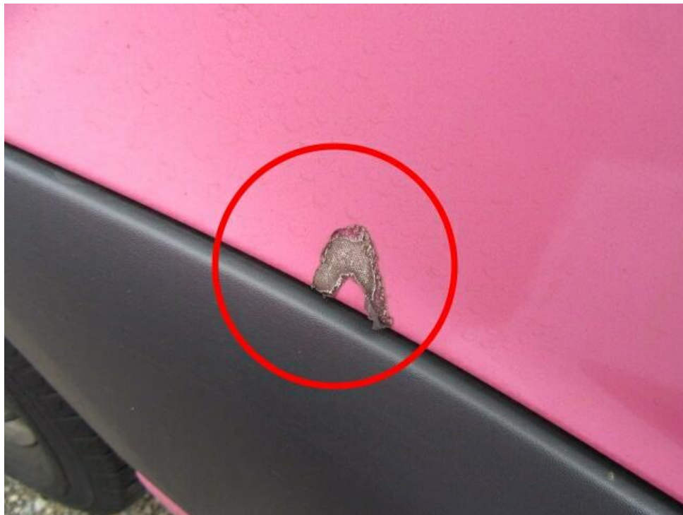
Bild 16 : Seitenwand hinten links eingedrückt
