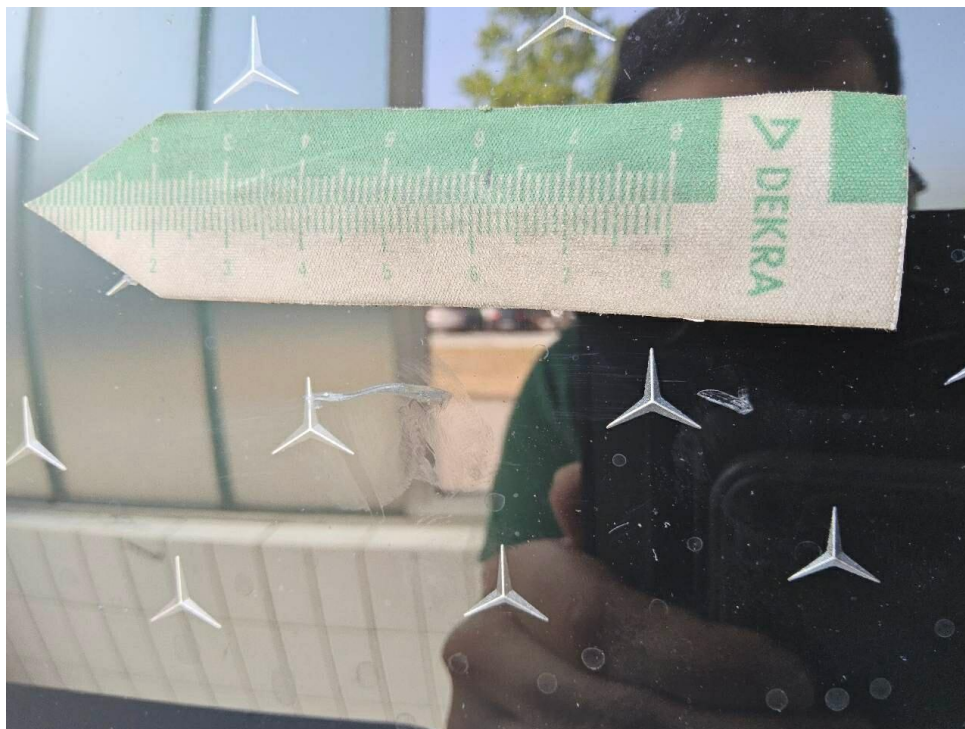
Bild 25 : Stoßfängerverkleidung vorne Kühlergrill verschrammt
