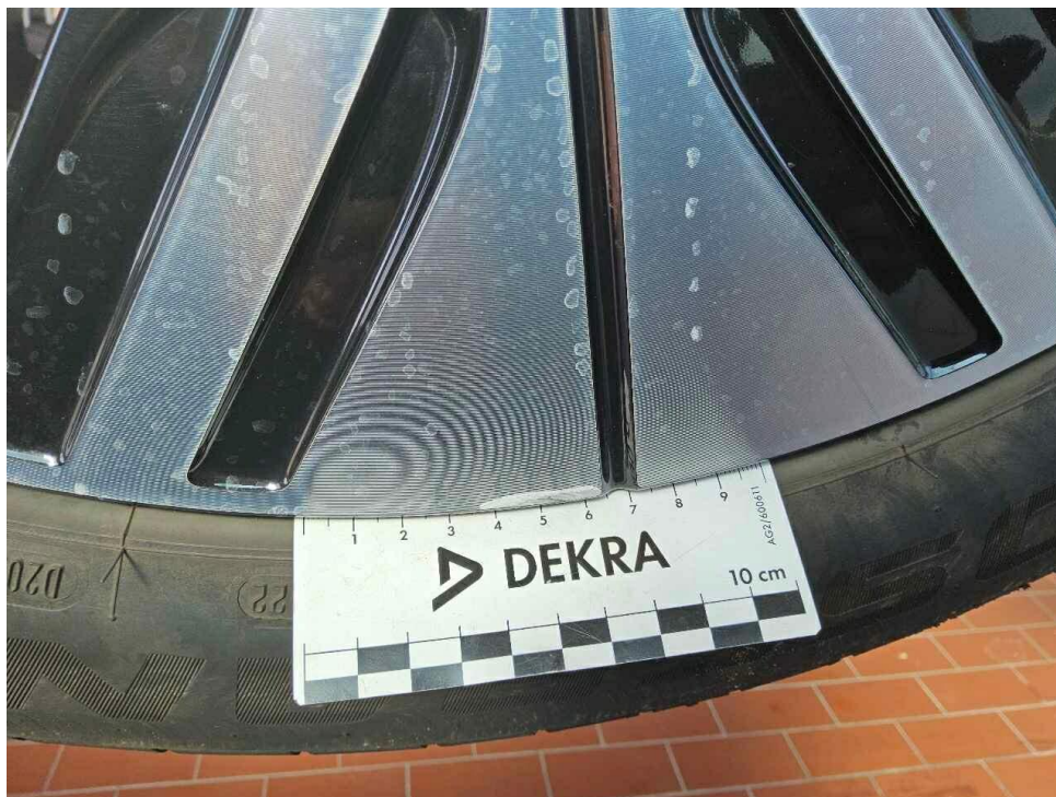
Bild 19 : Leichtmetallrad glanzgedreht hinten rechts verschrammt
