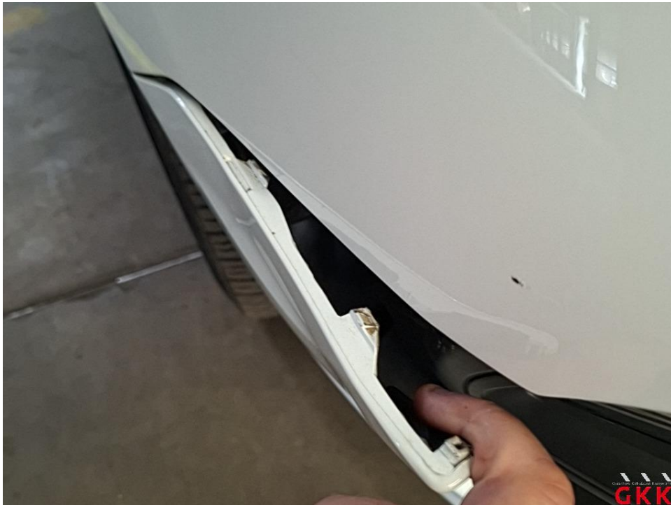
Bild 19 Stoßfänger vorne, Verkleidung unterhalb -lackiert-, beschädigt, ersetzen
