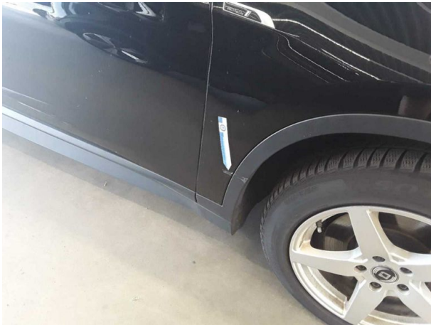
Beschädigung #8: Kotflügel rechts: Kotflügel rechts - verkratzt / verschürft - lackieren
