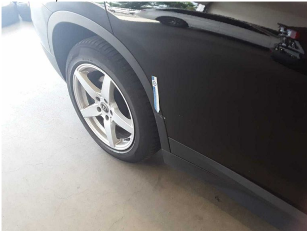
Beschädigung #5: Seitenwand rechts: Radhausverbreiterung - verkratzt / verschürft - erneuern
