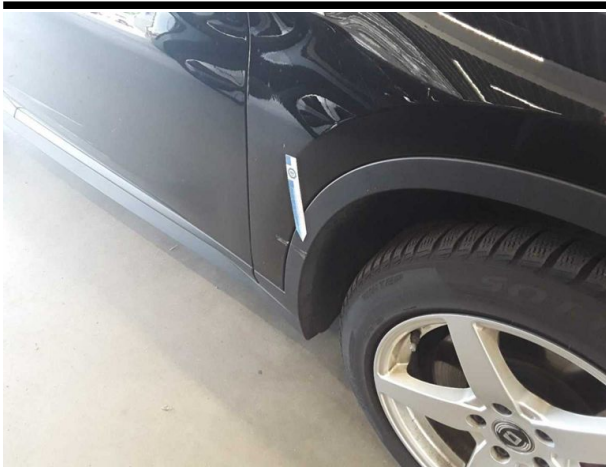
Beschädigung #7: Kotflügel rechts: Radhausverbreiterung - verkratzt / verschürft - erneuern
