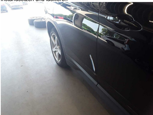
Beschädigung #11: Tür hinten rechts: Tür - verformt - erneuern
