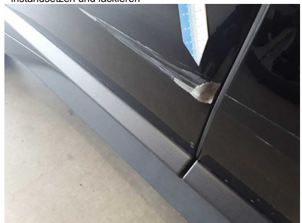
Beschädigung #11: Tür hinten rechts: Tür - verformt - erneuern
