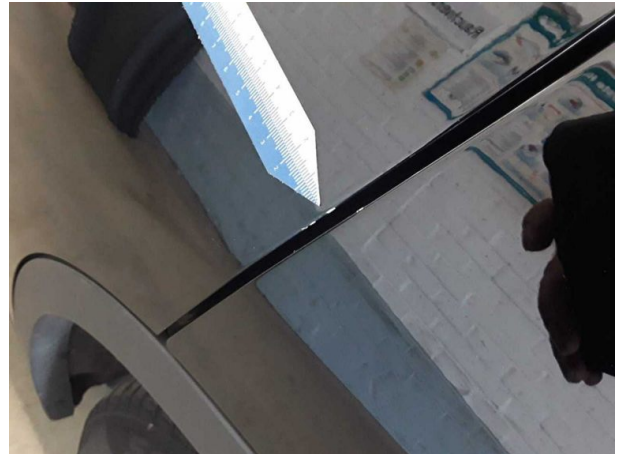
Beschädigung #1: Tür hinten links: Türkante - verkratzt / verschürft - auslegen / polieren
