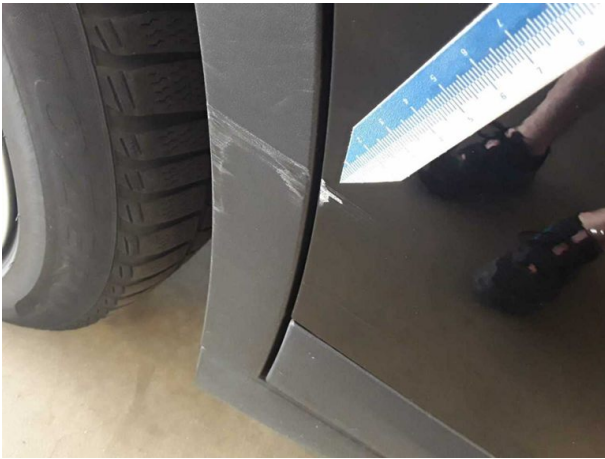
Beschädigung #11: Tür hinten rechts: Tür - verformt - erneuern
