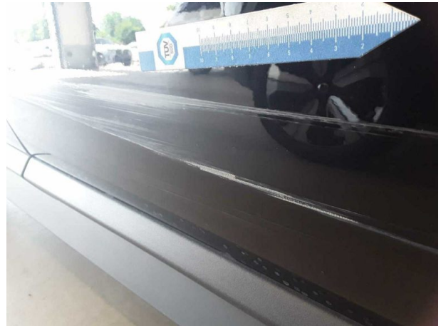
Beschädigung #10: Tür vorn rechts: Tür - verkratzt / verschürft - instandsetzen und lackieren
