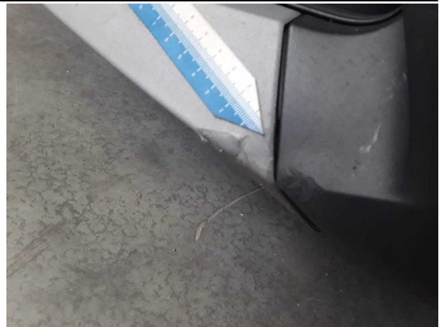
Beschädigung #4: Stossfänger vorn: Lufteinlassgitter (Blende mitte unten) - verformt - erneuern
