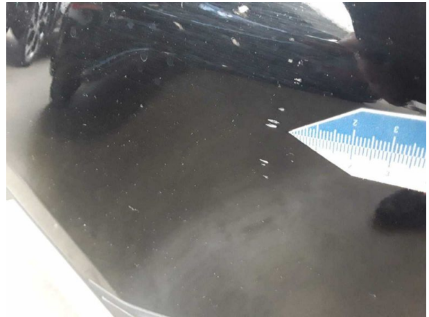
Beschädigung #9: Stossfänger vorn: Stossfänger vorn - verkratzt / verschürft - instandsetzen und lackieren
