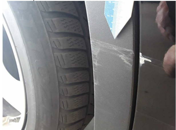
Beschädigung #5: Seitenwand rechts: Radhausverbreiterun... verkratzt / verschürft - erneuern
