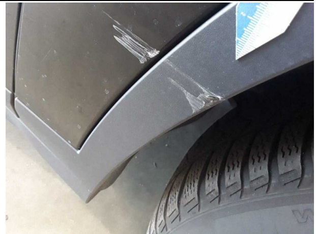
Beschädigung #7: Kotflügel rechts: Radhausverbreiterung - verkratzt / verschürft - erneuern
