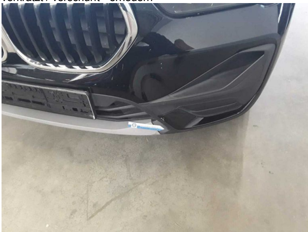
Beschädigung #6: Stossfänger vorn: Stossfänger vorn (unlackiert) - verkratzt / verschürft - erneuern
