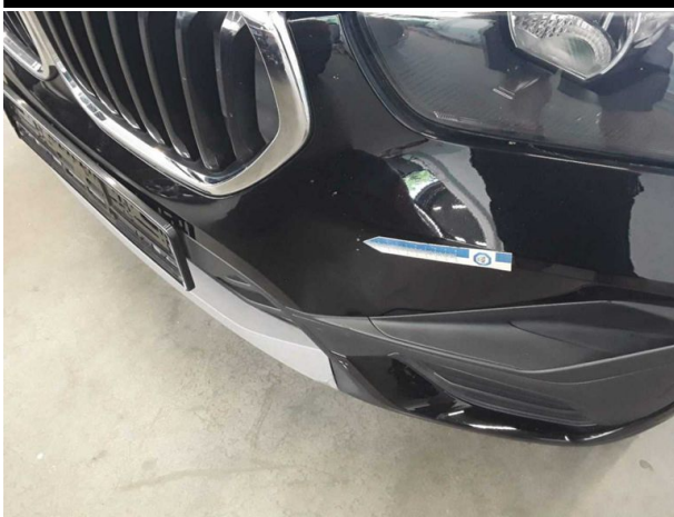
Beschädigung #9: Stossfänger vorn: Stossfänger vorn - verkratzt / verschürft - instandsetzen und lackieren
