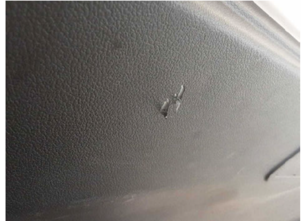
Beschädigung #4: Verkleidungen/Abdeckungen: Heckdeckel, Innenverkleidung - verkratzt / verschürft - Wertminderung
