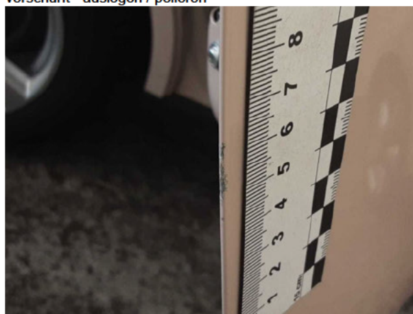
Beschädigung #2: Tür hinten rechts: Türkante - verkratzt / verschürft - Smart Repair
