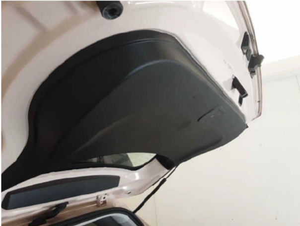
Beschädigung #4: Verkleidungen/Abdeckungen: Heckdeckel, Innenverkleidung - verkratzt / verschürft - Wertminderung
