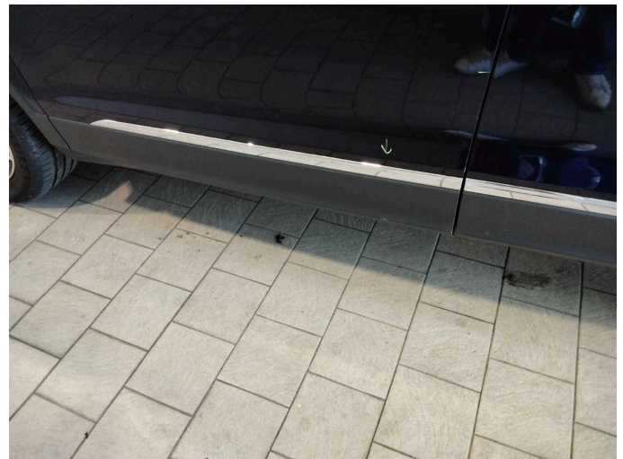
Damage 9: Door - front left side: Brightware - lower (Kunststoffleiste) - Scratch(es) - Replace
