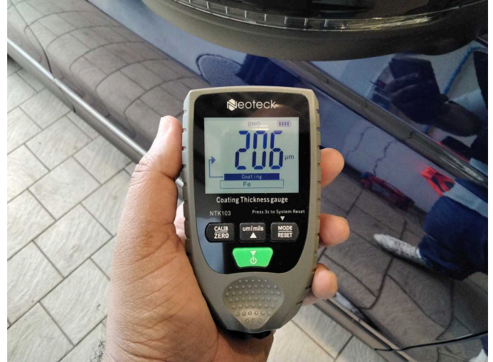
Door - front right side: 206 \mu\text{m}
