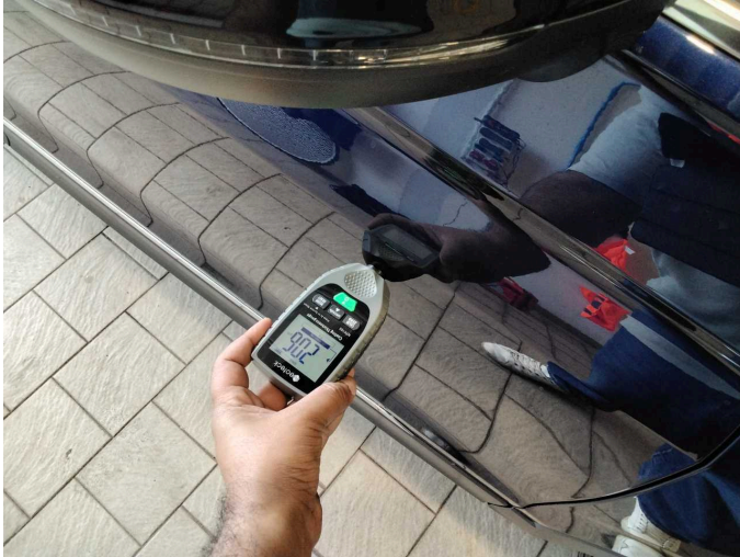
Door - front right side: 206 \mu\text{m}
