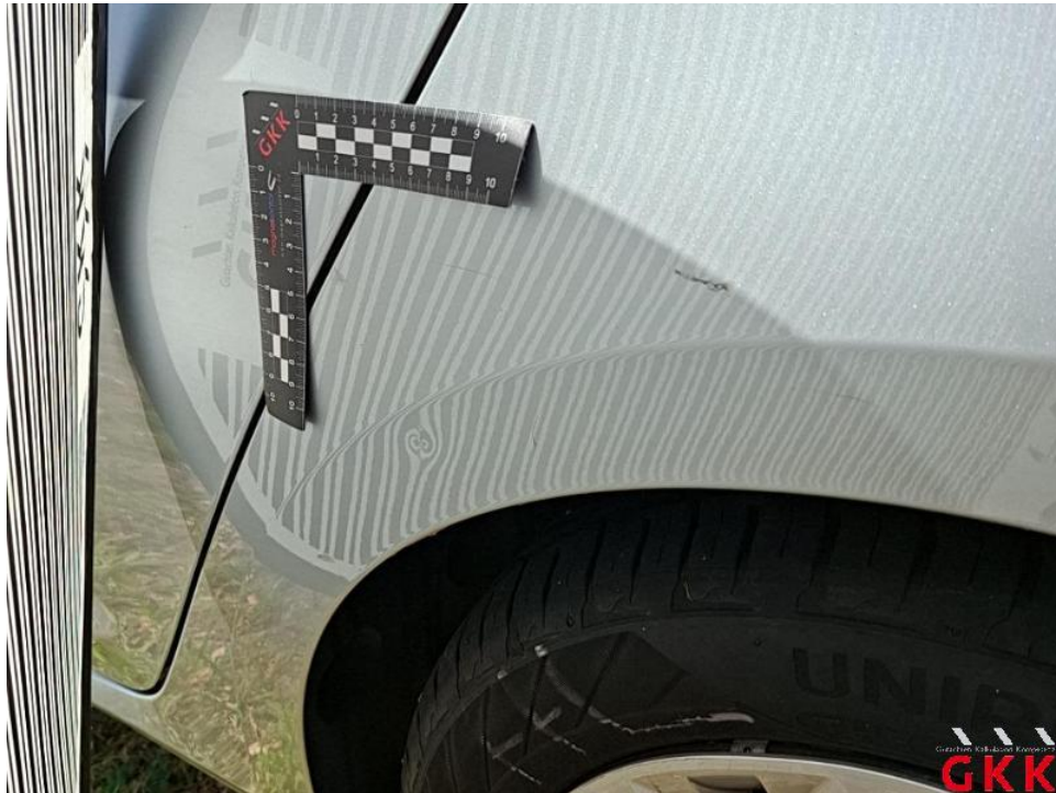
Bild 78. Seitenwand links, beschädigt, instand setzen - lackieren
