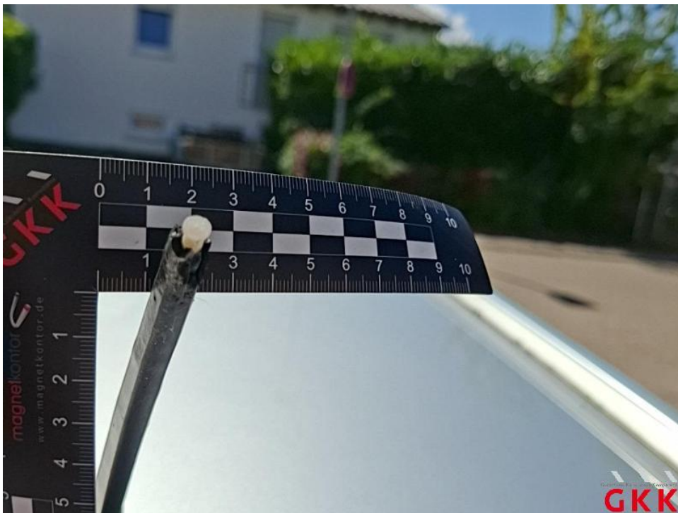
Bild 72. Antenne, Stab, beschädigt, ersetzen
