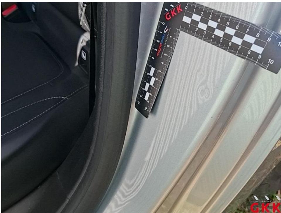
Bild 80. Tür hinten links, Einstieg, beschädigt, Smartrepair
