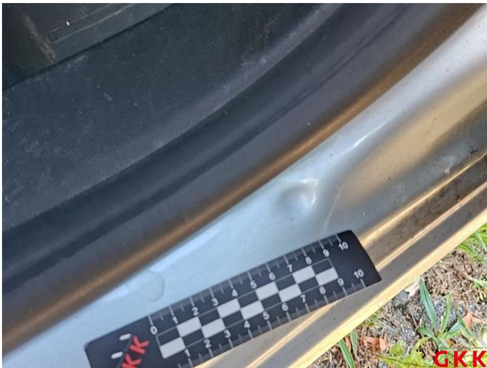
Bild 62. Tür hinten rechts, Einstieg, beschädigt, instand setzen - lackieren
