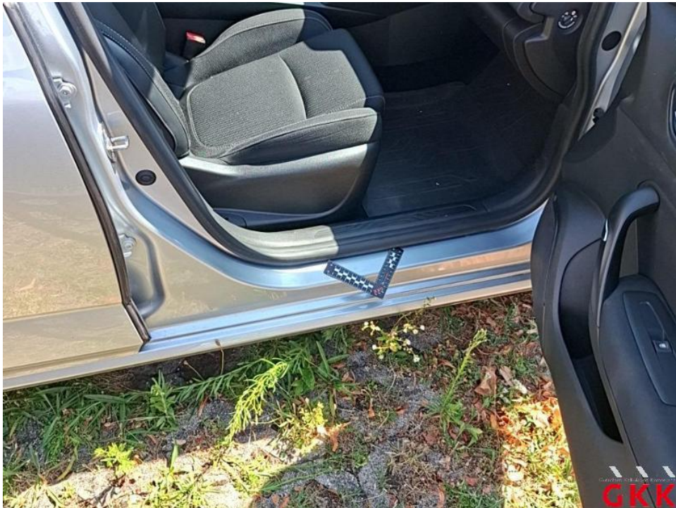
Bild 54. Tür vorne rechts, Einstieg, beschädigt, instand setzen - lackieren
