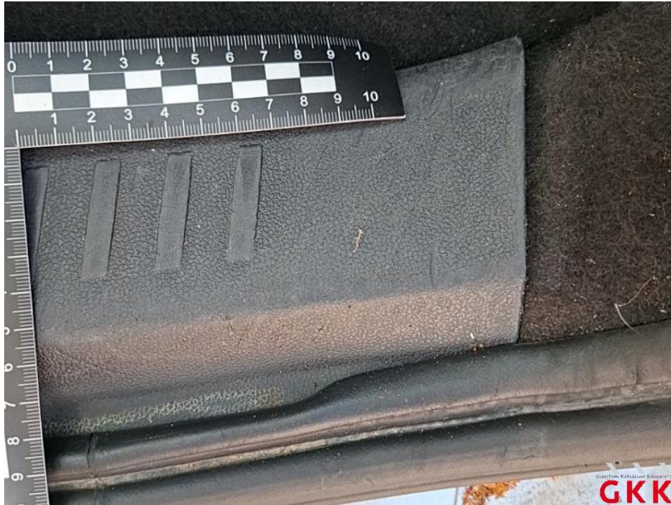
Bild 23. Ladekante, Abdeckung, beschädigt, ersetzen
