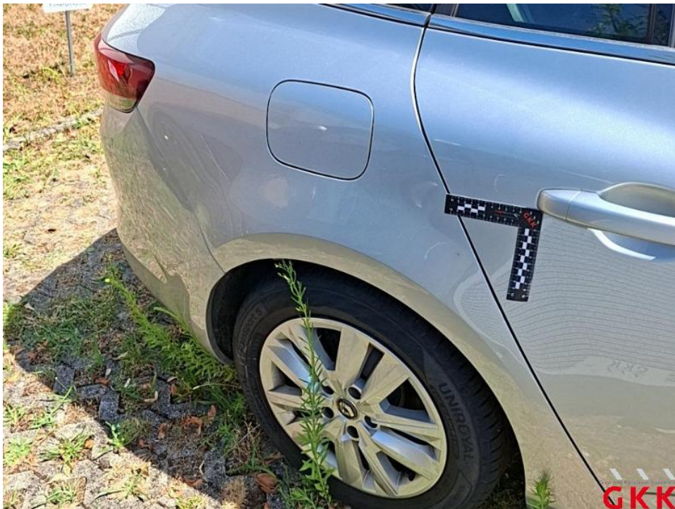
Bild 65. Seitenwand rechts, beschädigt, instand setzen - lackieren
