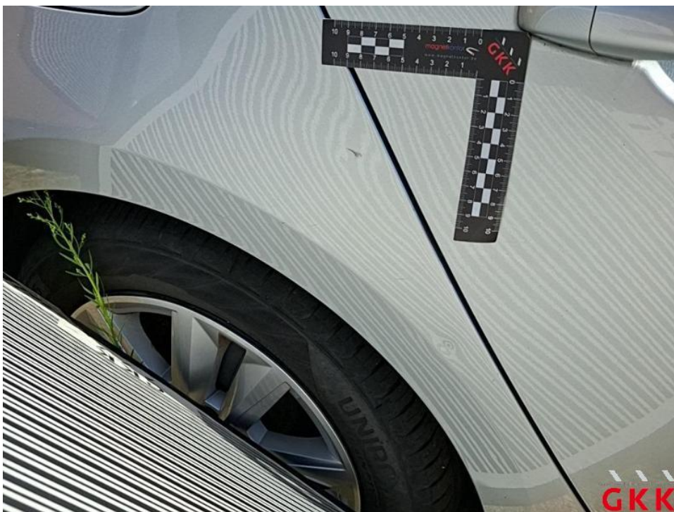
Bild 66. Seitenwand rechts, beschädigt, instand setzen - lackieren
