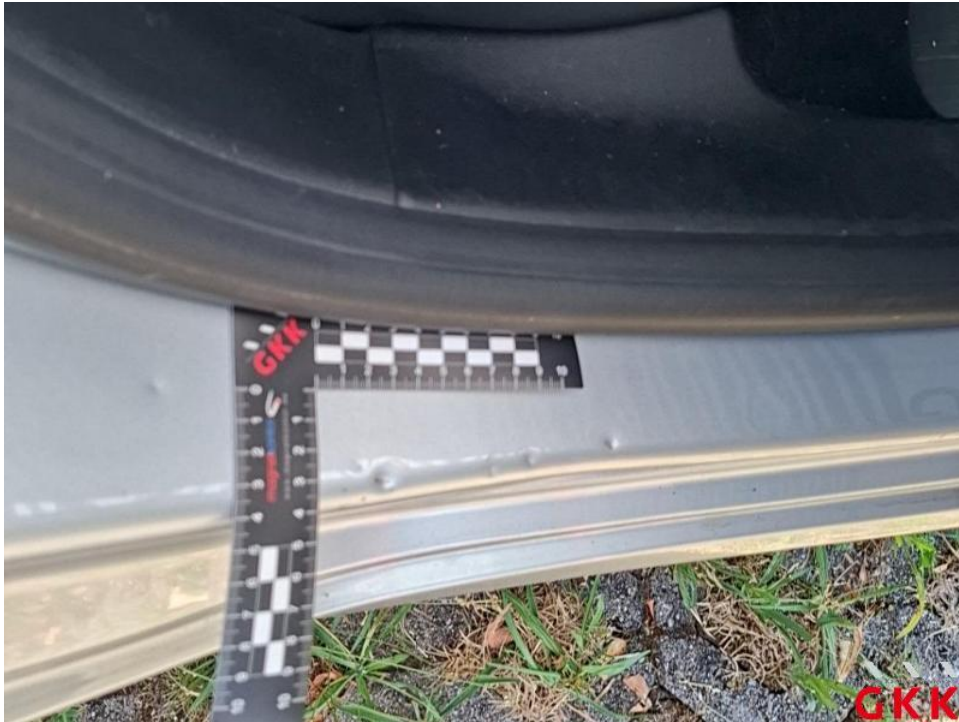
Bild 61. Tür hinten rechts, Einstieg, beschädigt, instand setzen - lackieren
