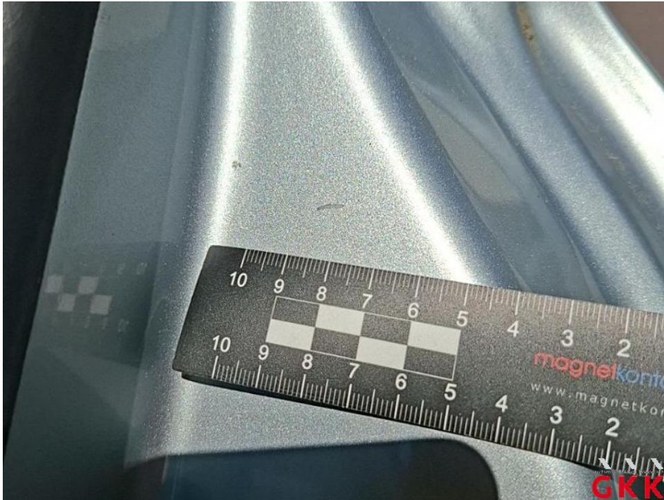
Bild 81. Tür hinten links, Einstieg, beschädigt, Smartrepair
