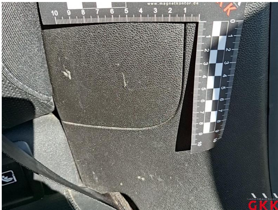
Bild 83. C- Säule links, Innenverkleidung -unterhalb-, verkratzt, ersetzen
