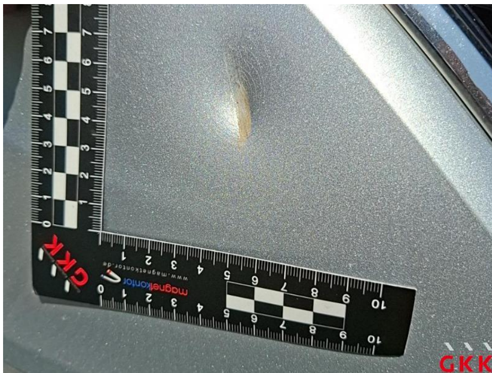
Bild 50. Stoßfänger vorne, Verkleidung -lackiert-, beschädigt, ersetzen
