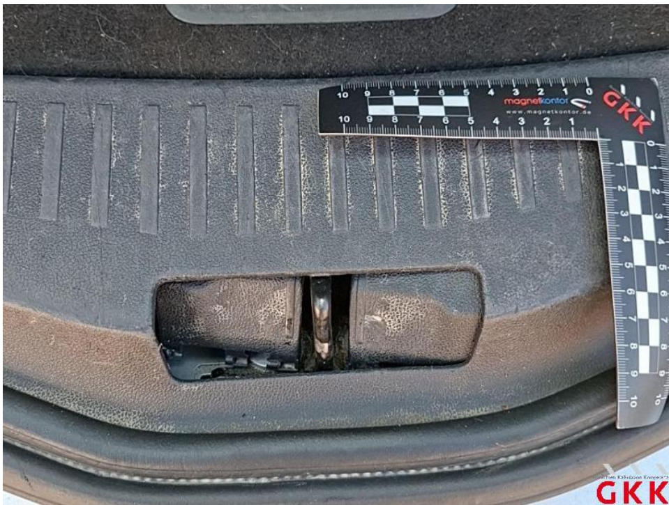
Bild 22. Ladekante, Abdeckung, beschädigt, ersetzen
