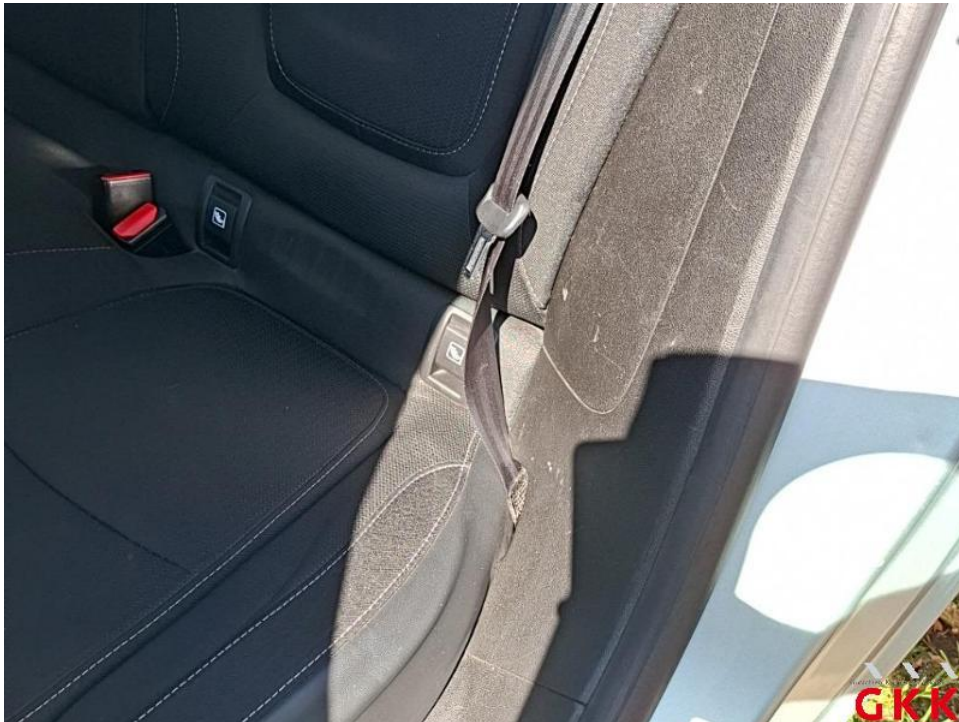
Bild 82. C- Säule links, Innenverkleidung -unterhalb-, verkratzt, ersetzen
