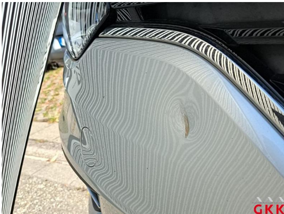
Bild 49. Stoßfänger vorne, Verkleidung -lackiert-, beschädigt, ersetzen
