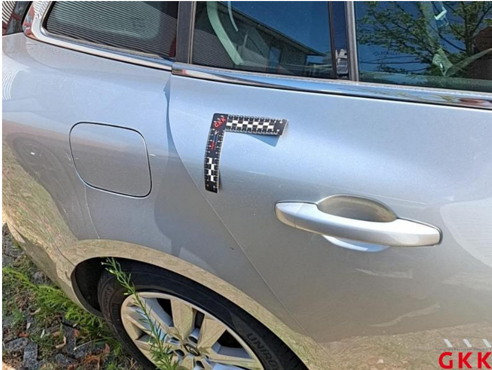
Bild 57. Tür hinten rechts, verkratzt, lackieren
