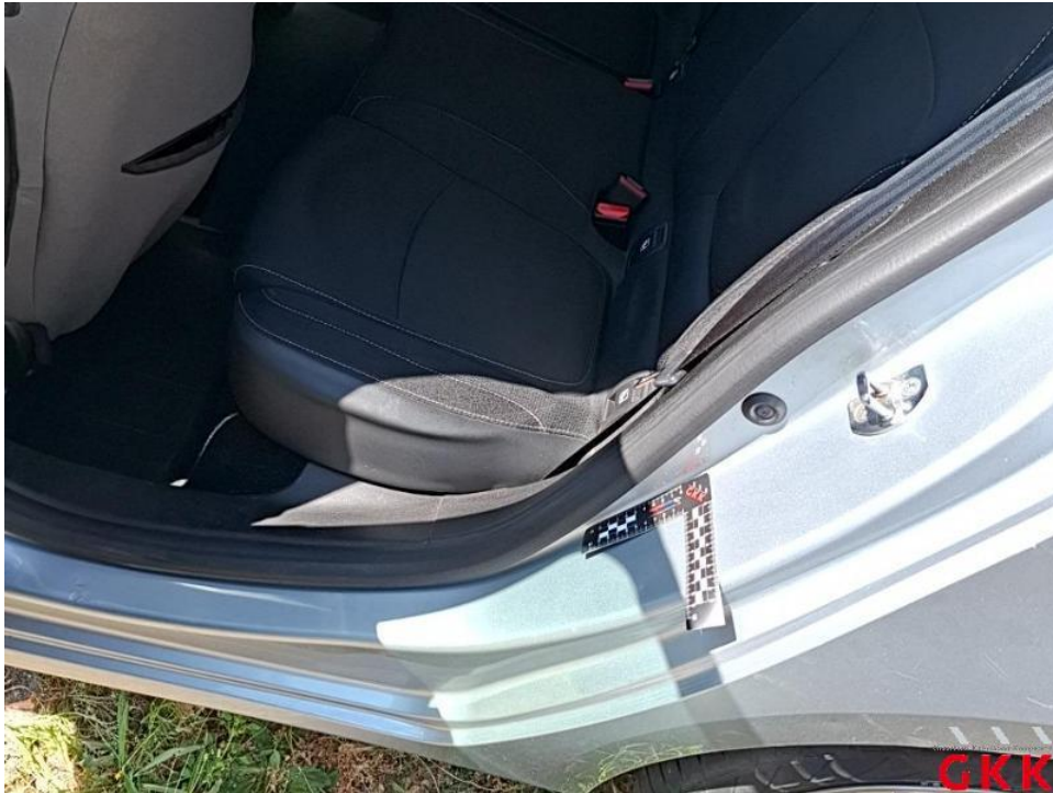
Bild 79. Tür hinten links, Einstieg, beschädigt, Smartrepair
