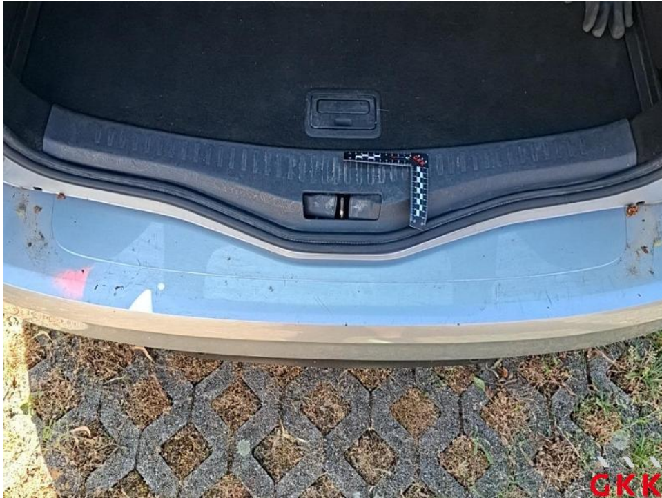
Bild 21. Ladekante, Abdeckung, beschädigt, ersetzen
