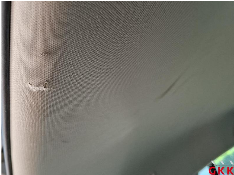
Bild 26. Himmel, beschädigt, ersetzen
