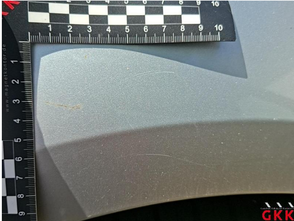
Bild 77. Seitenwand links, beschädigt, instand setzen - lackieren
