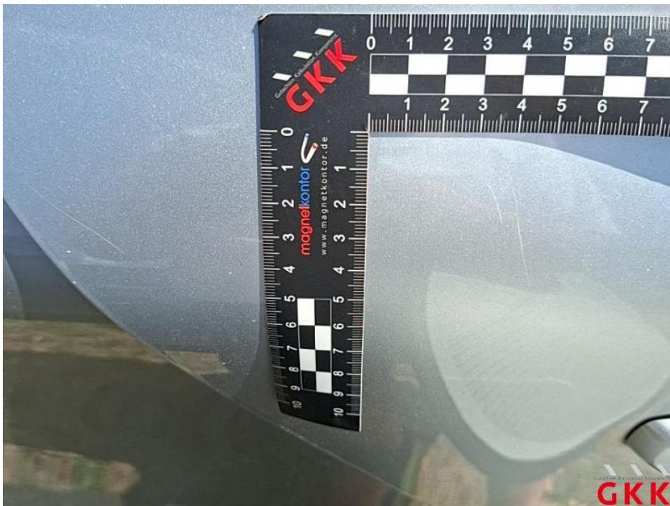
Bild 58. Tür hinten rechts, verkratzt, lackieren
