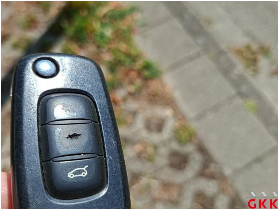
Bild 14. Hauptschlüssel, mit Fernbedienung, beschädigt, ersetzen
