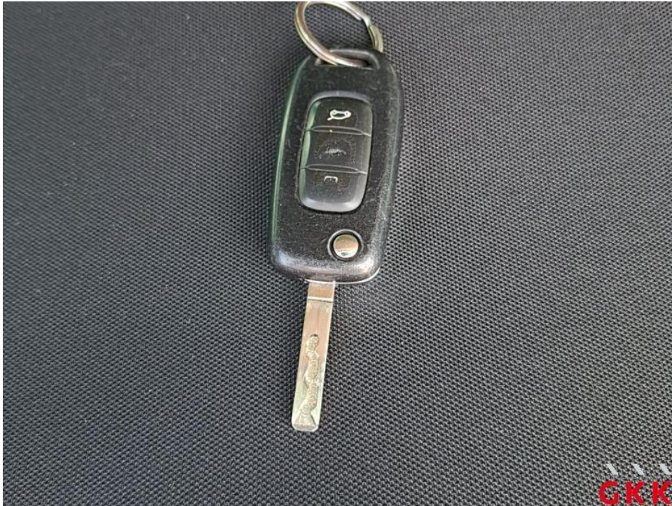
Bild 13. Hauptschlüssel, mit Fernbedienung, beschädigt, ersetzen
