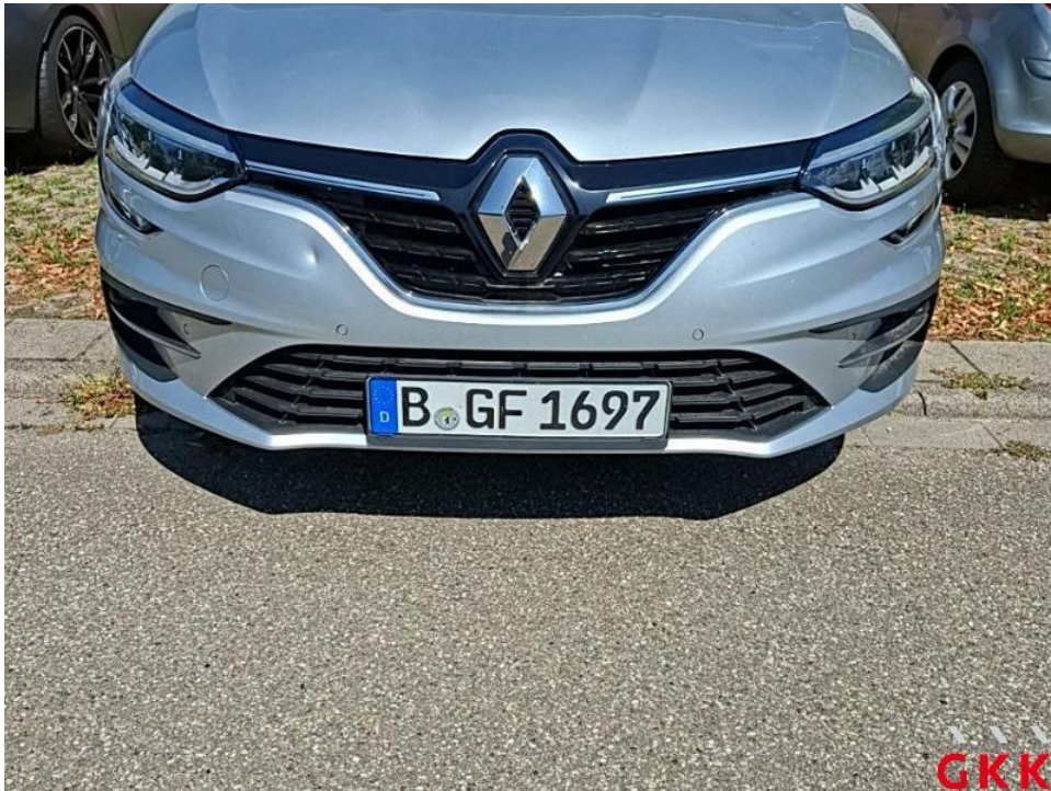
Bild 48. Stoßfänger vorne, Verkleidung -lackiert-, beschädigt, ersetzen
