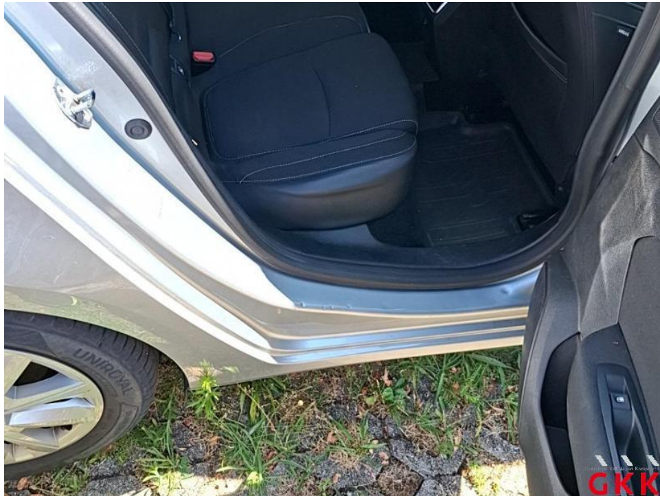
Bild 60. Tür hinten rechts, Einstieg, beschädigt, instand setzen - lackieren
