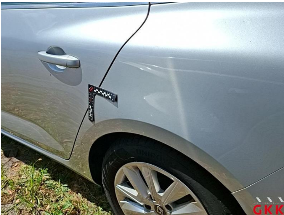
Bild 76. Seitenwand links, beschädigt, instand setzen - lackieren
