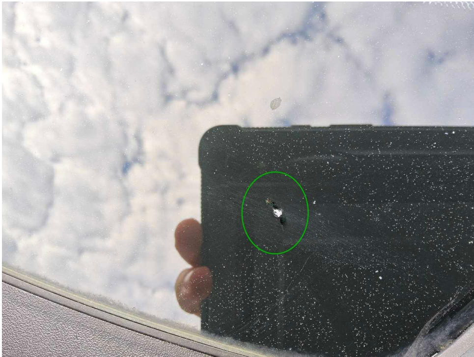
Bild 13 : Frontscheibe Steinschlag mit Rissbildung
