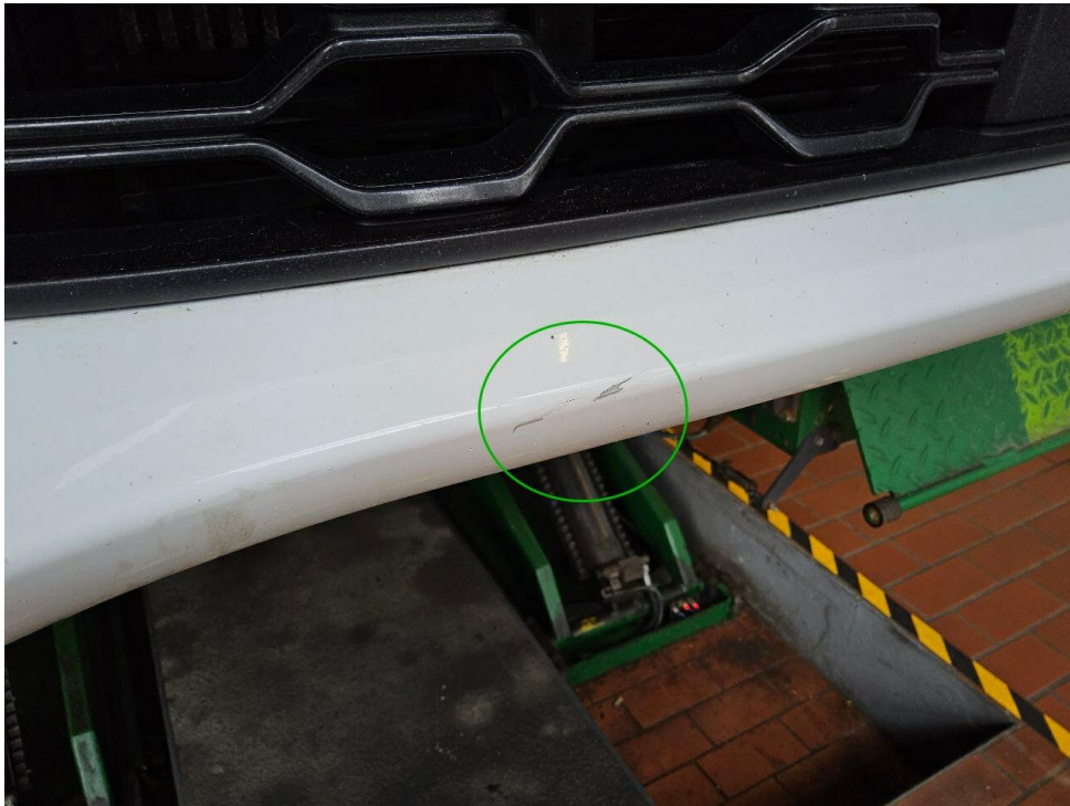
Bild 17 : Stoßfänger vorne verschrammt
