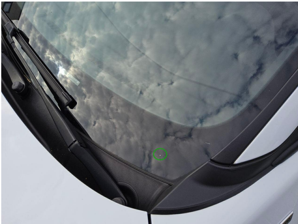
Bild 14 : Frontscheibe Steinschlag mit Rissbildung
