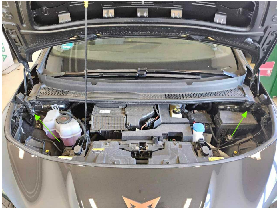
Bild 19 : Marderspuren im Mottorraum
