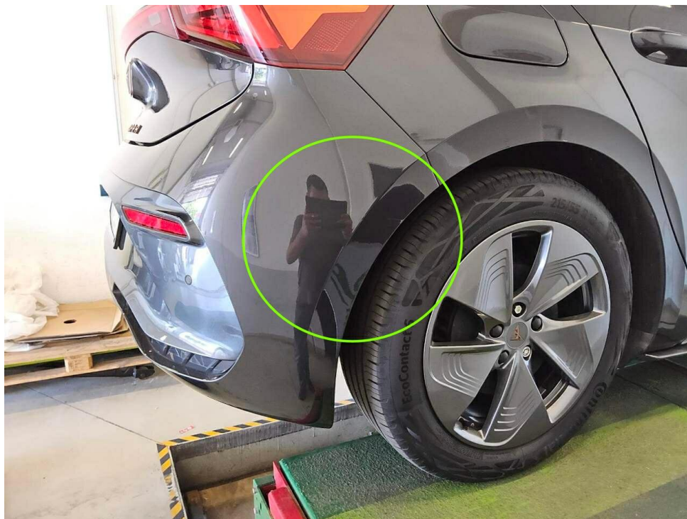
Bild 16 : Stoßfänger hinten Lackierung, verschrammt, smart repair
