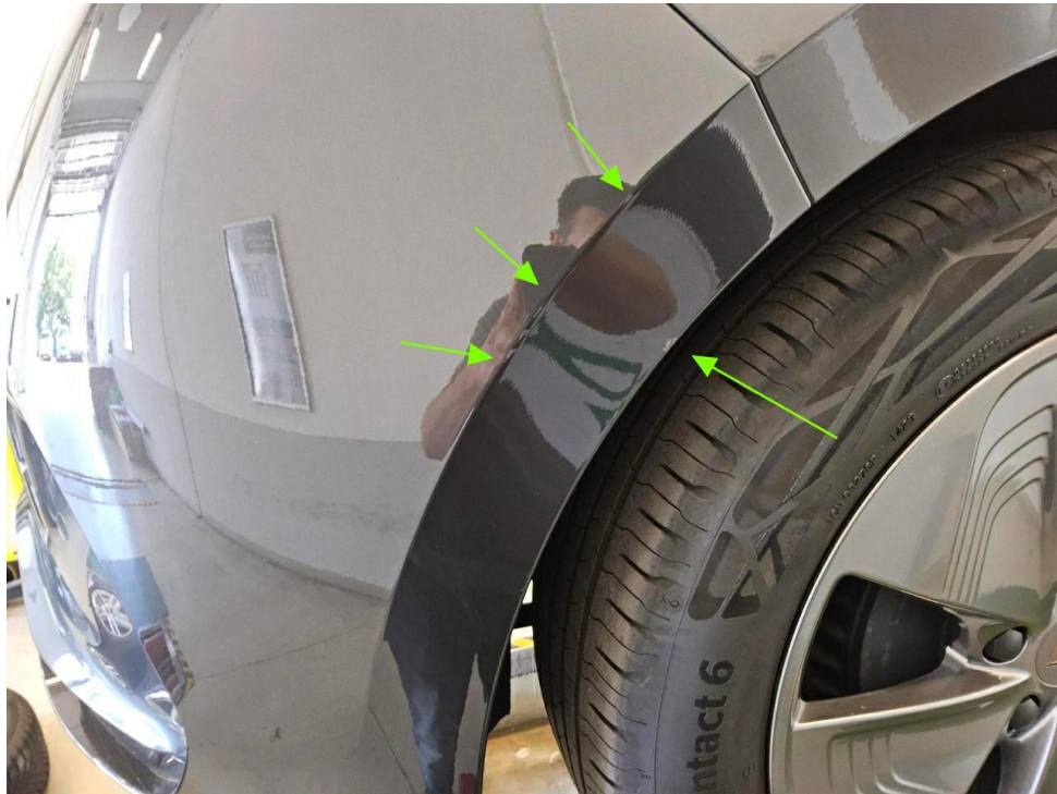
Bild 17 : Stoßfänger hinten Lackierung, verschrammt, smart repair
