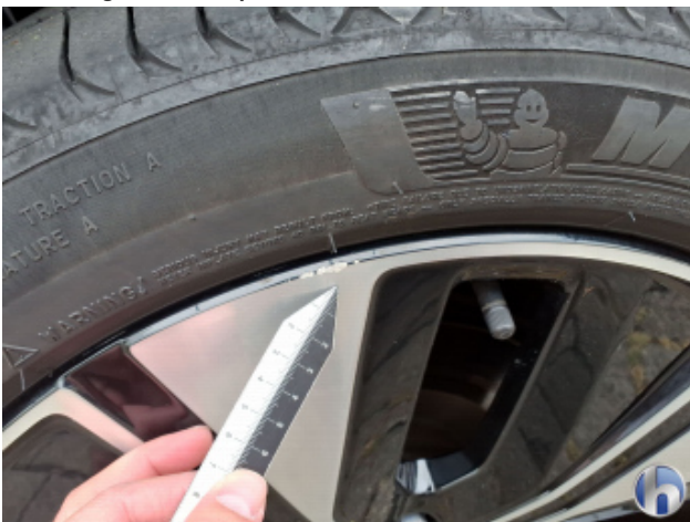
4. Felge Hinten - Rechts Kratzer - Smart Repair
