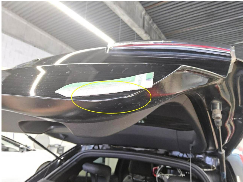
Bild 16 : Heckdeckel Lackierung, zerkratzt, smart repair
