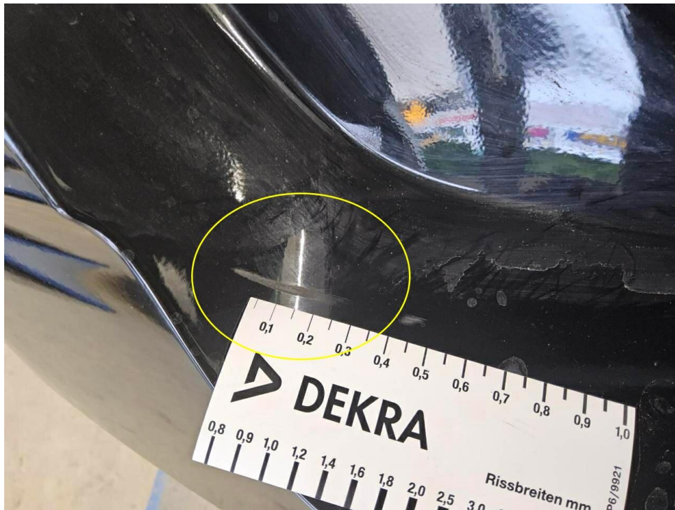
Bild 17 : Stoßfänger hinten Lackierung, zerkratzt, smart repair
