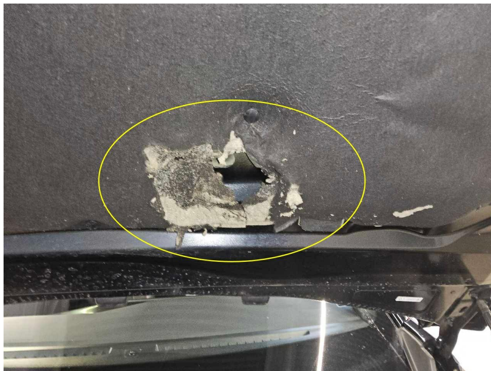
Bild 24 : Motorhaube, Dämmmatte zerrissen
