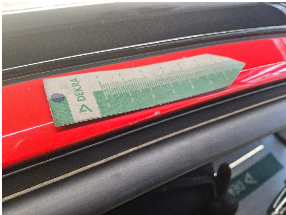
Bild 26 : Dachrinnen Zierleiste links zerkratzt
