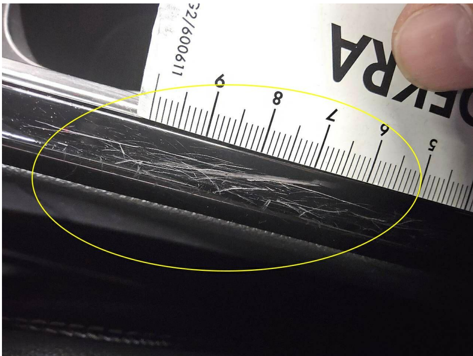
Bild 22 : Mittelkonsole, Blende zerkratzt
