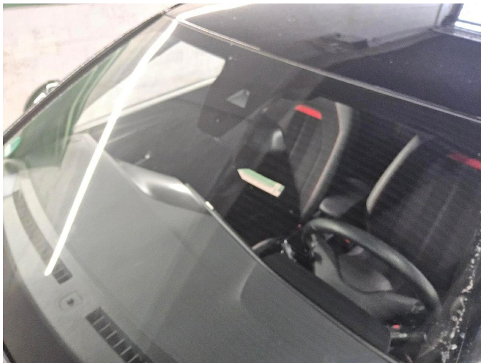
Bild 19 : Frontscheibe, Steinschlag, Gebrauchsspur
