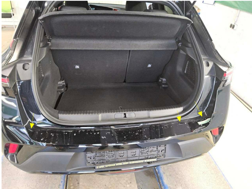
Bild 15 : Stoßfänger hinten Lackierung, zerkratzt, smart repair
