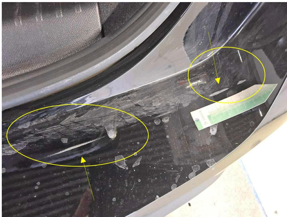
Bild 18 : Stoßfänger hinten Lackierung, zerkratzt, smart repair
