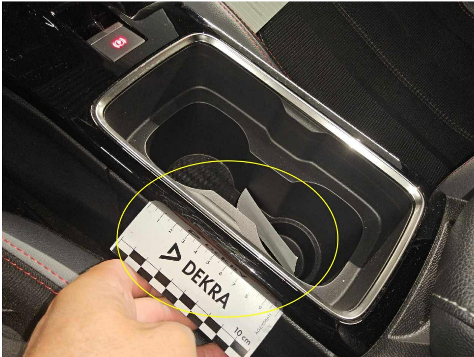
Bild 21 : Mittelkonsole, Blende zerkratzt
