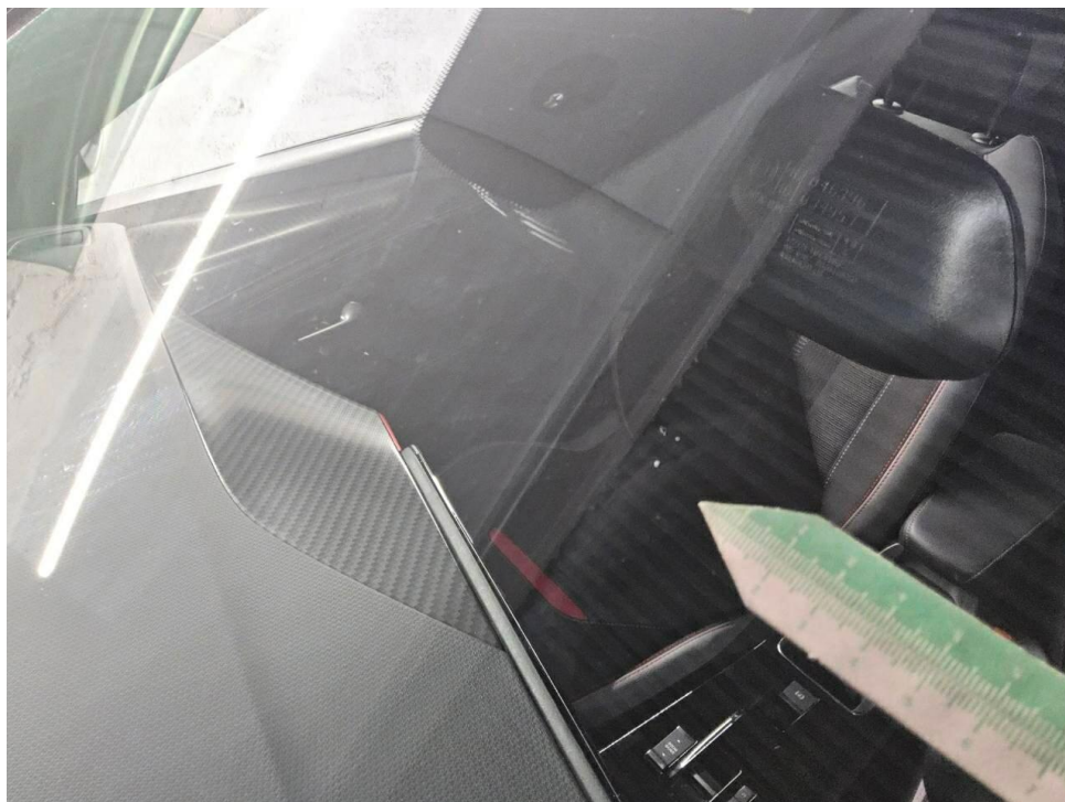
Bild 20 : Frontscheibe, Steinschlag, Gebrauchsspur
