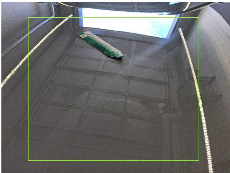
Bild 18 : Motorhaube, Oberflächenkratzer, polieren
