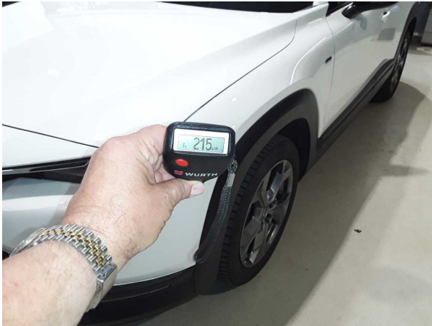
Nachlackierung 1: Kotflügel links, Tür vorne links
