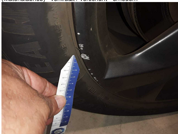
Beschädigung #3: Rad/Reifen: Leichtmetallfelge vorn rechts (Materialabrieb) - verkratzt / verschürft - erneuern
