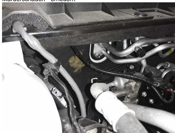
Beschädigung #2: Karosserie: Stirnwandverkleidung - Marderschaden - erneuern
