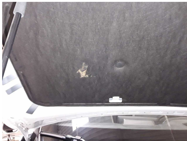
Beschädigung #1: Motorhaube: Dämmmatte - Marderschaden - erneuern
