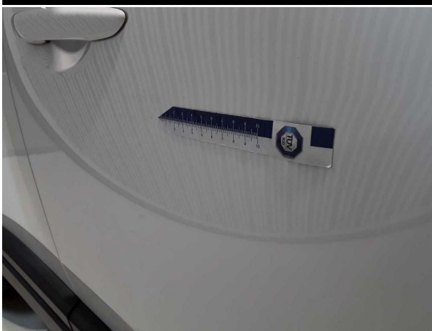
Beschädigung #4: Tür vorn rechts: Tür - Delle / Lackschaden - instandsetzen und lackieren
