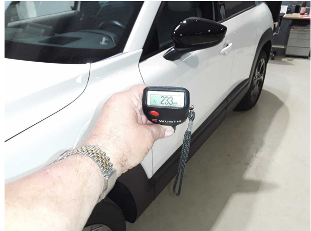
Nachlackierung 1: Kotflügel links, Tür vorne links
