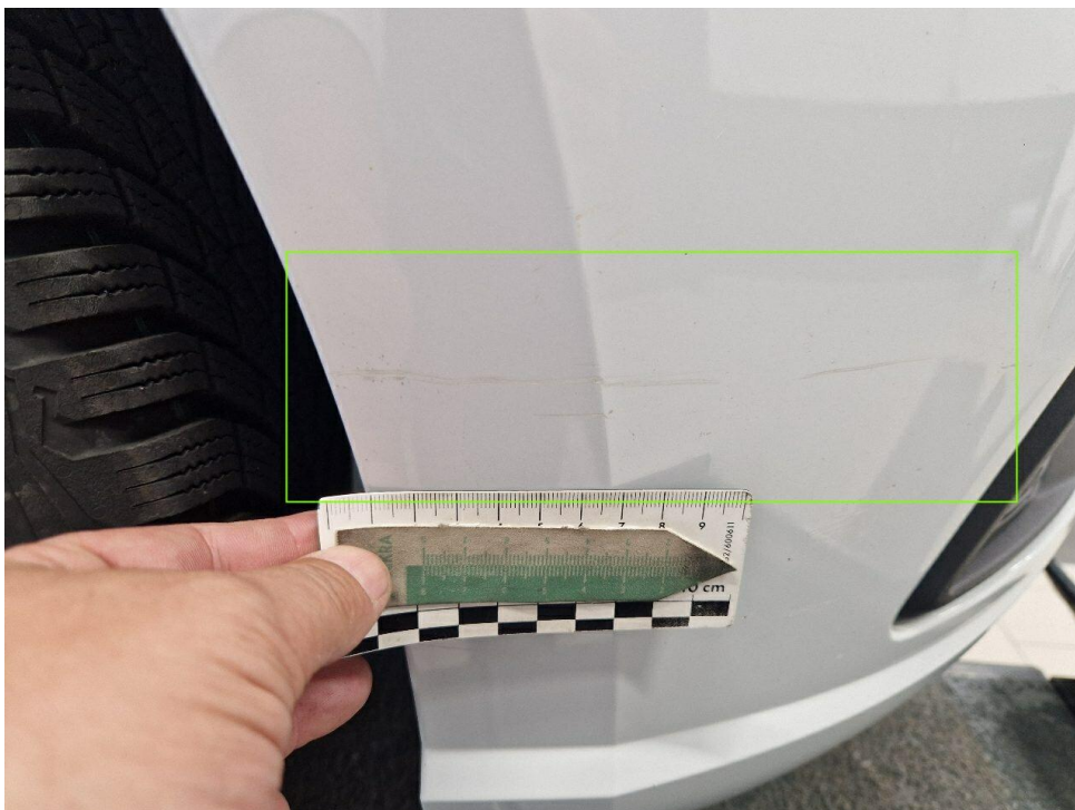
Bild 18 : Stoßfänger vorn zerkratzt
