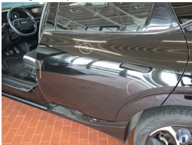
5. Tür Hinten - Links Beschädigt - Instandsetzen und Lackieren
