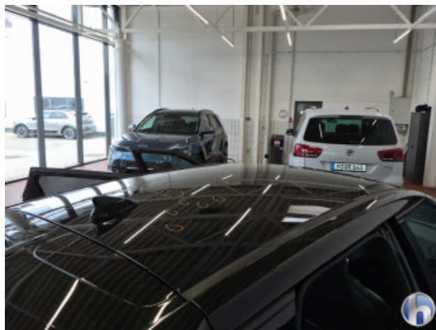
3. Dach Hagelschaden - Siehe Kalkulation
