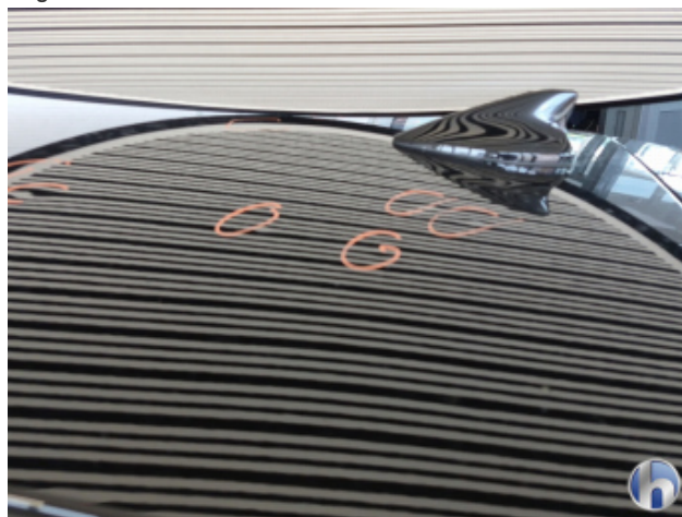
3. Dach Hagelschaden - Siehe Kalkulation
