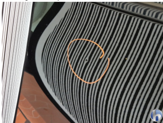
5. Tür Hinten - Links Beschädigt - Instandsetzen und Lackieren
