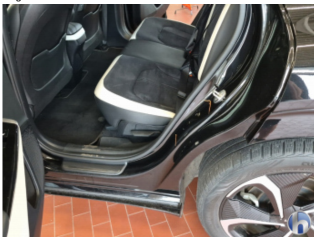
4. Türeinstieg Hinten - Links Beschädigt - Smart Repair
