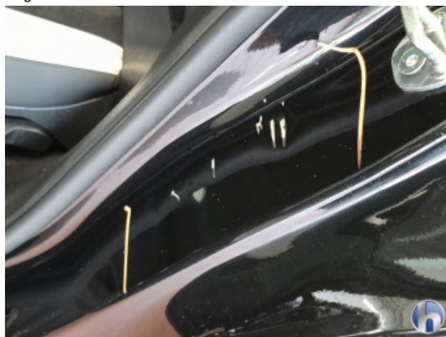
4. Türeinstieg Hinten - Links Beschädigt - Smart Repair
