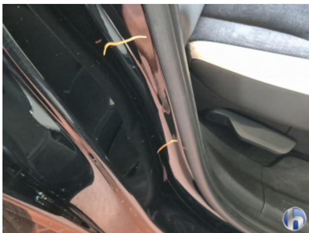
1. Türeinstieg Hinten - Rechts 2 Dellen - Sanft Instandsetzen
