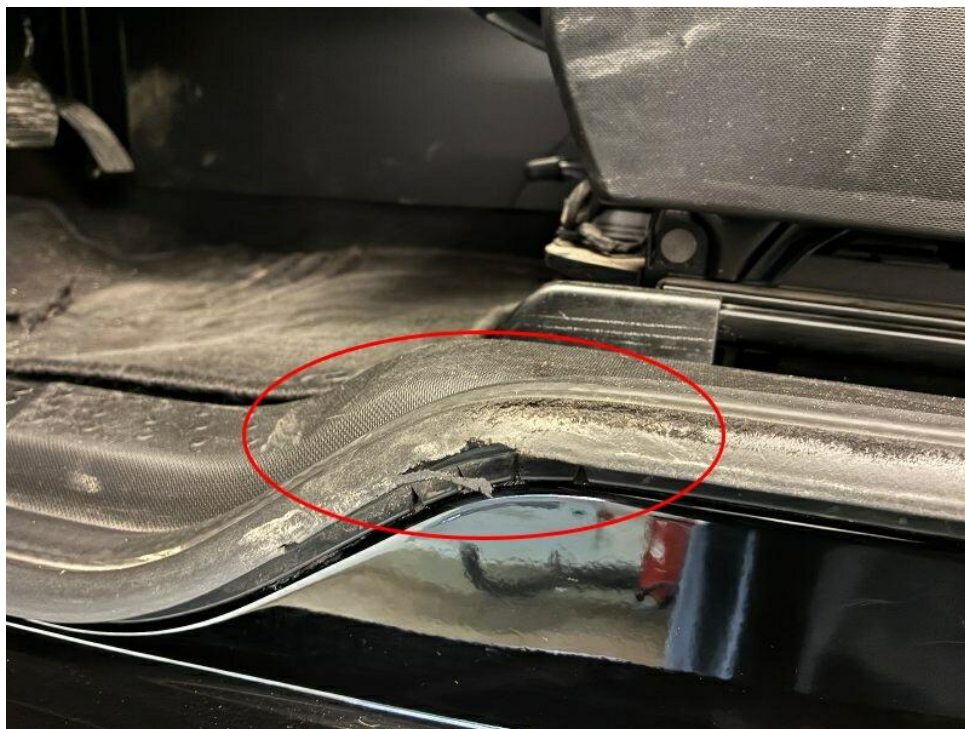
Bild 25 : Kantenschutz links eingerissen
