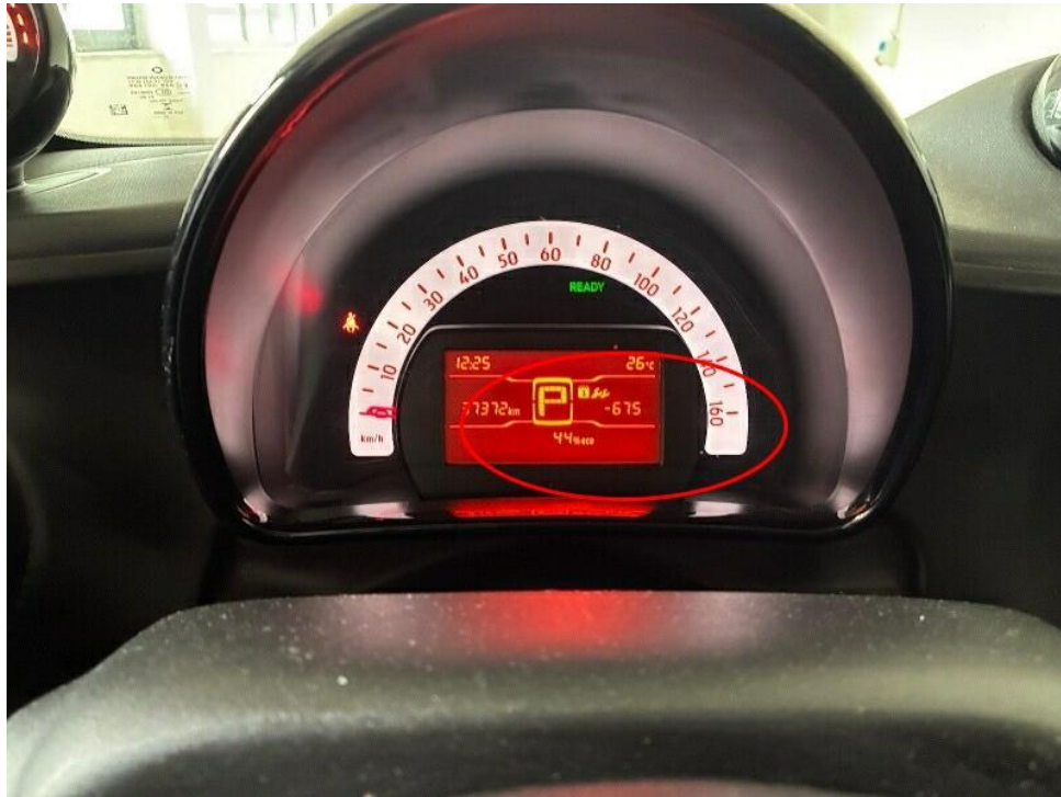
Bild 7 : Serviceintervallanzeige "T" Service fällig
