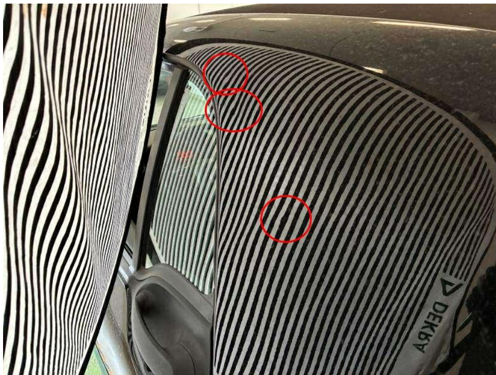
Bild 14 : Seitenwand hinten links Dellen
