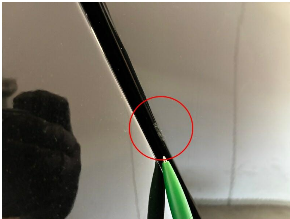
Bild 19 : Türe rechts Kratzer
