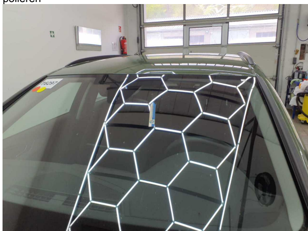
Beschädigung #3: Verglasung: Frontscheibe - Steinschlag - Wertminderung
