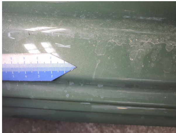
Beschädigung #1: Schweller links: Einstieg - Kratzer - auslegen / polieren
