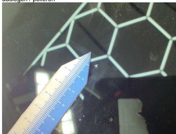
Beschädigung #3: Verglasung: Frontscheibe - Steinschlag - Wertminderung
