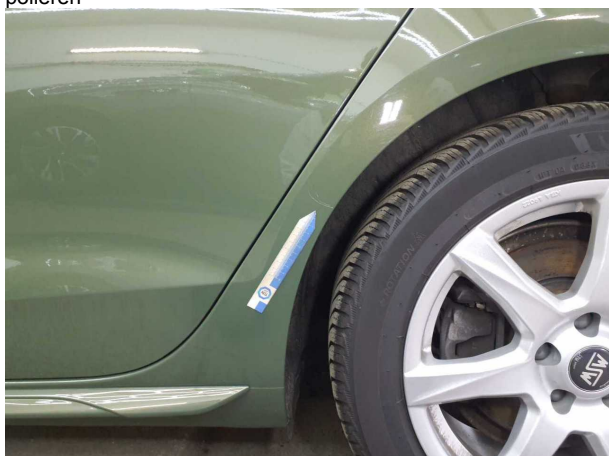
Beschädigung #2: Seitenwand links: Kniestück - Kratzer - auslegen / polieren
