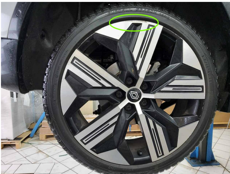
Bild 12 : Glanzgedrehte Alufelge hinten rechts, verschrammt
