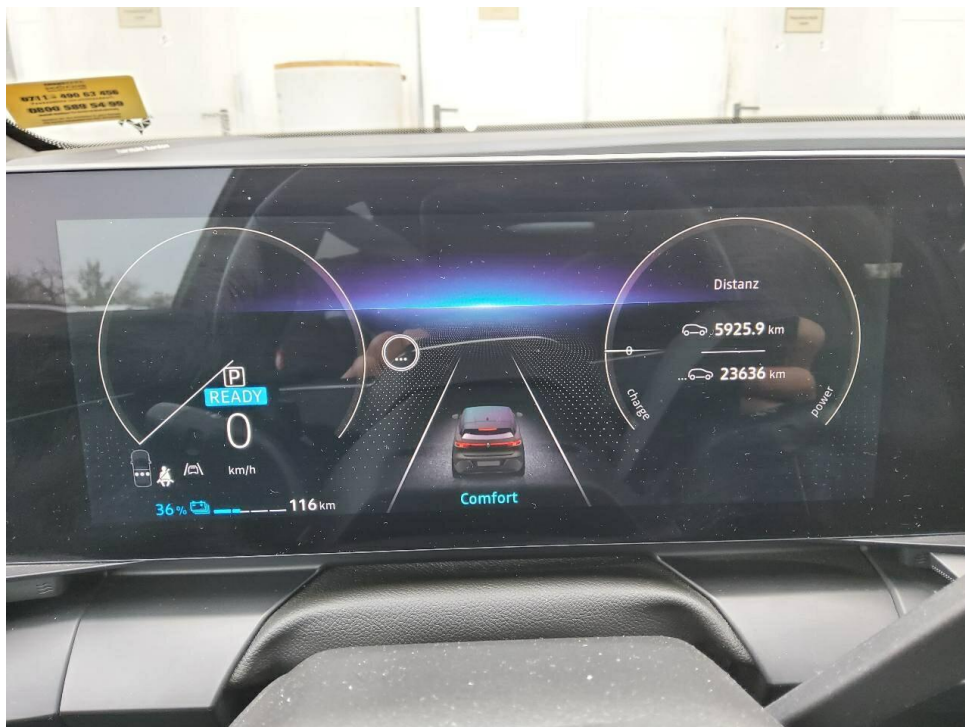
Bild 6 : Kombiinstrument (betriebsbereit) mit Kilometerstand
