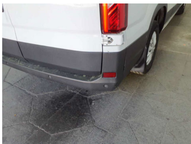
Beschädigung #2: Stossfänger hinten: Stossfänger hinten - gebrochen / gerissen - erneuern
