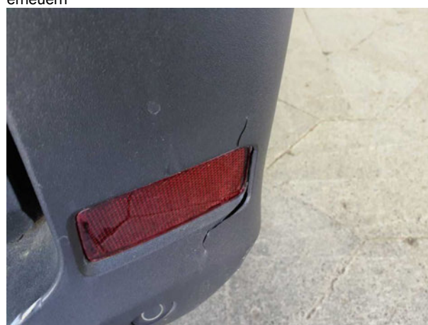
Beschädigung #2: Stossfänger hinten: Stossfänger hinten - gebrochen / gerissen - erneuern
