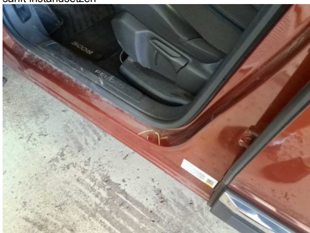
Beschädigung #5: Schweller links: Einstieg - Delle / Lackschade... Smart Repair
