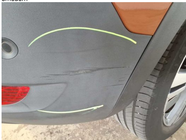
Beschädigung #13: Stossfänger hinten: Spoiler - verkratzt / verschürft - erneuern
