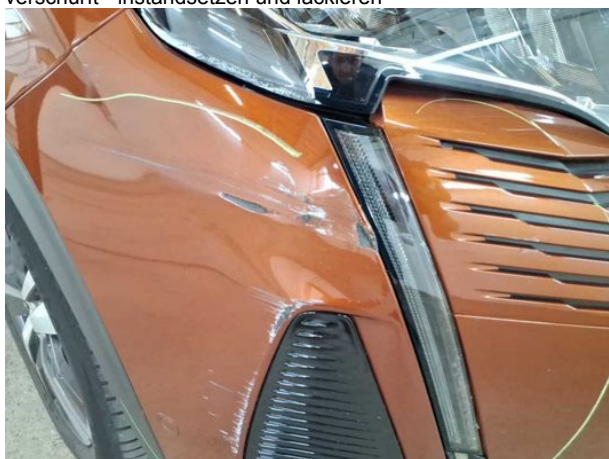
Beschädigung #16: Stossfänger vorn: Stossfänger vorn - verkratzt / verschürft - erneuern
