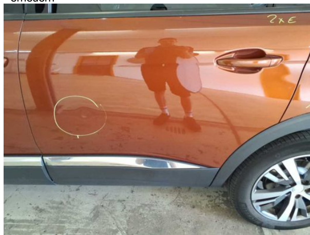
Beschädigung #14: Tür hinten links: Tür - Delle / Lackschaden - instandsetzen und lackieren
