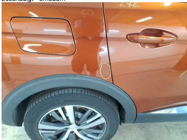
Beschädigung #3: Seitenwand rechts: Seitenwand - Delle(n) - sanft instandsetzen
