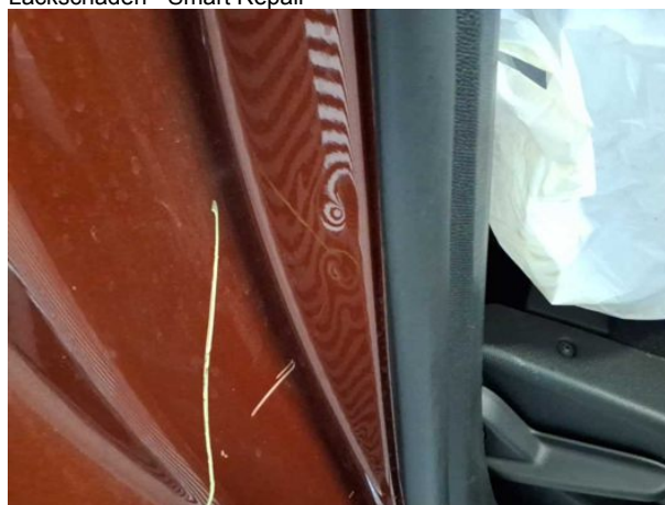
Beschädigung #11: Seitenwand rechts: Einstieg - Delle / Lackschaden - Smart Repair
