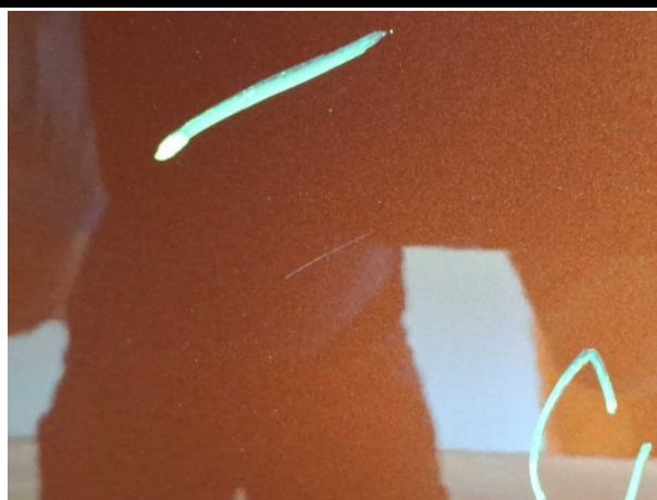
Beschädigung #15: Seitenwand links: Seitenwand - verkratzt / verschürft - instandsetzen und lackieren
