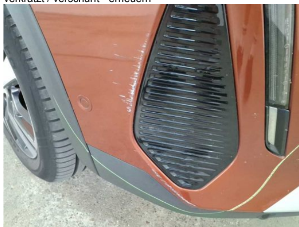
Beschädigung #16: Stossfänger vorn: Stossfänger vorn - verkratzt / verschürft - erneuern
