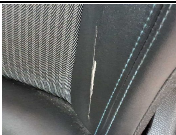
Beschädigung #12: Sitz vorn: Lehnensbezug links - beschädigt - erneuern
