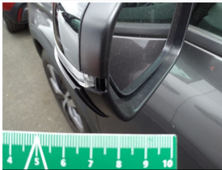
Feu clignotant / Gauche / Cassé
