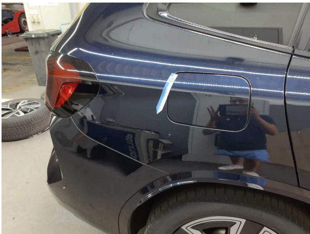
Beschädigung #3: Seitenwand rechts: Seitenwand - Kratzer - lackieren
