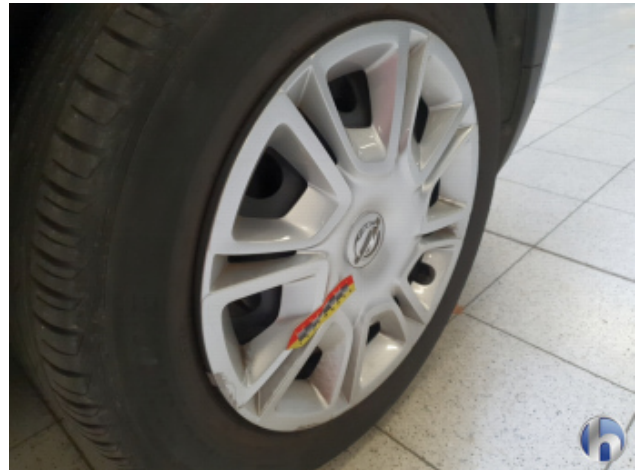
1. Radkappe - Vorne - Rechts Kratzer - Erneuern
