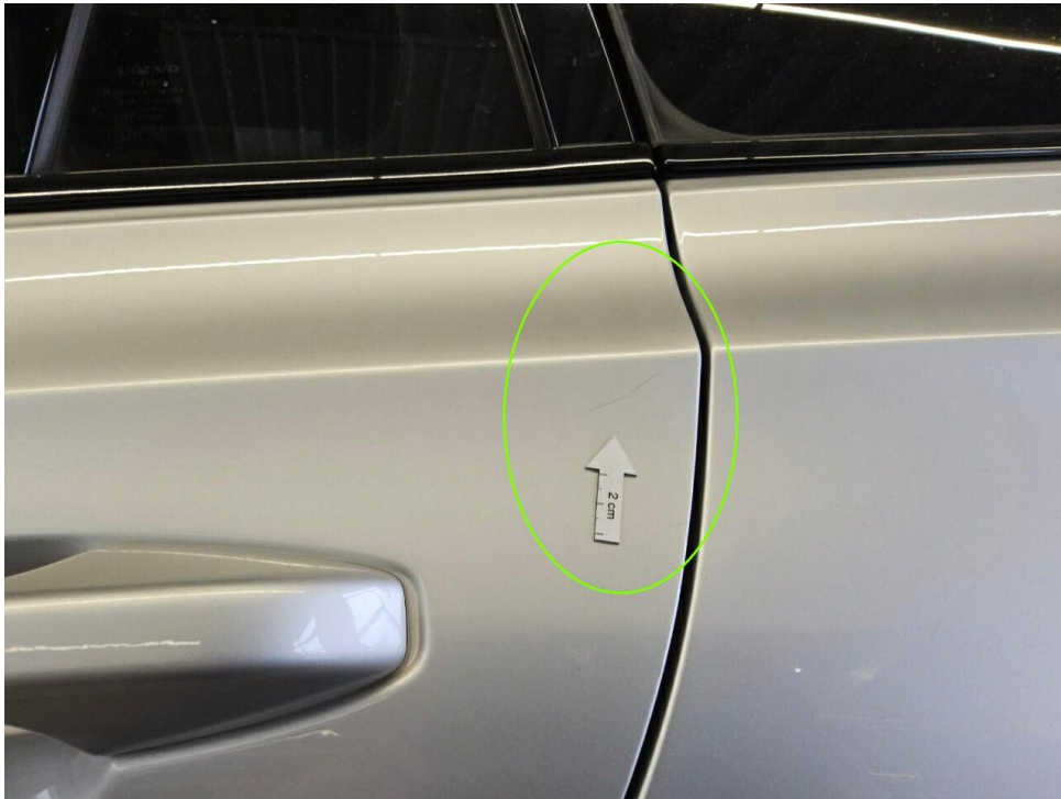
Bild 13 : Tür hinten links Lackierung, verschrammt, polieren
