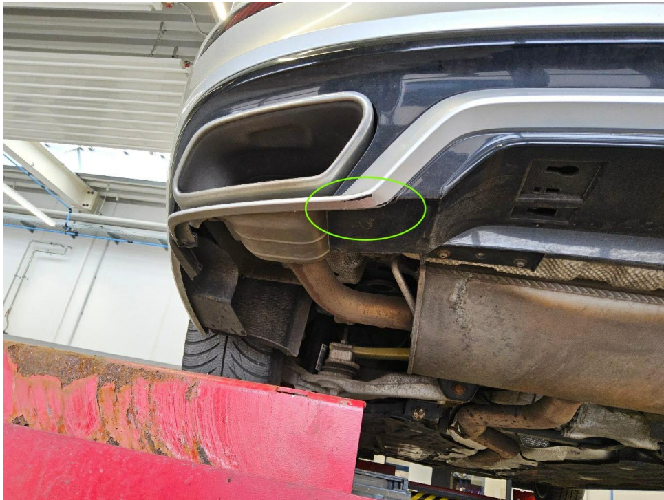
Bild 47 : Heckschürze hinten unten Lackierung, zerkratzt, lackieren mit Lackaufbau
