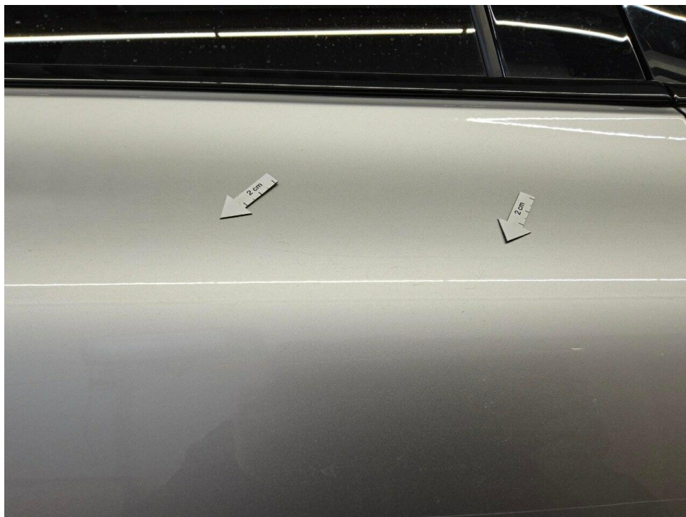
Bild 20 : Tür hinten rechts Lackierung, verschrammt, polieren
