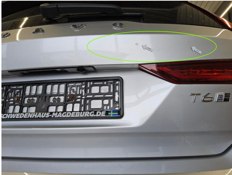
Bild 23 : Heckklappe Lackierung, zerkratzt, lackieren mit Lackaufbau
