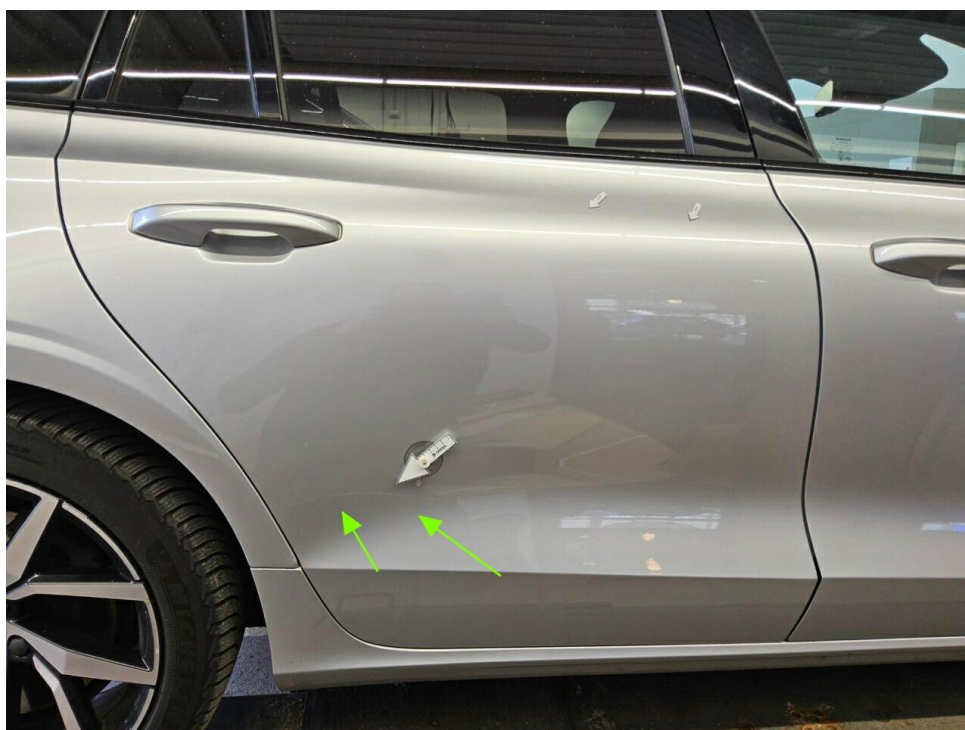
Bild 22 : Tür hinten rechts Lackierung, verschrammt, polieren
