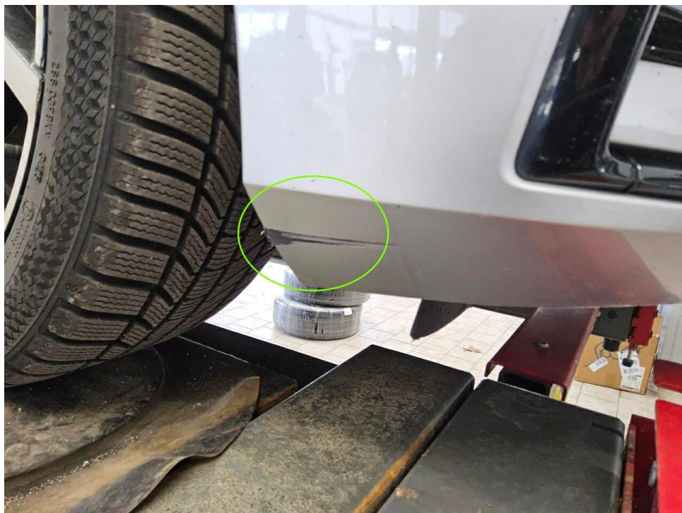
Bild 36 : Stoßfänger vorne Lackierung, zerkratzt, lackieren mit Lackaufbau
