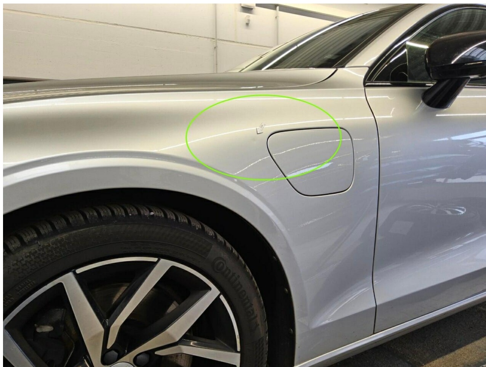
Bild 33 : Kotflügel vorne links, eingedellt, drücken
