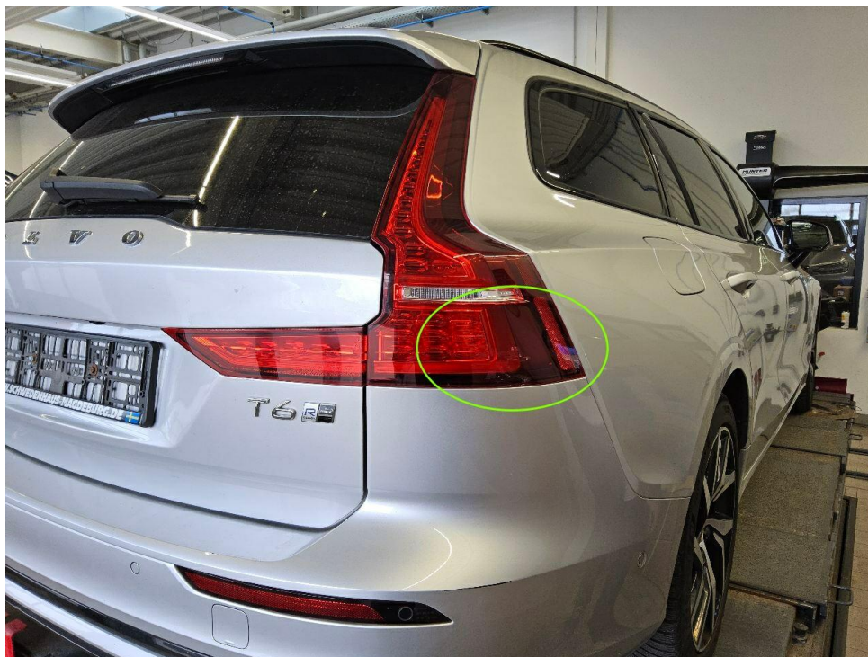
Bild 28 : Rücklicht hinten rechts, zerkratzt
