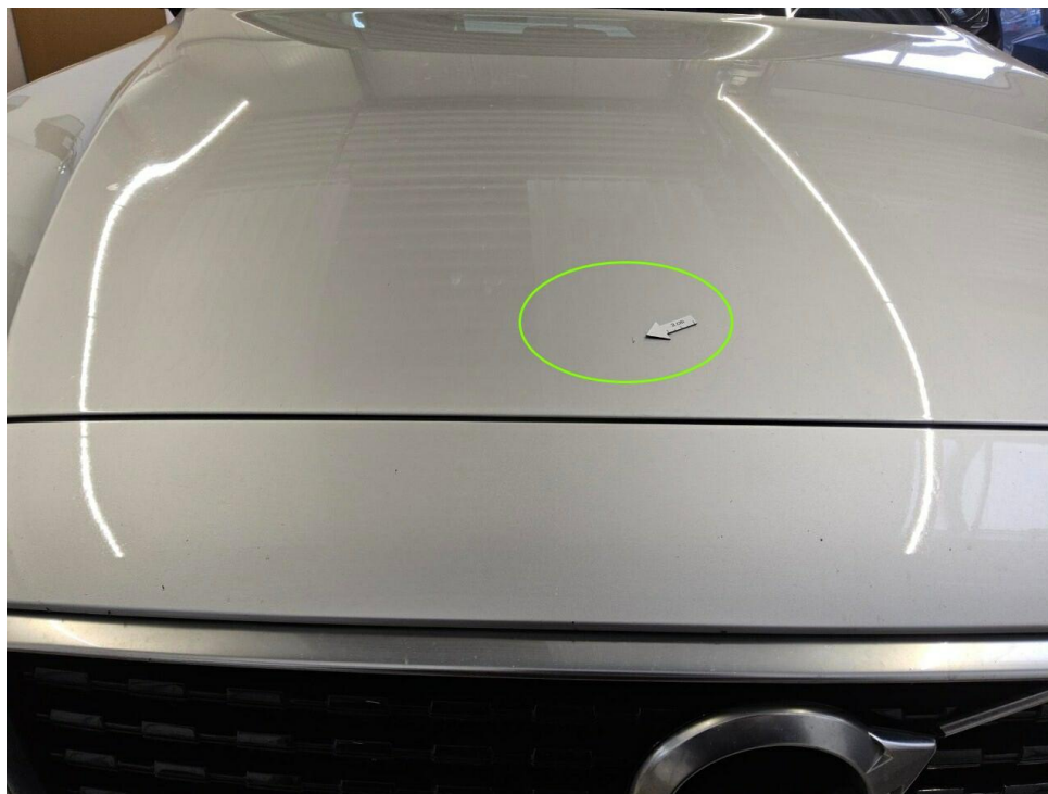
Bild 16 : Motorhaube Lackierung, zerkratzt, smart repair
