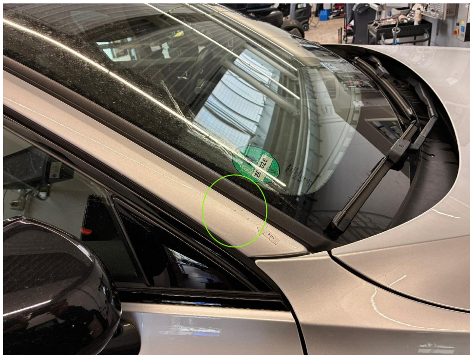
Bild 49 : Dachrahmen rechts Lackierung, zerkratzt, lackieren mit Lackaufbau
