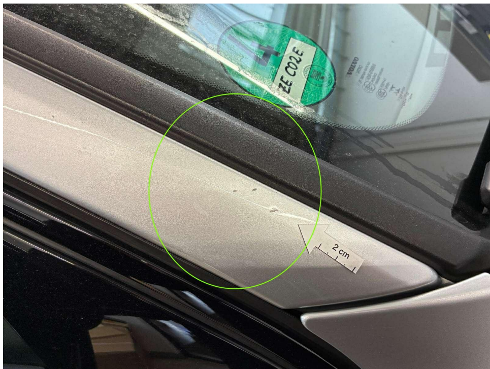
Bild 50 : Dachrahmen rechts Lackierung, zerkratzt, lackieren mit Lackaufbau
