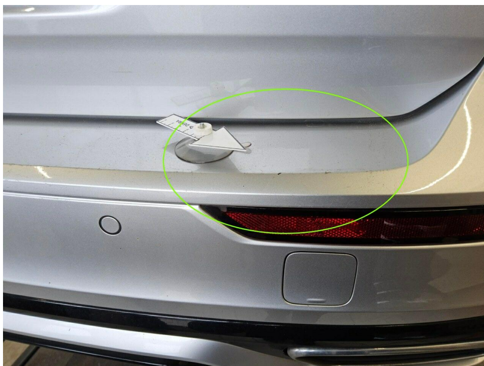
Bild 30 : Stoßfänger hinten Lackierung, zerkratzt, lackieren mit Lackaufbau
