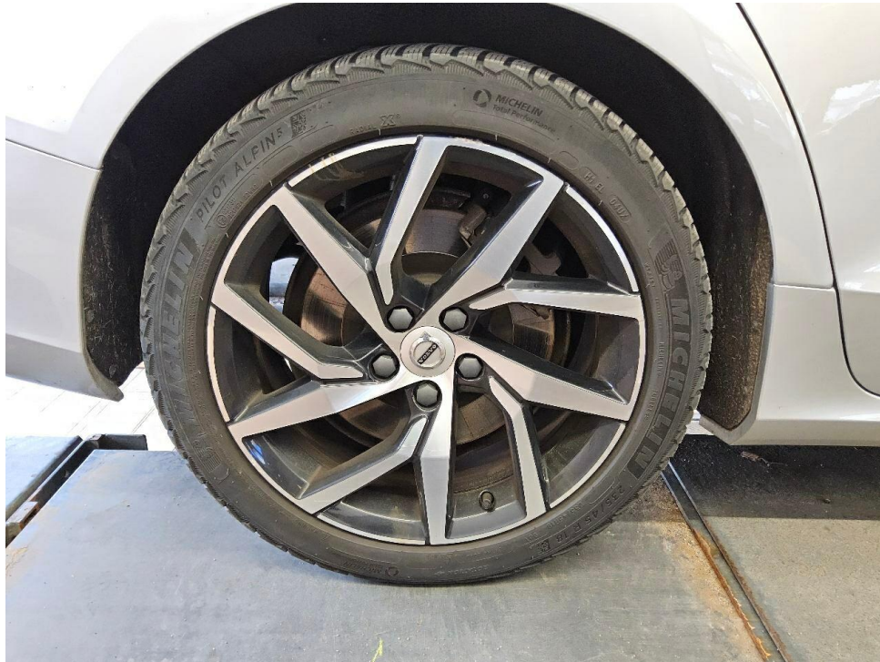
Bild 41 : Glanzgedrehte Aluminiumfelge hinten rechts, zerkratzt
