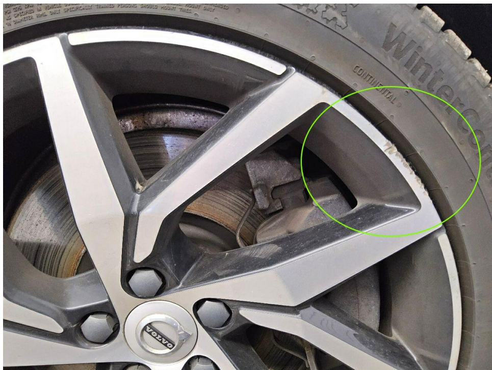
Bild 40 : Glanzgedrehte Aluminiumfelge vorn rechts, zerkratzt
