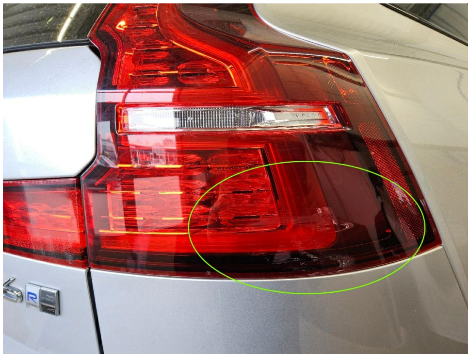
Bild 27 : Rücklicht hinten rechts, zerkratzt
