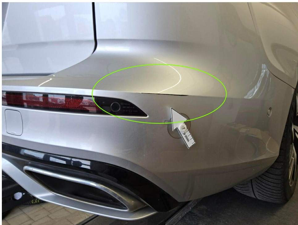
Bild 31 : Stoßfänger hinten Lackierung, zerkratzt, lackieren mit Lackaufbau
