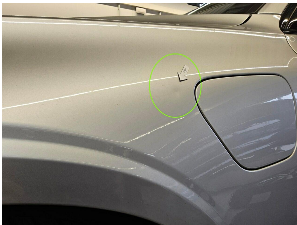
Bild 32 : Kotflügel vorne links, eingedellt, drücken
