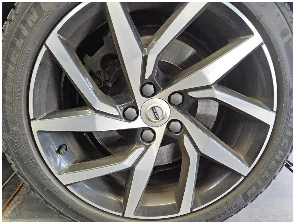
Bild 46 : Glanzgedrehte Aluminiumfelge hinten rechts, verschrammt
