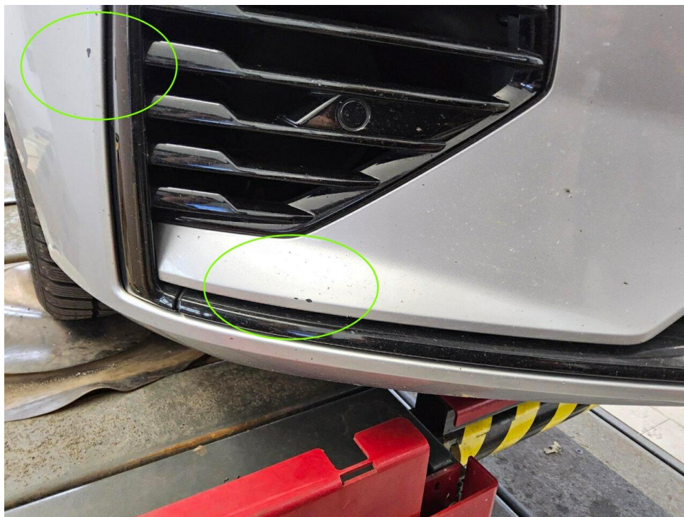
Bild 35 : Stoßfänger vorne Lackierung, zerkratzt, lackieren mit Lackaufbau
