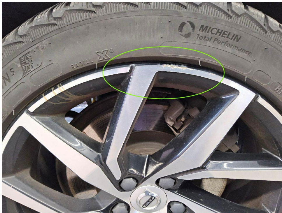
Bild 42 : Glanzgedrehte Aluminiumfelge hinten rechts, zerkratzt
