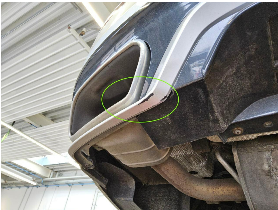
Bild 48 : Heckschürze hinten unten Lackierung, zerkratzt, lackieren mit Lackaufbau
