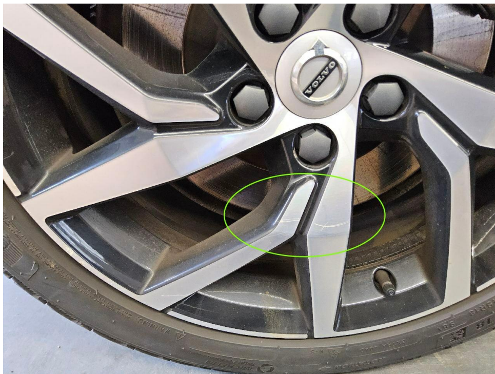
Bild 43 : Glanzgedrehte Aluminiumfelge hinten rechts, zerkratzt
