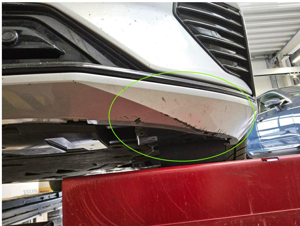
Bild 34 : Stoßfänger vorne Lackierung, zerkratzt, lackieren mit Lackaufbau
