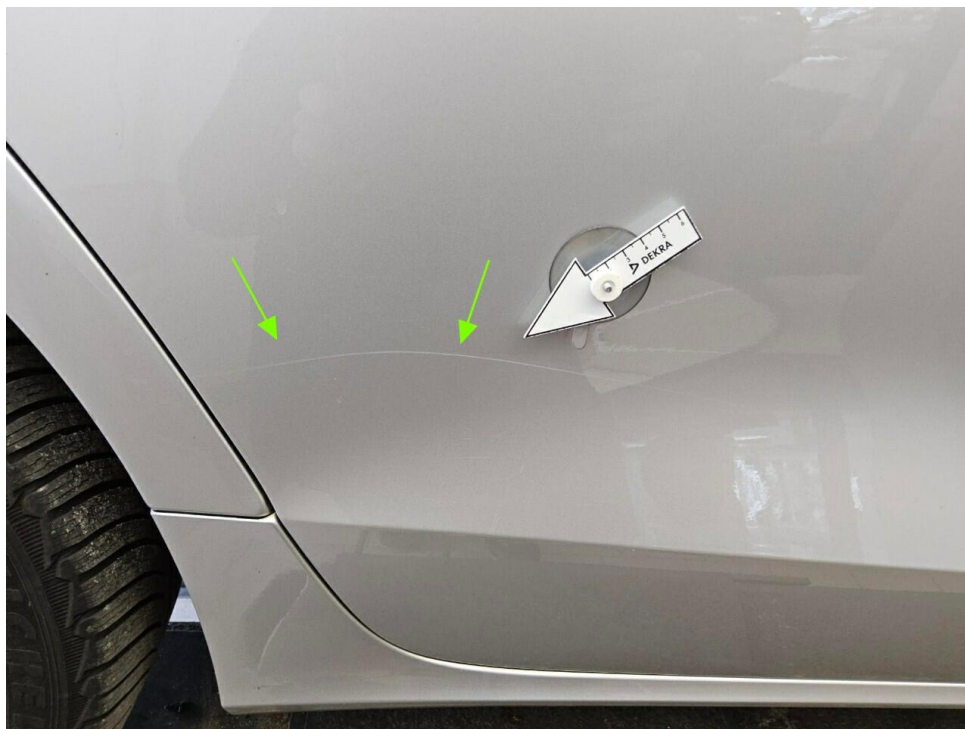
Bild 21 : Tür hinten rechts Lackierung, verschrammt, polieren
