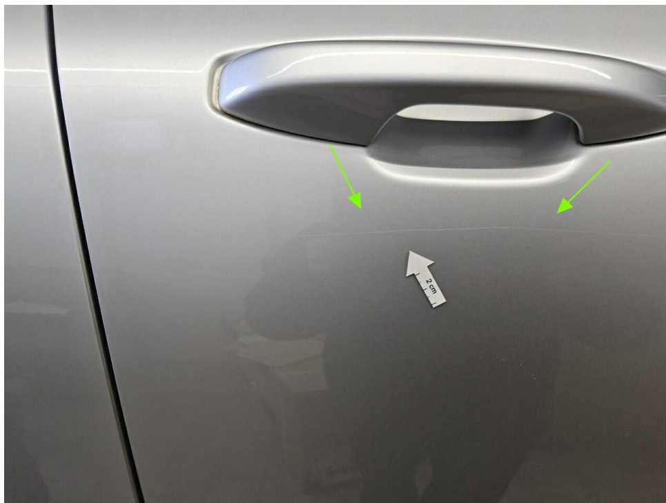
Bild 17 : Tür vorne rechts Lackierung, fleckig, lackieren
