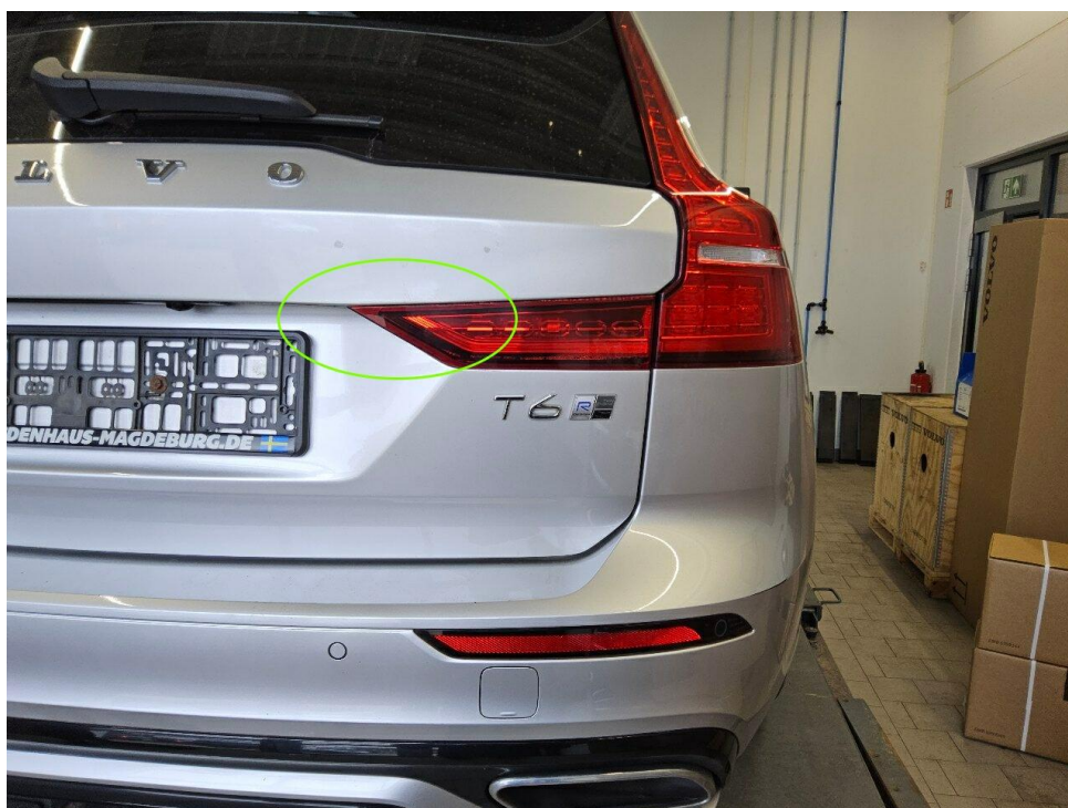
Bild 26 : Heckklappe Rücklicht, gebrochen
