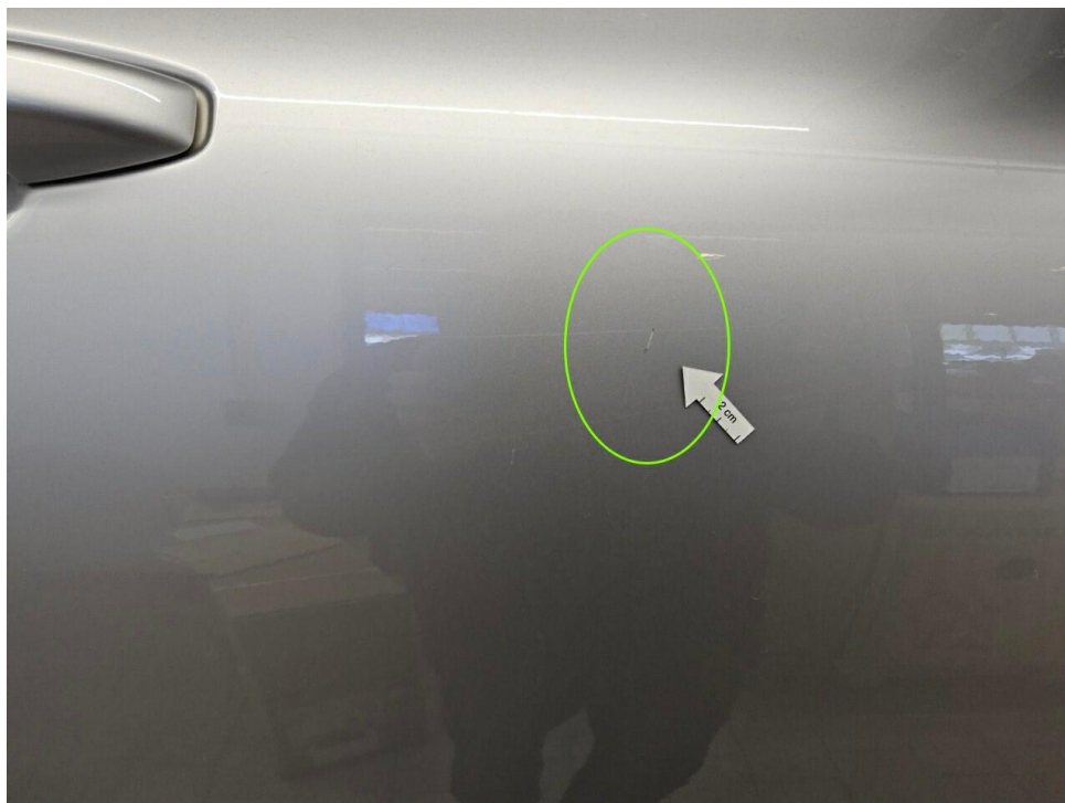
Bild 18 : Tür vorne rechts Lackierung, fleckig, lackieren
