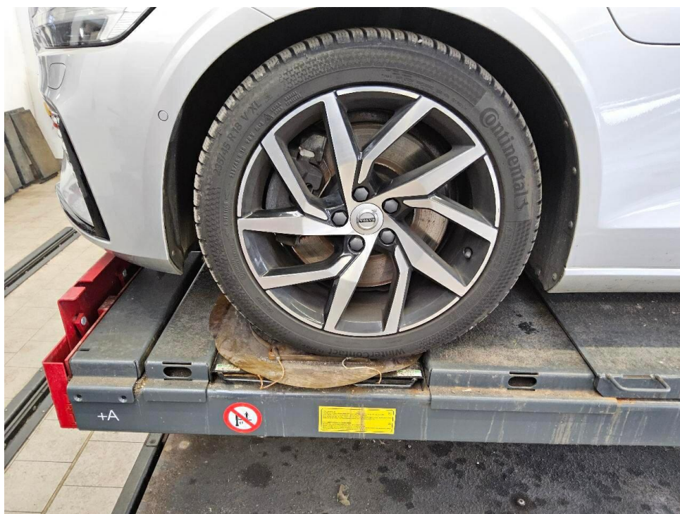
Bild 44 : Glanzgedrehte Aluminiumfelge vorn links, zerkratzt
