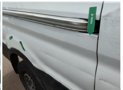
Seitenwand / Hinten Rechts / Delle
