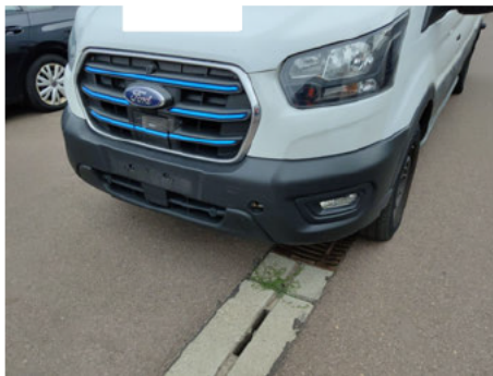
Stoßfänger / Vorne / Gebrochen
