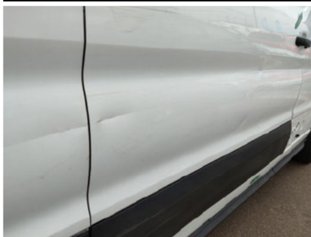
Tür / Rechts / Delle
