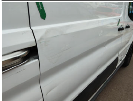
Tür / Rechts / Delle
