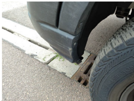
Stoßfänger / Vorne / Gebrochen
