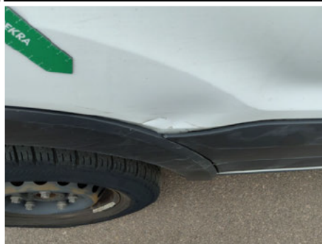
Seitenwand / Hinten Rechts / Delle
