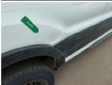
Seitenwand / Hinten Rechts / Delle
