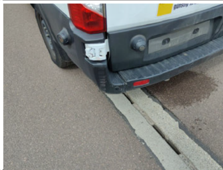
Stoßfänger / Hinten Links / Gebrochen
