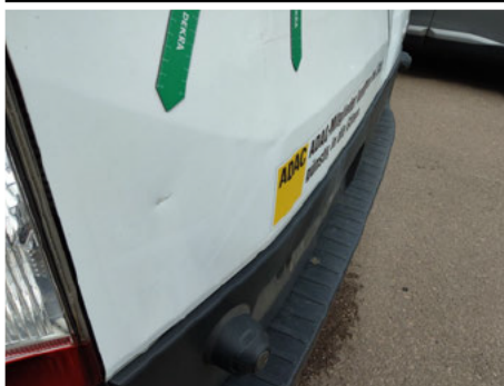
Tür / Hinten Links / Delle
