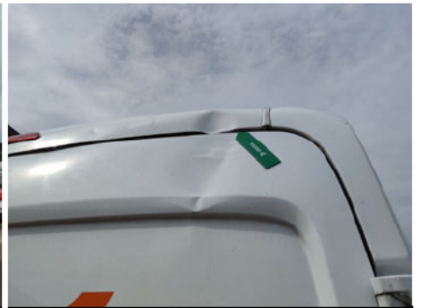
Dach / Hinten / Delle
