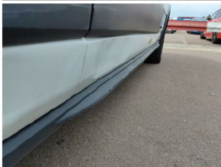
Tür / Rechts / Delle
