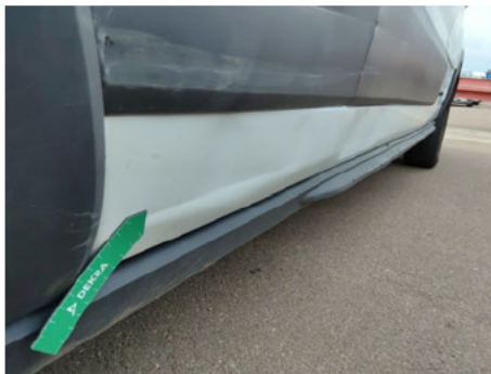
Schweller / Hinten Rechts / Delle
