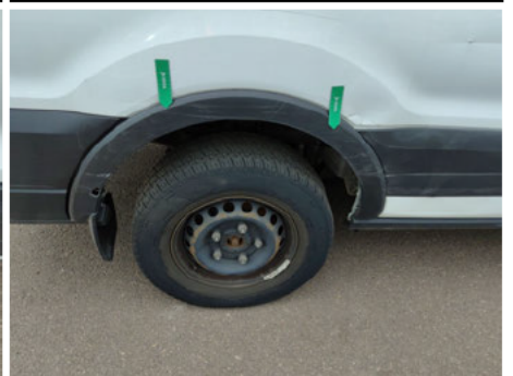
Kotflügelverbreiterung / Hinten Rechts / Gebrochen
