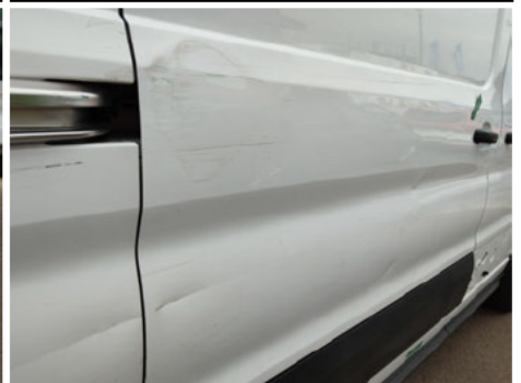
Tür / Rechts / Delle
