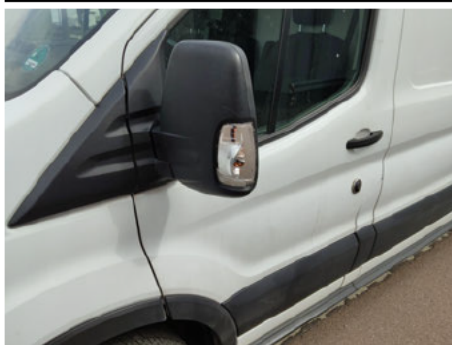
Blinker / Links / Gebrochen
