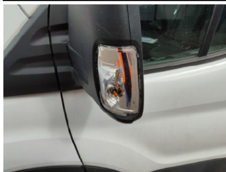
Blinker / Links / Gebrochen
