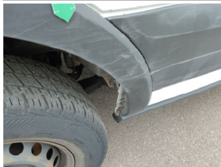
Kotflügelverbreiterung / Hinten Rechts / Gebrochen
