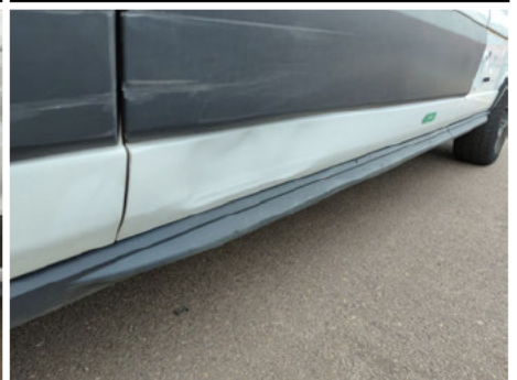
Tür / Rechts / Delle
