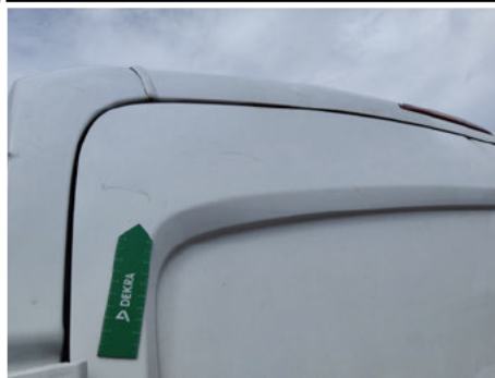
Tür / Hinten Links / Delle
