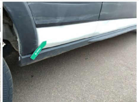
Schweller / Hinten Rechts / Delle
