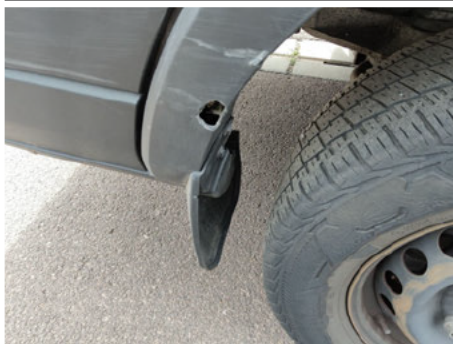
Kotflügelverbreiterung / Hinten Rechts / Gebrochen
