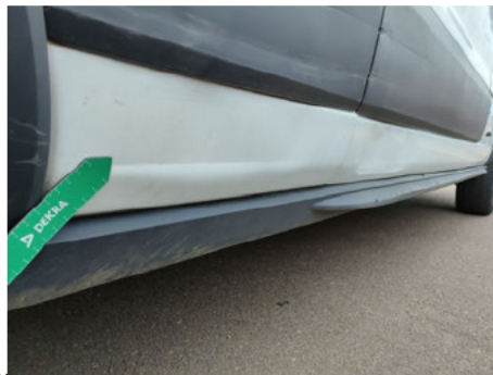
Schweller / Hinten Rechts / Delle
