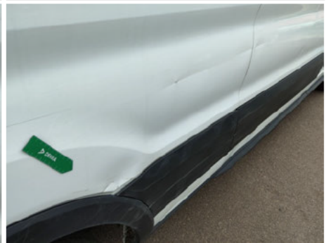
Seitenwand / Hinten Rechts / Delle
