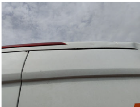
Dach / Hinten / Delle
