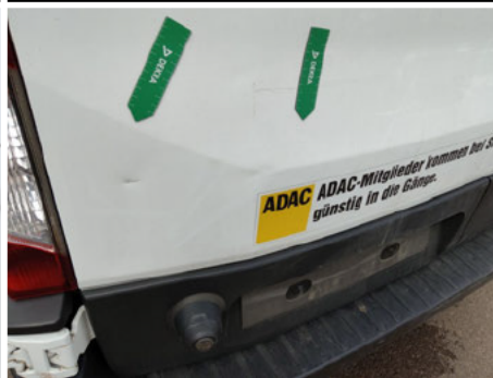
Tür / Hinten Links / Delle
