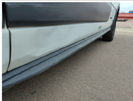
Tür / Rechts / Delle
