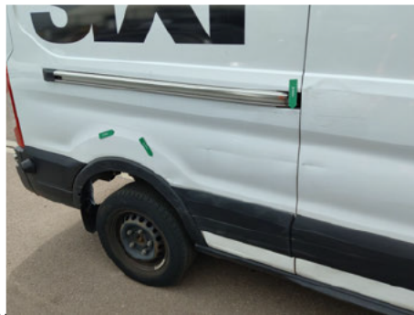
Seitenwand / Hinten Rechts / Delle
