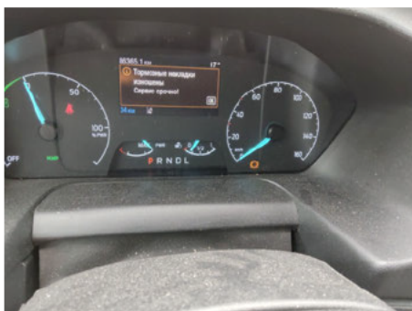
Warnleuchte Bremssystem / Defekt
