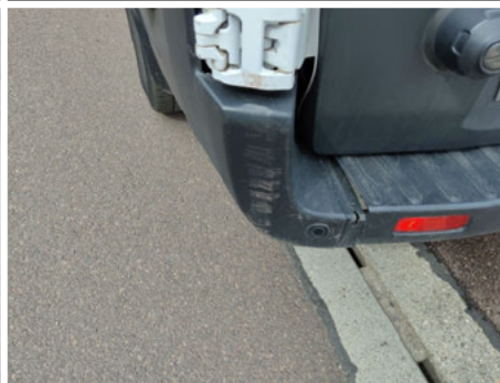
Stoßfänger / Hinten Links / Gebrochen
