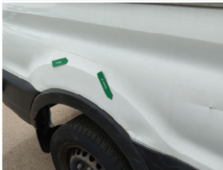
Seitenwand / Hinten Rechts / Delle
