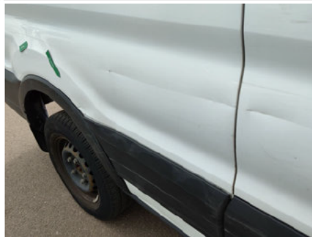
Seitenwand / Hinten Rechts / Delle
