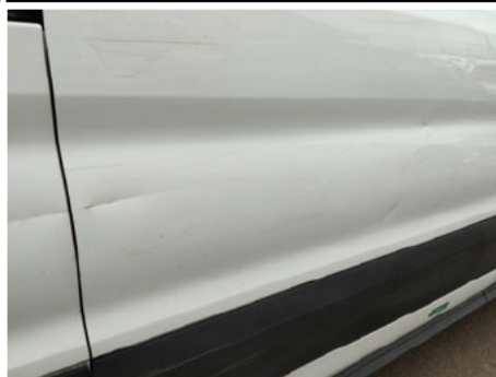
Tür / Rechts / Delle
