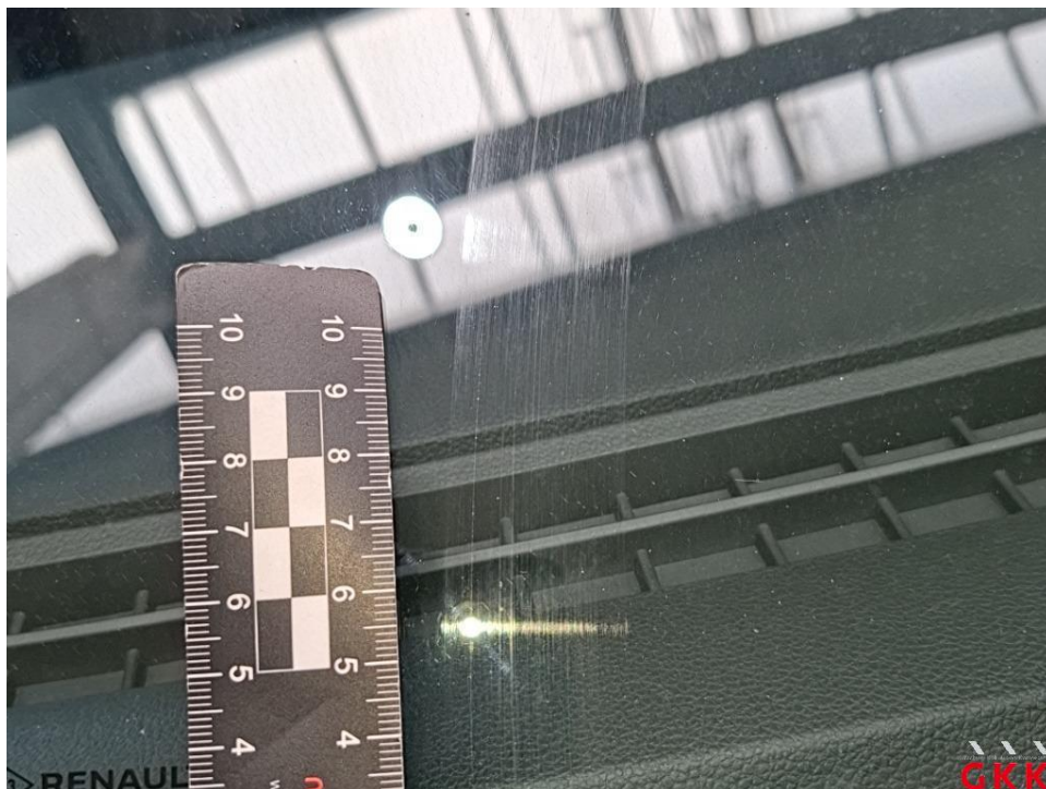
Bild 17. Frontscheibe, mit Regensensor, Frontkamera und Head-up-Display, verkratzt, ersetzen
