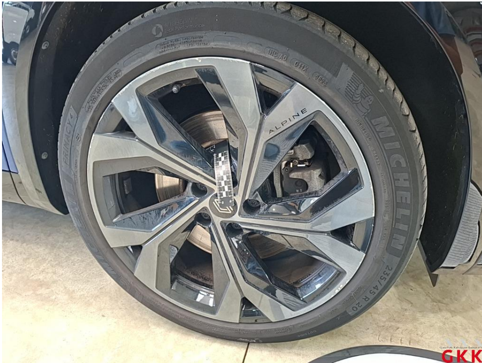
Bild 21. LM-Rad, vorne rechts, Materialabtrag, ersetzen
