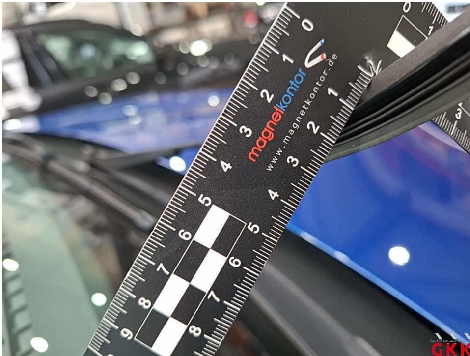
Bild 20. Scheibenwischer vorne, Blatt -rechts-, beschädigt, ersetzen
