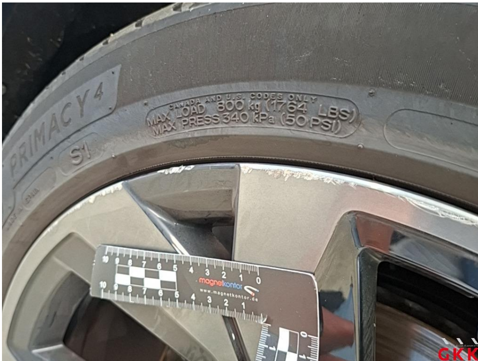
Bild 22. LM-Rad, vorne rechts, Materialabtrag, ersetzen
