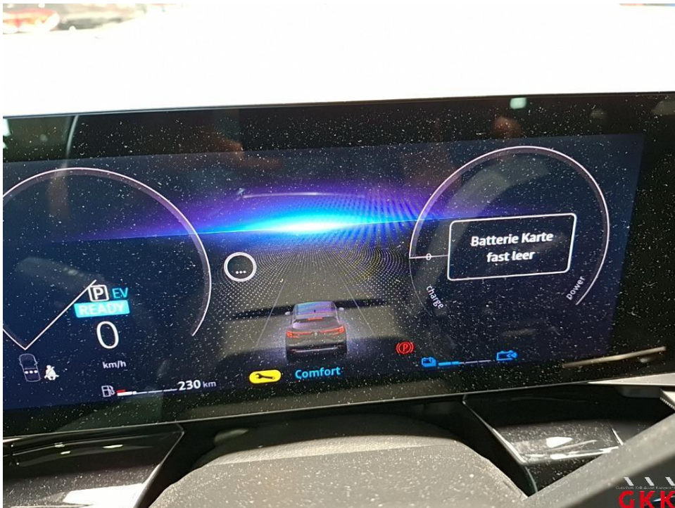
Bild 14. Hauptschlüssel, Batterie, entladen, ersetzen
