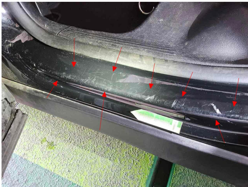
Bild 30 : Einstiegslackierung hinten links zerkratzt
