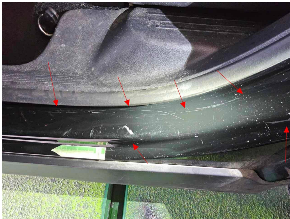
Bild 31 : Einstiegslackierung hinten links zerkratzt
