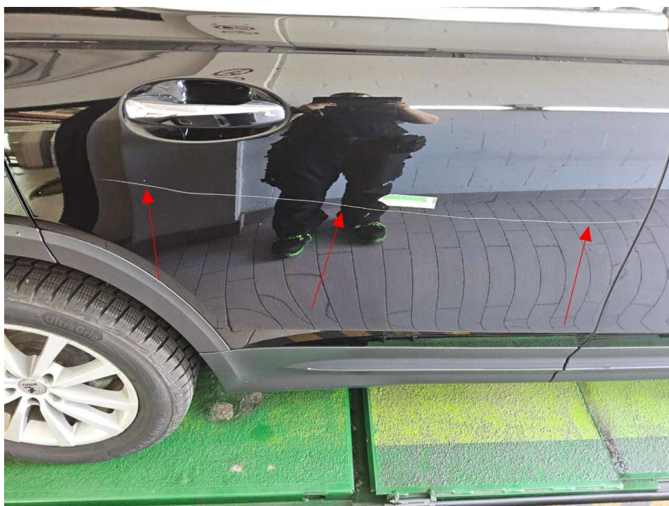
Bild 22 : Tür hinten rechts langer, tiefer Kratzer
