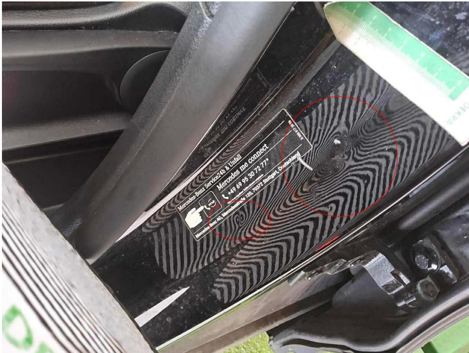
Bild 33 : Einstiegslackierung vorne links Dellen und Kratzer
