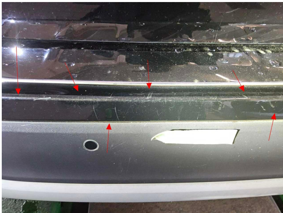
Bild 24 : Stoßfänger hinten Lackierung zerkratzt
