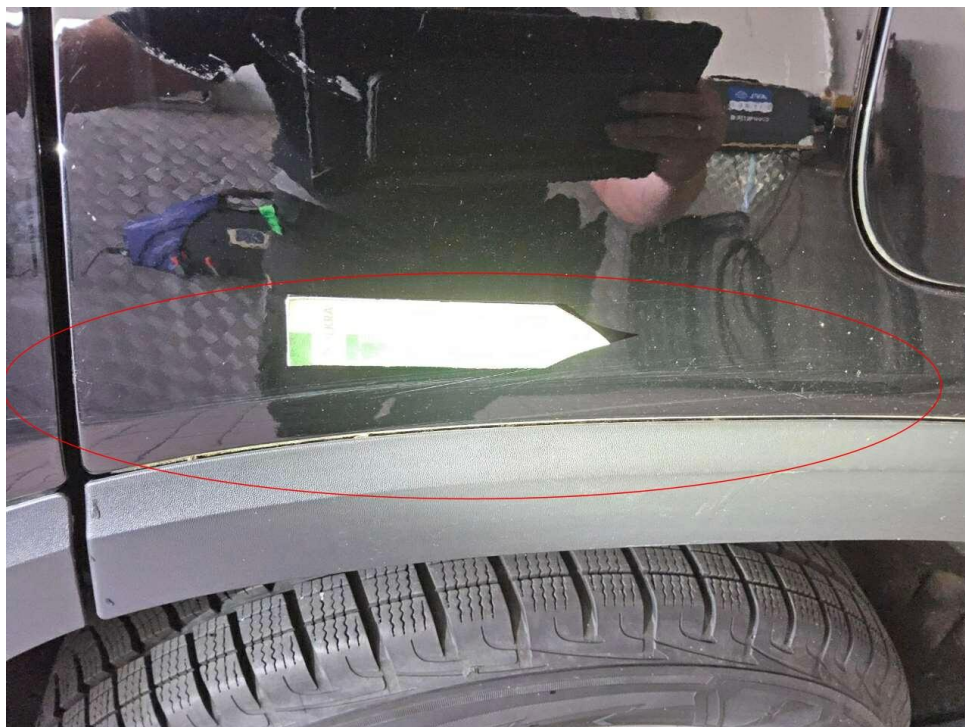
Bild 28 : Seitenteil hinten links Lackierung zerkratzt
