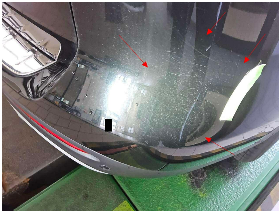
Bild 25 : Stoßfänger hinten Lackierung zerkratzt
