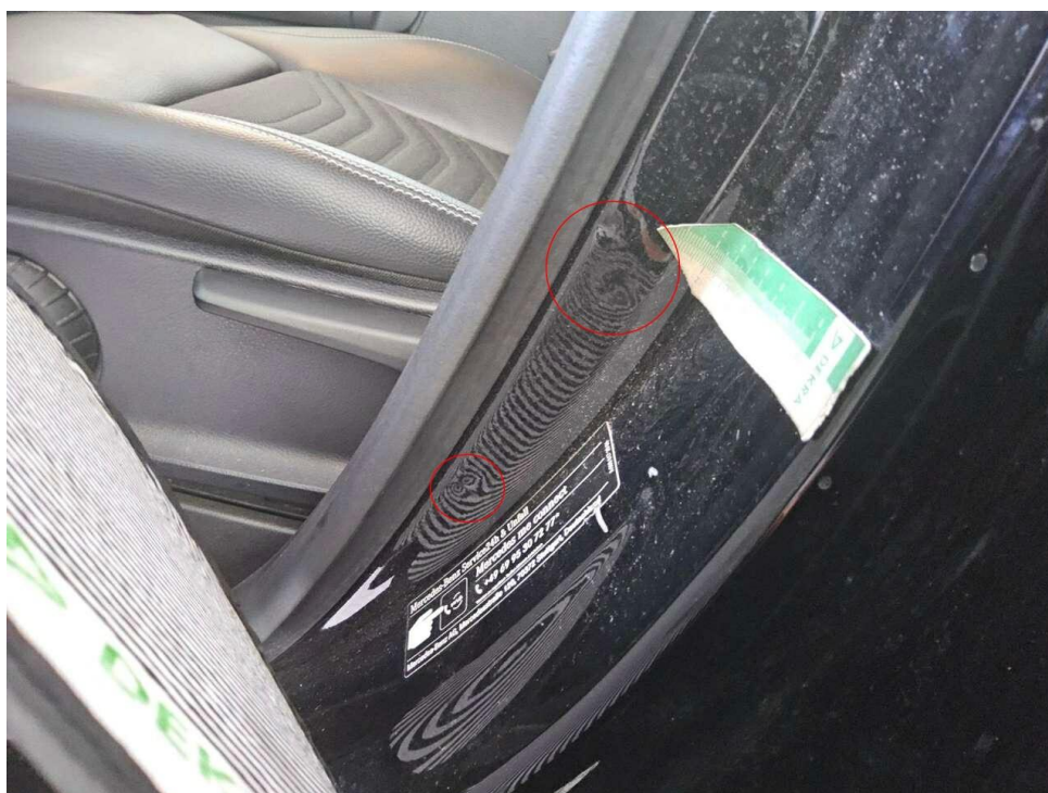
Bild 32 : Einstiegslackierung vorne links Dellen und Kratzer
