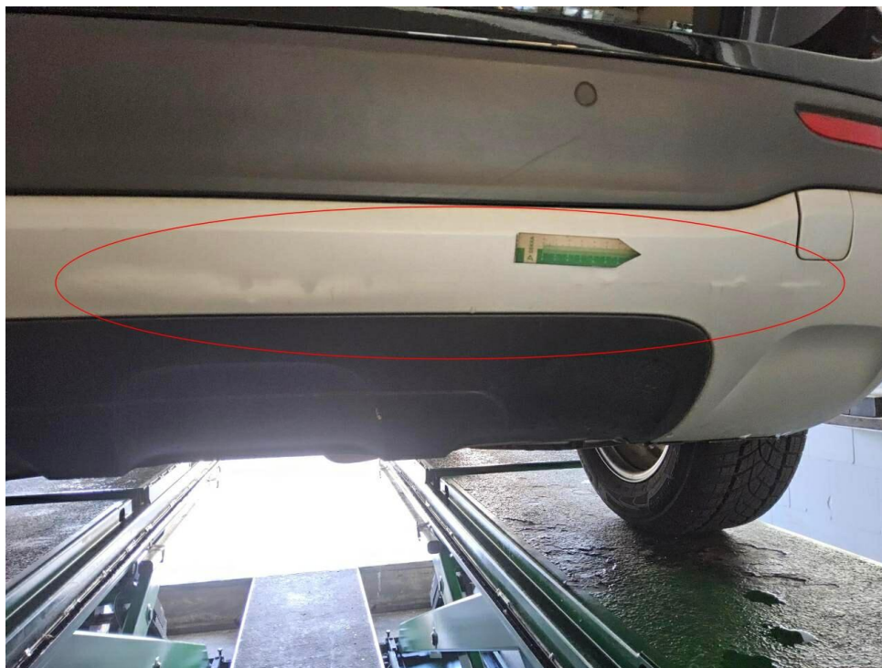
Bild 14 : Heckschürze hinten unten deformiert; Anstoß
