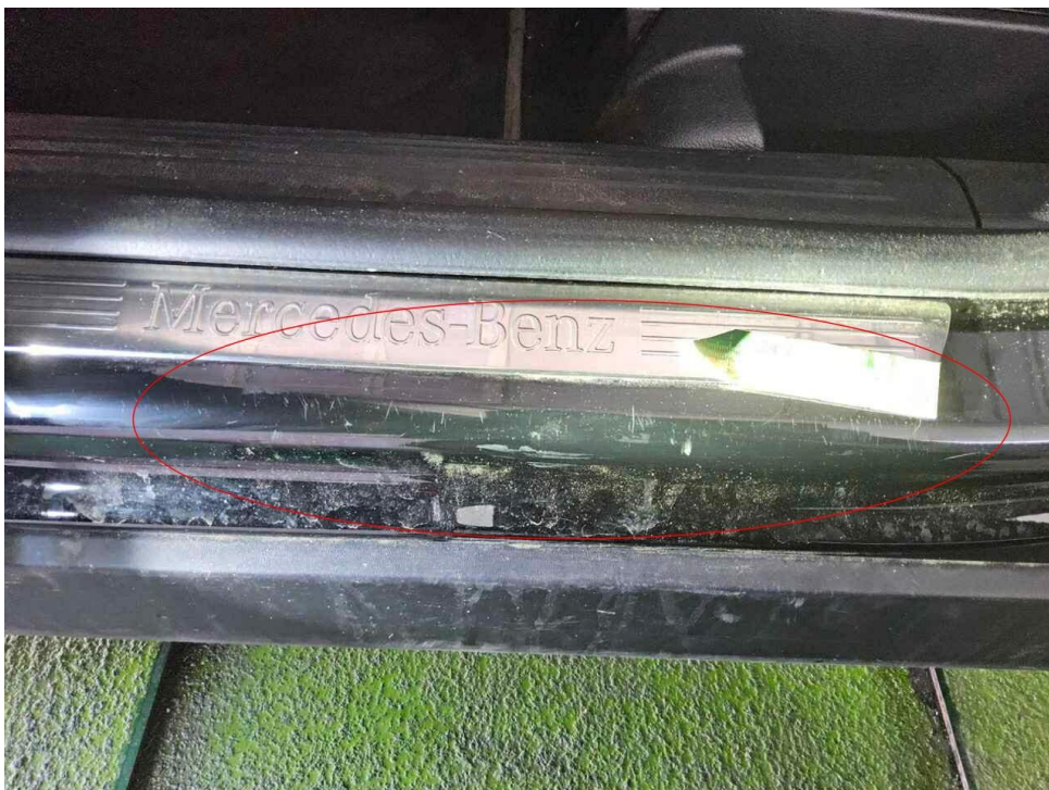
Bild 34 : Einstiegslackierung vorne links Dellen und Kratzer
