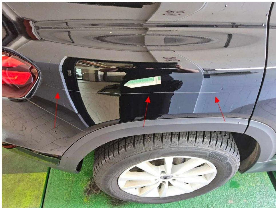
Bild 23 : Seitenteil hinten rechts langer, tiefer Kratzer
