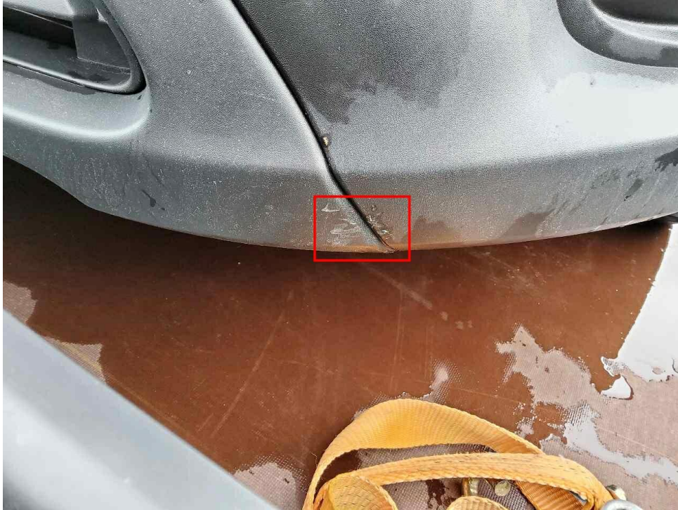
Bild 11 : Stoßfänger vorne unterhalb verschrammt
