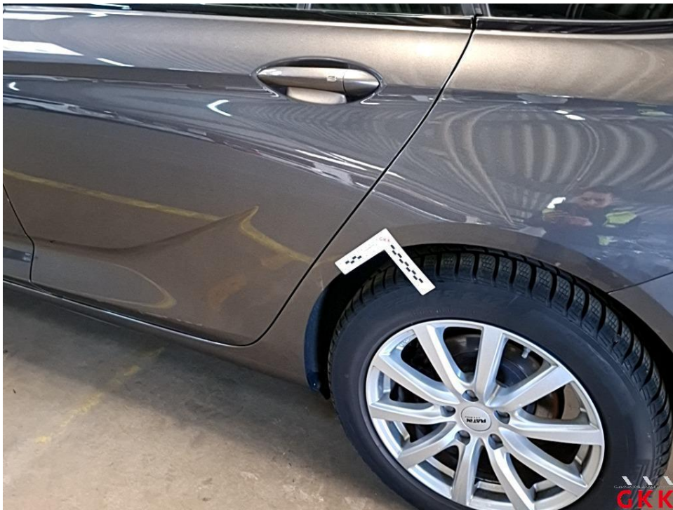
Bild 26 Seitenwand links, beschädigt, kalt drücken
