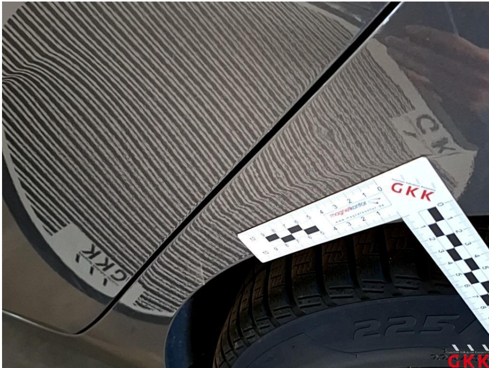
Bild 27 Seitenwand links, beschädigt, kalt drücken
