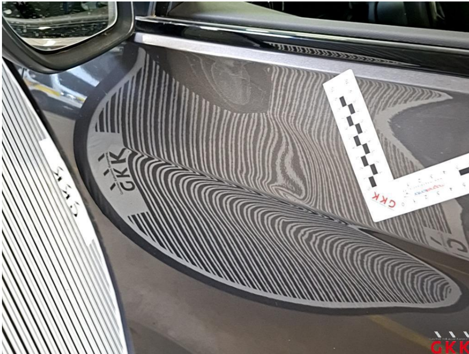
Bild 17 Tür vorne links, beschädigt, instand setzen - lackieren
