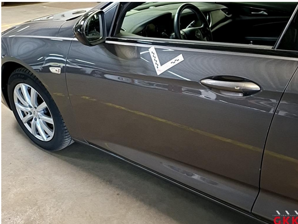
Bild 16 Tür vorne links, beschädigt, instand setzen - lackieren
