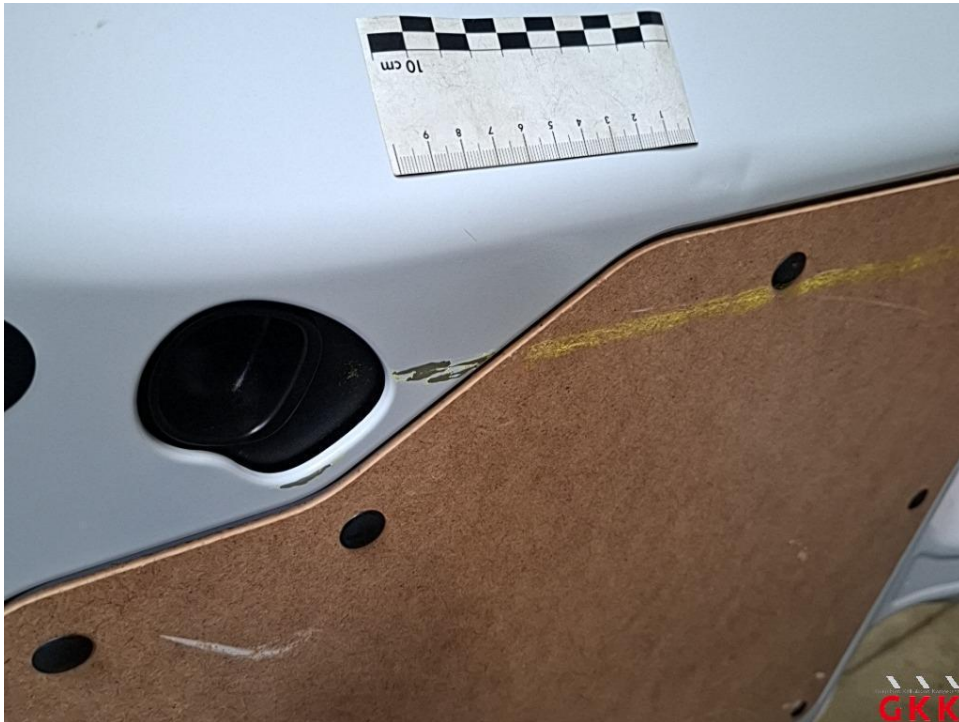
Bild 19 Hecktür links, innen, beschädigt, Smartrepair
