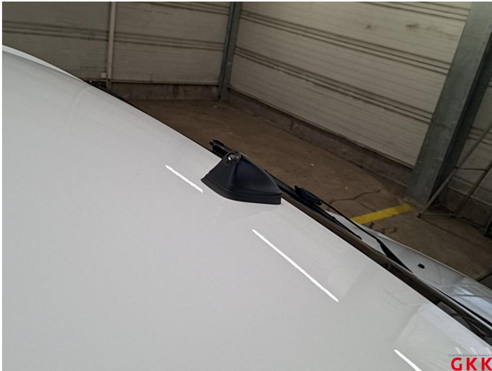
Bild 33 Antenne, Stab, fehlt, ersetzen
