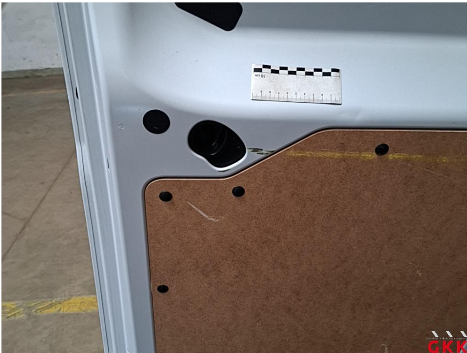
Bild 18 Hecktür links, innen, beschädigt, Smartrepair
