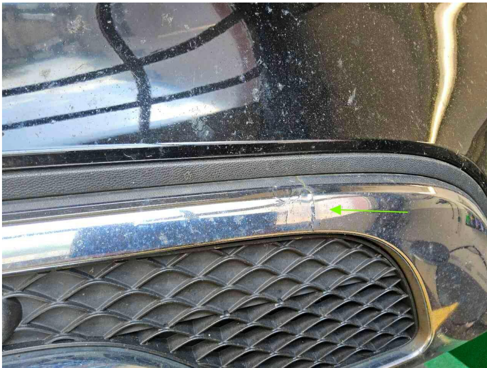
Bild 18 : Chromleiste Stoßstange vorne eingerissen
