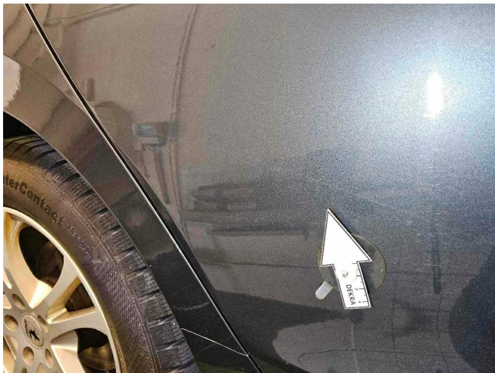
Bild 31 : Tür hinten rechts Lackierung, zerkratzt, Gebrauchsspur
