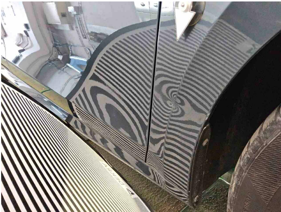
Bild 36 : Kotflügel rechts, eingedrückt
