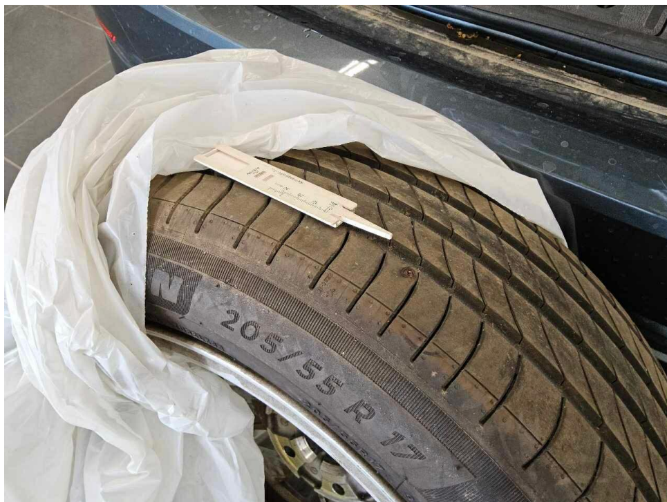
Bild 16 : Sommerreifen vorne links, Schraube eingedrungen
