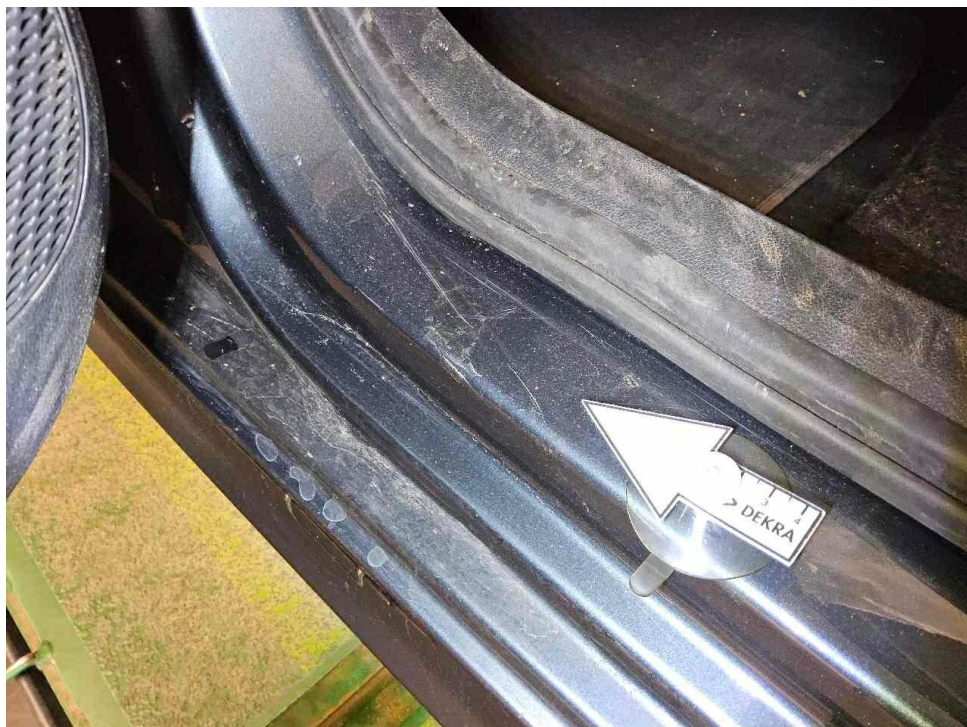
Bild 22 : Tür hinten links Einstieg Lackierung, zerkratzt, smart repair
