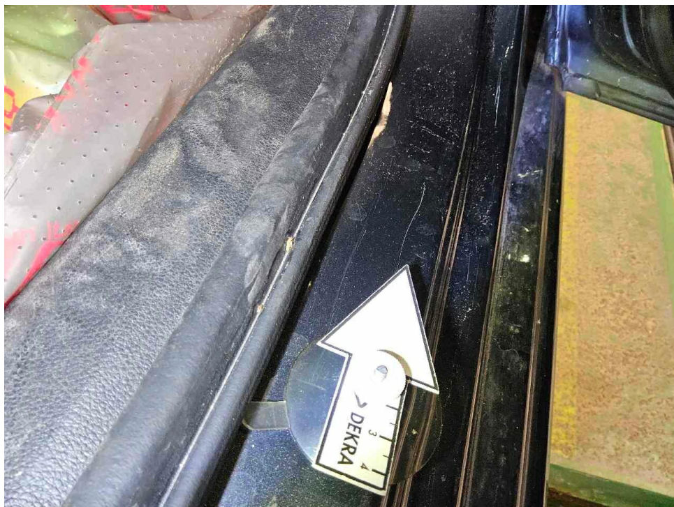
Bild 32 : Tür hinten rechts Einstieg Lackierung, zerkratzt, smart repair
