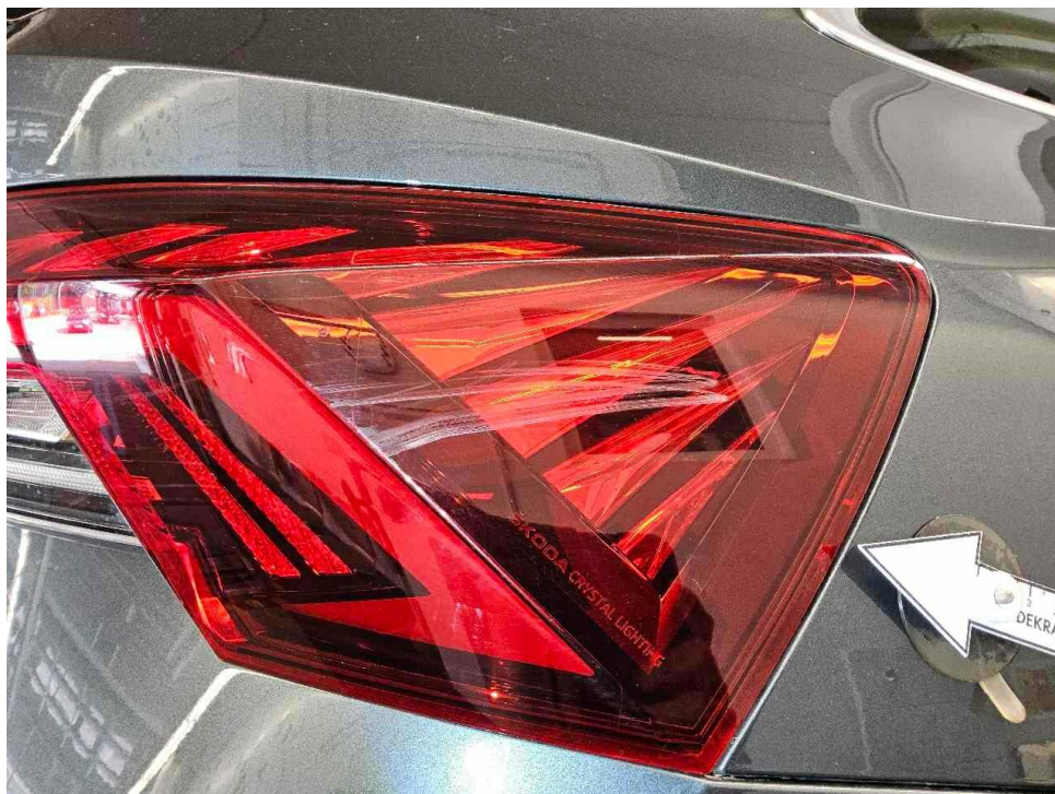
Bild 28 : Rückleuchte rechts, zerkratzt
