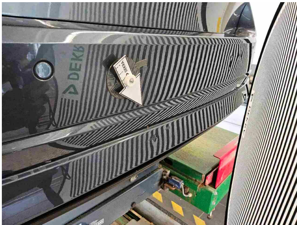
Bild 24 : Stoßfänger hinten, eingedellt, instandsetzen und lackieren mit Lackaufbau
