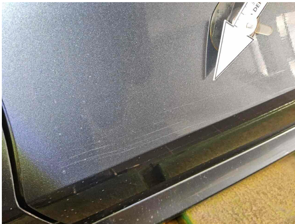
Bild 18 : Tür hinten links Lackierung, zerkratzt, lackieren
