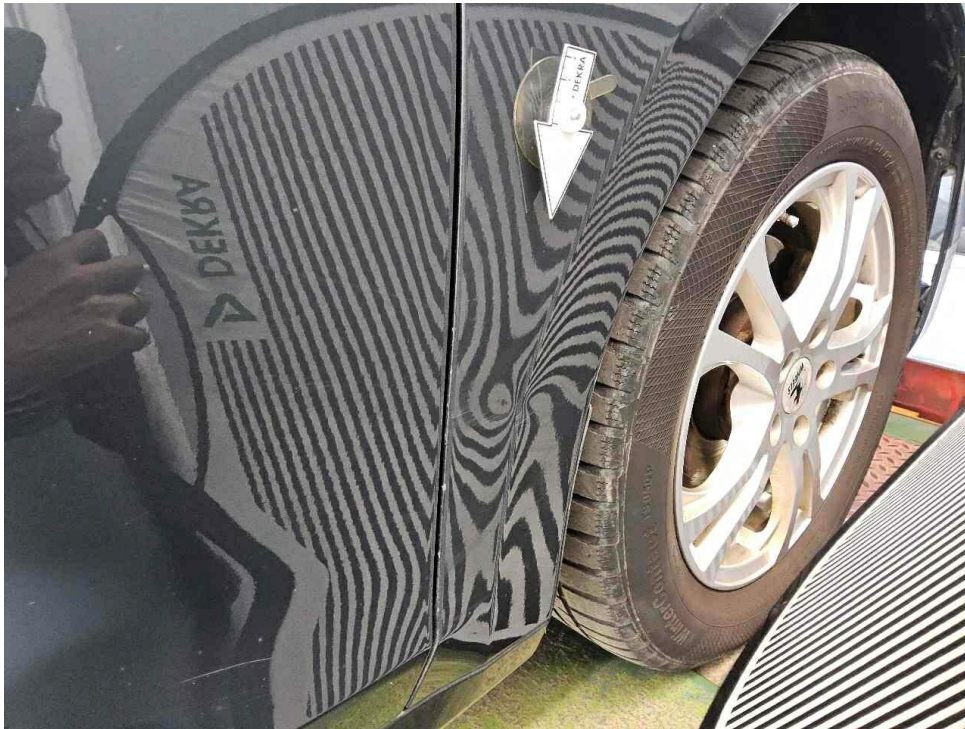
Bild 35 : Kotflügel rechts, eingedrückt
