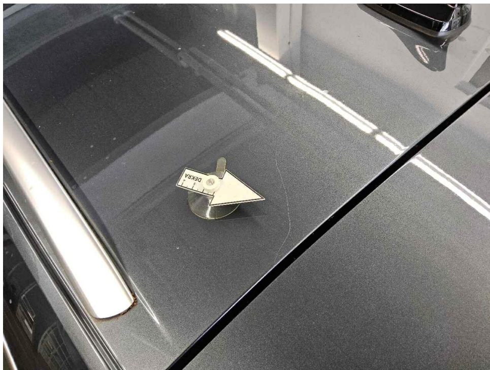
Bild 17 : Dach Lackierung, zerkratzt, Gebrauchsspur
