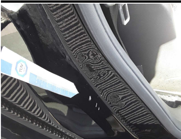
Beschädigung #7: Schweller rechts: Einstieg - Delle / Lackschaden - instandsetzen und lackieren
