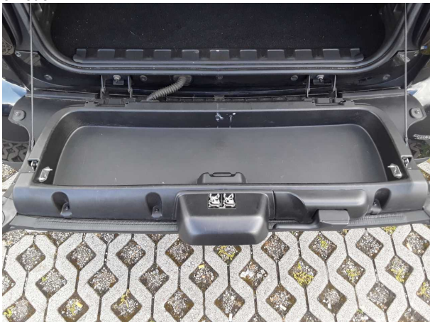
Beschädigung #3: Verkleidungen/Abdeckungen: Heckdeckel, Innenverkleidung (Abdeckung Staufach) - fehlt - erneuern
