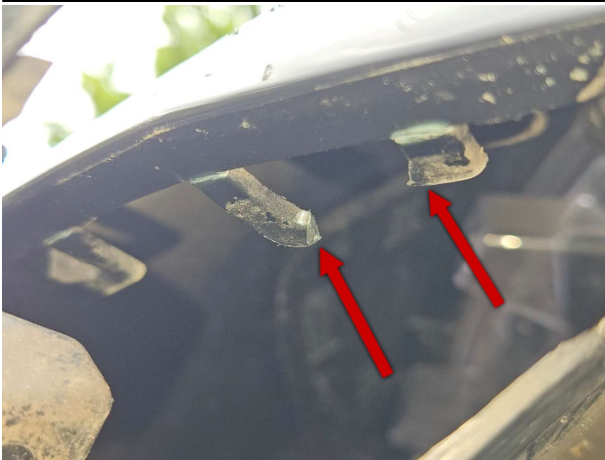
Beschädigung #8: Stossfänger vorn: Stossfänger vorn - gebrochen / gerissen - erneuern
