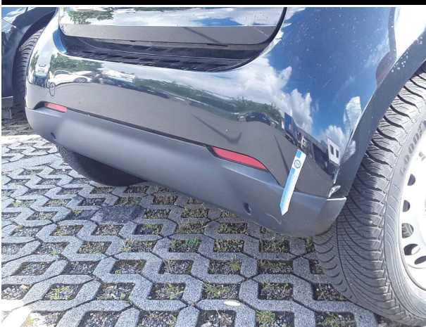
Beschädigung #5: Stossfänger hinten: Spoiler - verkratzt / verschürft - erneuern
