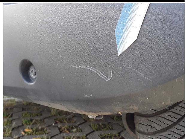
Beschädigung #5: Stossfänger hinten: Spoiler - verkratzt / verschürft - erneuern
