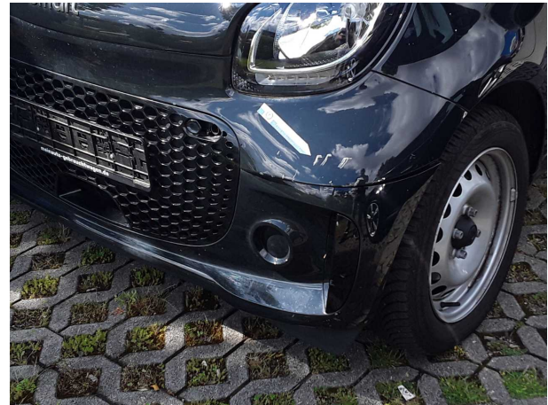
Beschädigung #8: Stossfänger vorn: Stossfänger vorn - gebrochen / gerissen - erneuern
