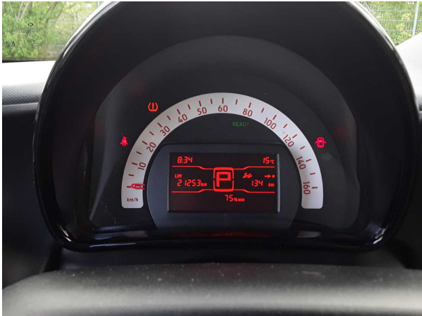
Beschädigung #1: Instrumententafel: Kontrollleuchte (Reifendrucksystem) - leuchtet - Diagnose durchführen
