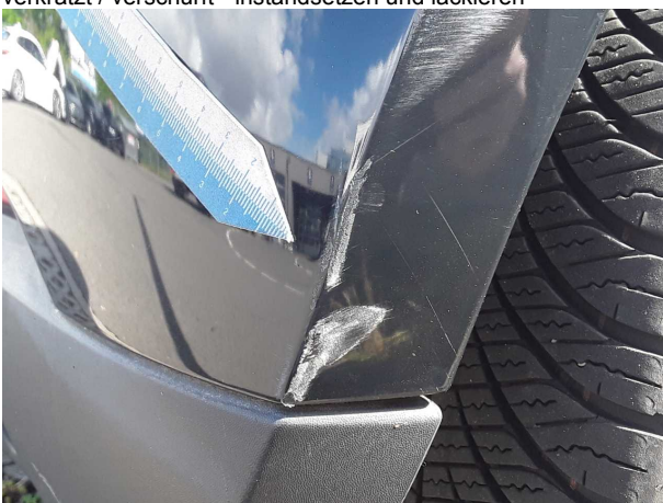
Beschädigung #6: Stossfänger hinten: Stossfänger hinten - verkratzt / verschürft - instandsetzen und lackieren
