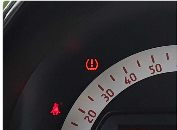
Beschädigung #1: Instrumententafel: Kontrollleuchte (Reifendrucksystem) - leuchtet - Diagnose durchführen
