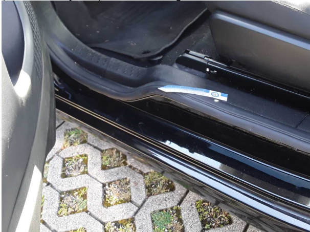
Beschädigung #2: Tür vorn links: Türdichtung - beschädigt - erneuern
