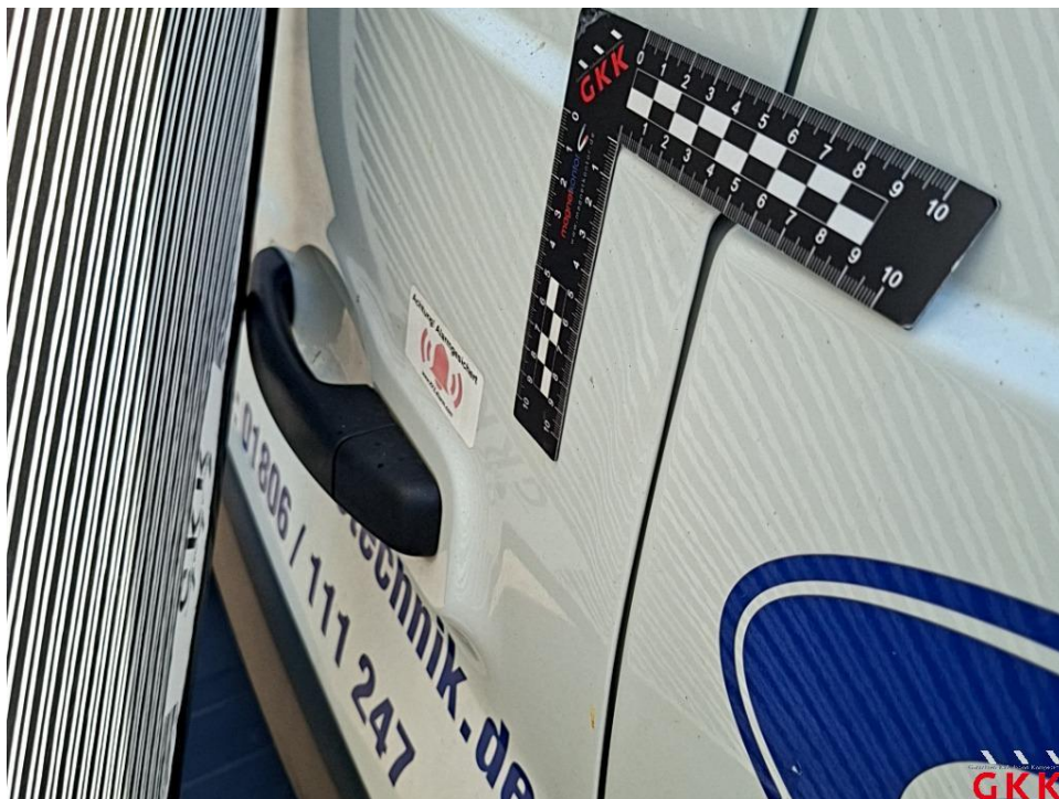
Bild 25. Hecktür links, Kante, beschädigt, Smartrepair
