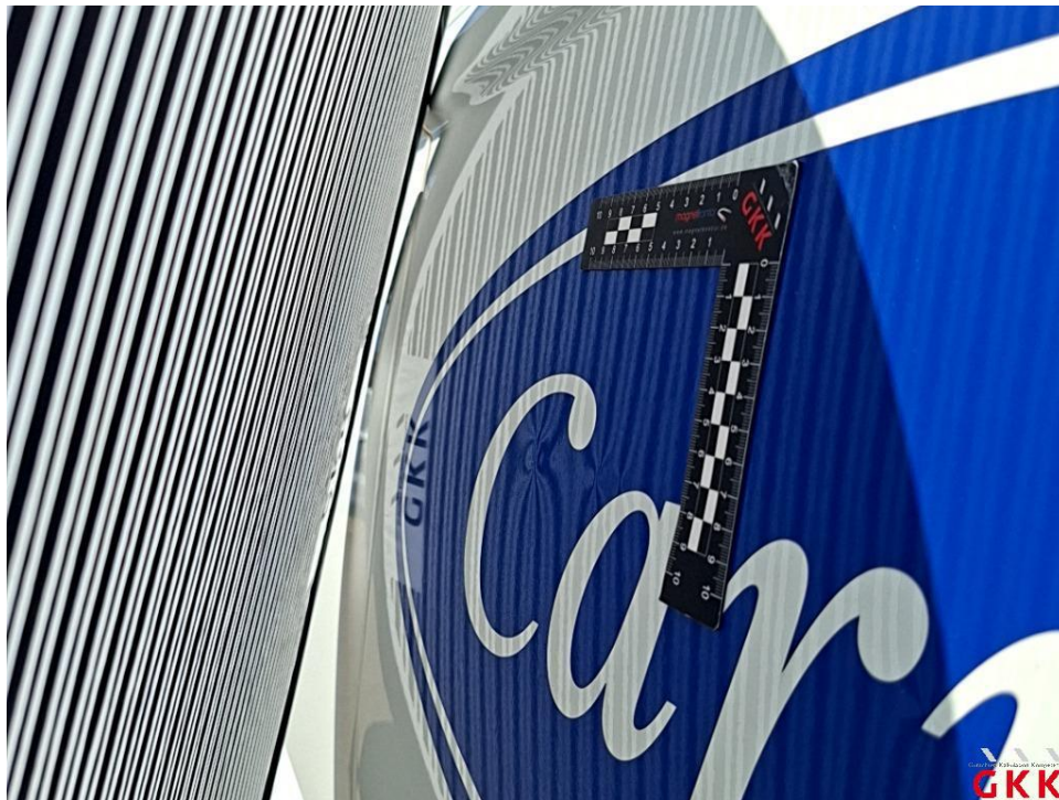
Bild 23. Schiebetür rechts, bis 3 Dellen / Bauteil, kalt drücken
