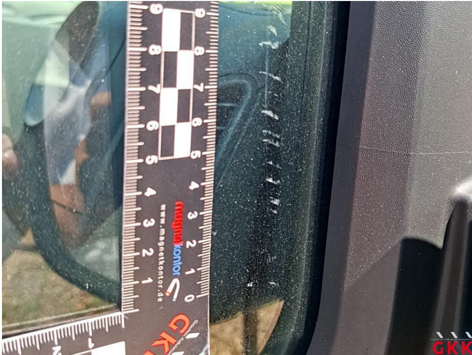
Bild 21. Tür vorne rechts, Dreieckscheibe, verkratzt, ersetzen
