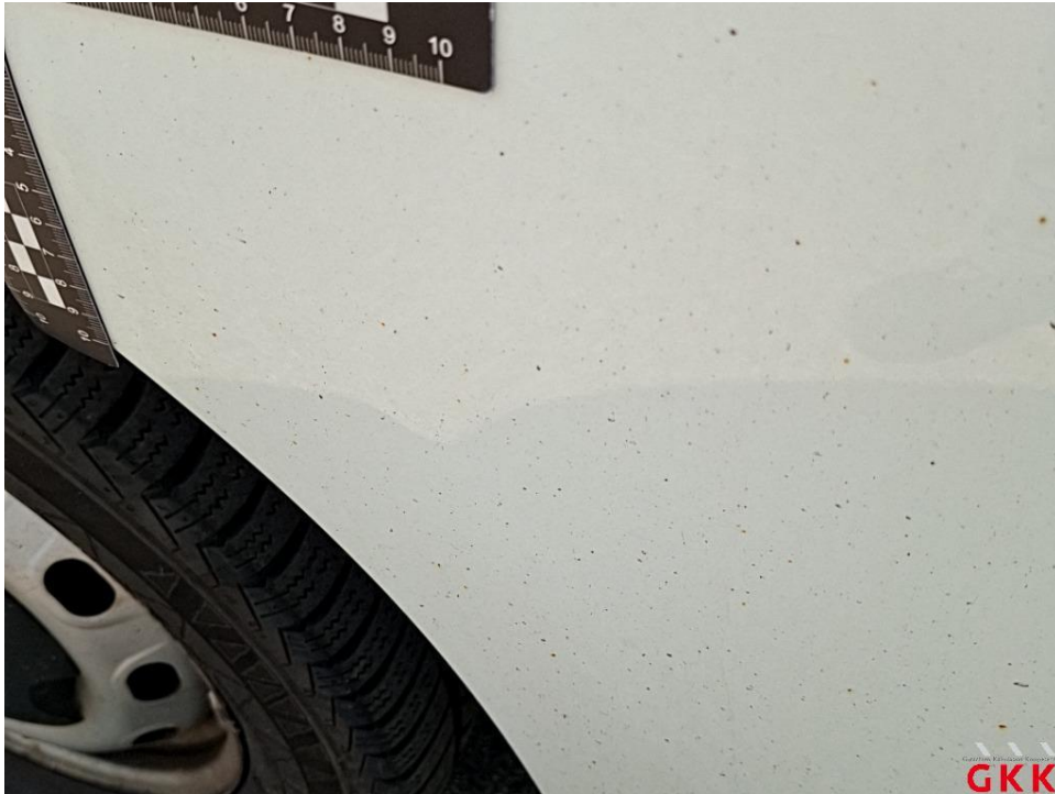
Bild 17. Fahrzeug, außen, Industriestaubanhaftung / Flugrost, aufbereiten
