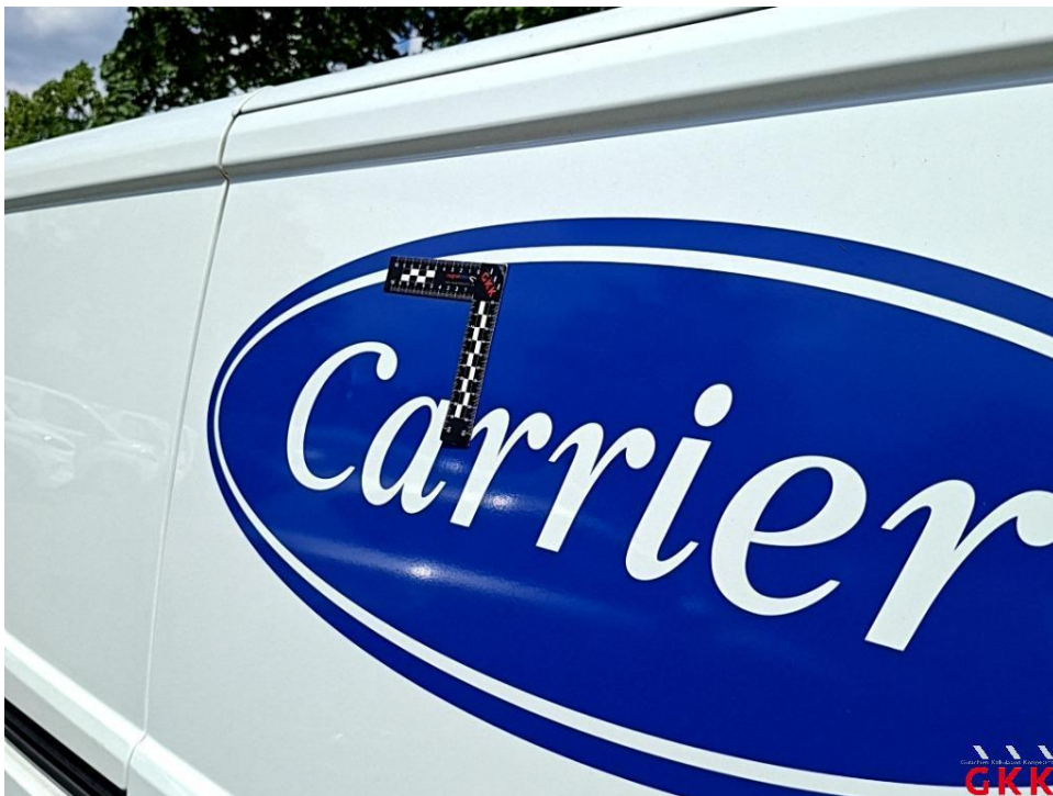
Bild 22. Schiebetür rechts, bis 3 Dellen / Bauteil, kalt drücken
