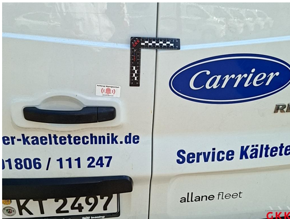
Bild 24. Hecktür links, Kante, beschädigt, Smartrepair
