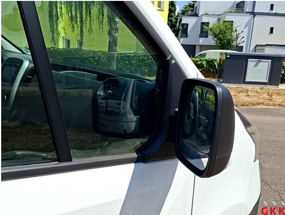
Bild 20. Tür vorne rechts, Dreieckscheibe, verkratzt, ersetzen
