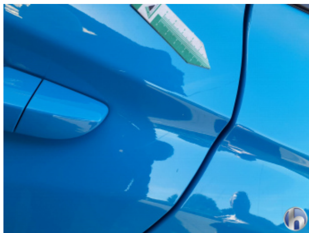
2. Tür Hinten - Links Oberflächenkratzer - Aufbereiten / Polieren
