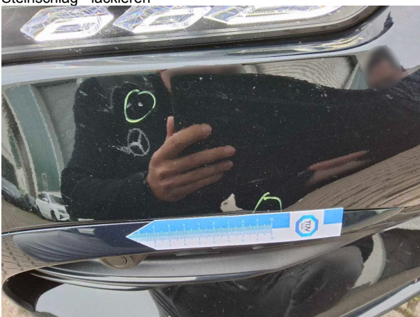
Beschädigung #4: Stossfänger vorn: Stossfänger vorn - Steinschlag - lackieren
