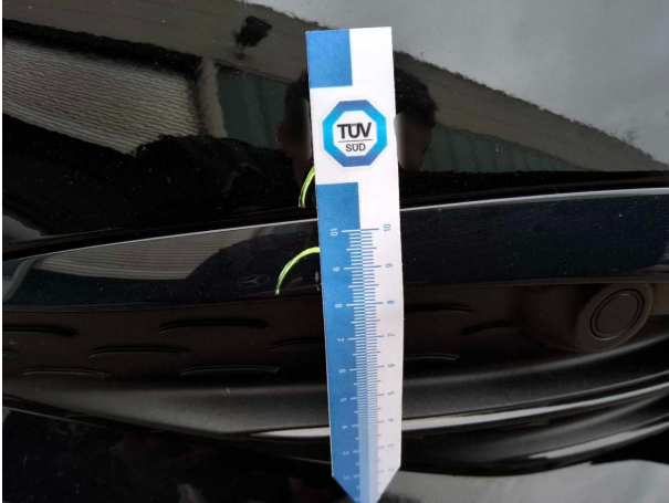
Beschädigung #1: Stossfänger vorn: Stossfänger vorn (Blende links) - Kratzer - Smart Repair
