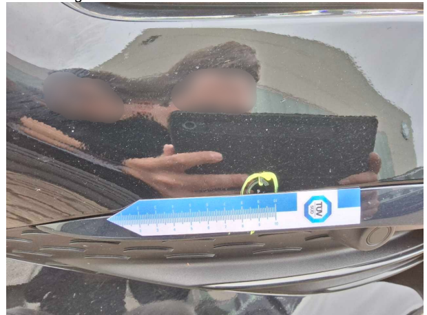
Beschädigung #4: Stossfänger vorn: Stossfänger vorn - Steinschlag - lackieren
