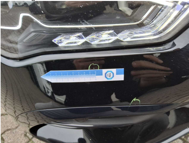
Beschädigung #4: Stossfänger vorn: Stossfänger vorn - Steinschlag - lackieren
