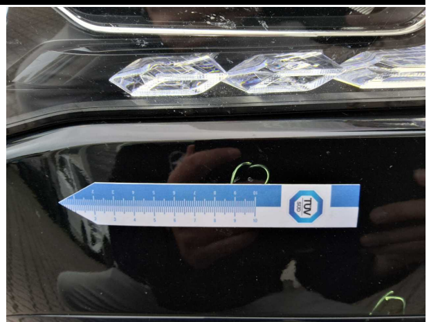
Beschädigung #4: Stossfänger vorn: Stossfänger vorn - Steinschlag - lackieren
