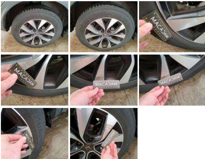
Pneu ARD, Déchirure, E - Remplacer
