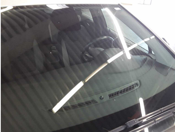
Damage 7: Vehicle glazing: Windscreen (Zu viele Steinschläge) - Stone chips - Replace
