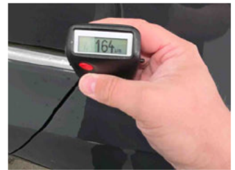
Lackstärke Seitenwand hinten links
