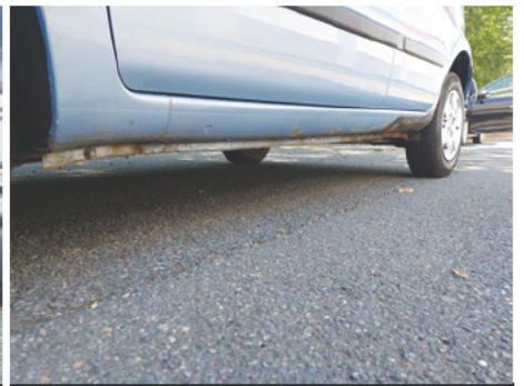
Schweller / Links / Rost
