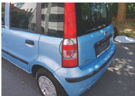
Heckleuchte / Hinten Links / Riss
