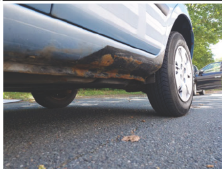
Schweller / Links / Rost
