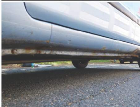
Schweller / Links / Rost
