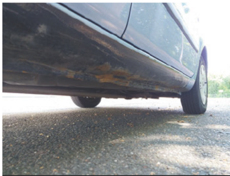
Schweller / Rechts / Rost
