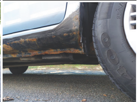
Schweller / Links / Rost
