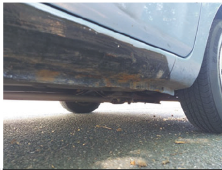
Schweller / Rechts / Rost
