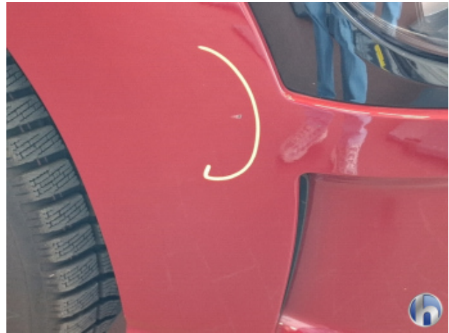
2. Stoßfänger Vorne Kratzer - Smart Repair
