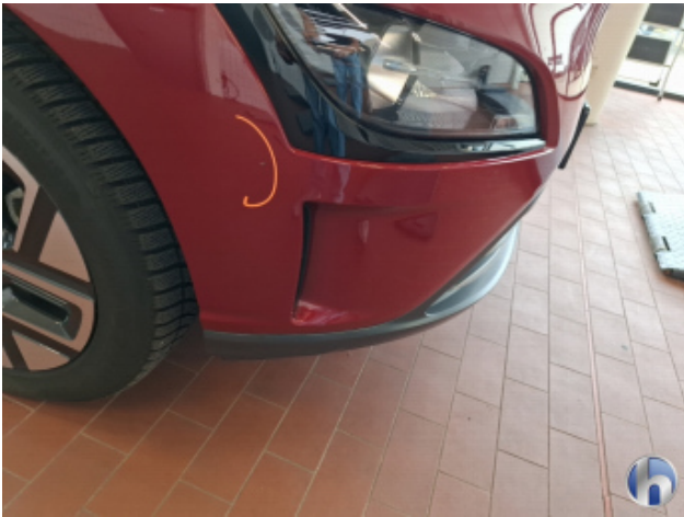
2. Stoßfänger Vorne Kratzer - Smart Repair
