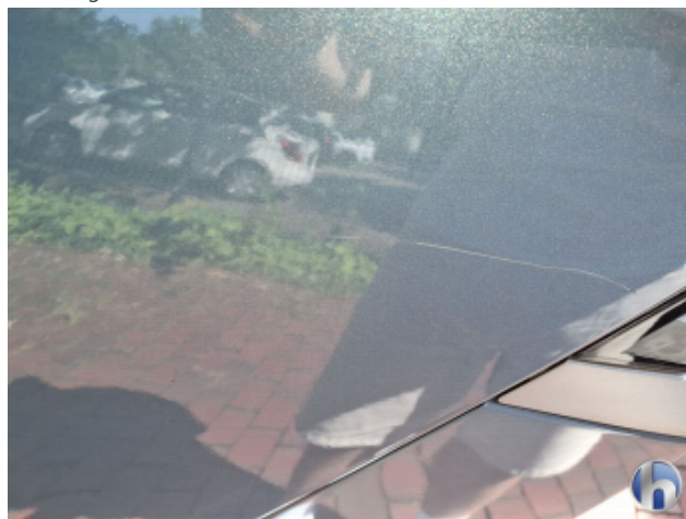
1. Seitenwand - Hinten - Links Kratzer - Smart Repair
