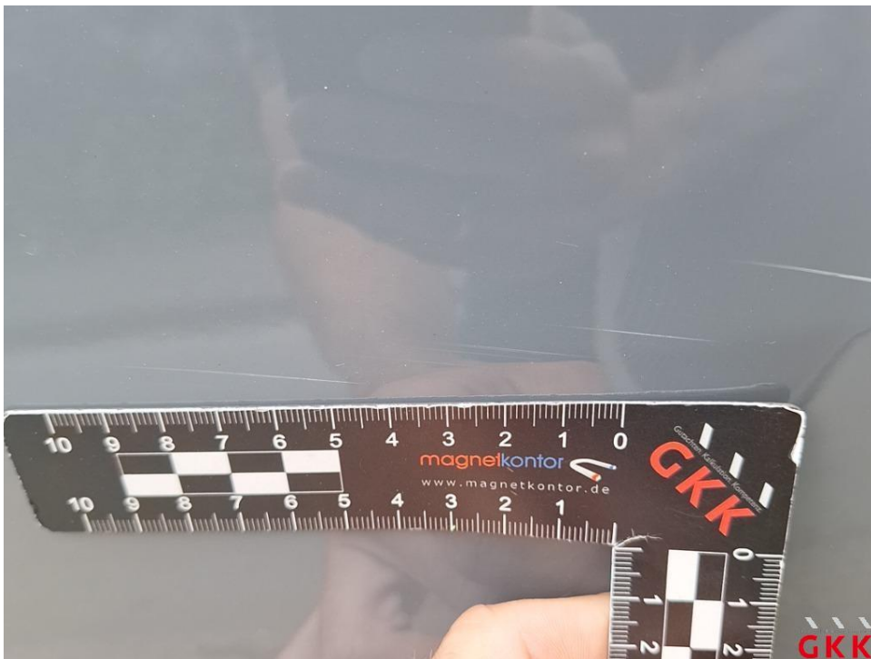
Bild 22. Seitenwand links, verkratzt, auslegen, schleifen, polieren
