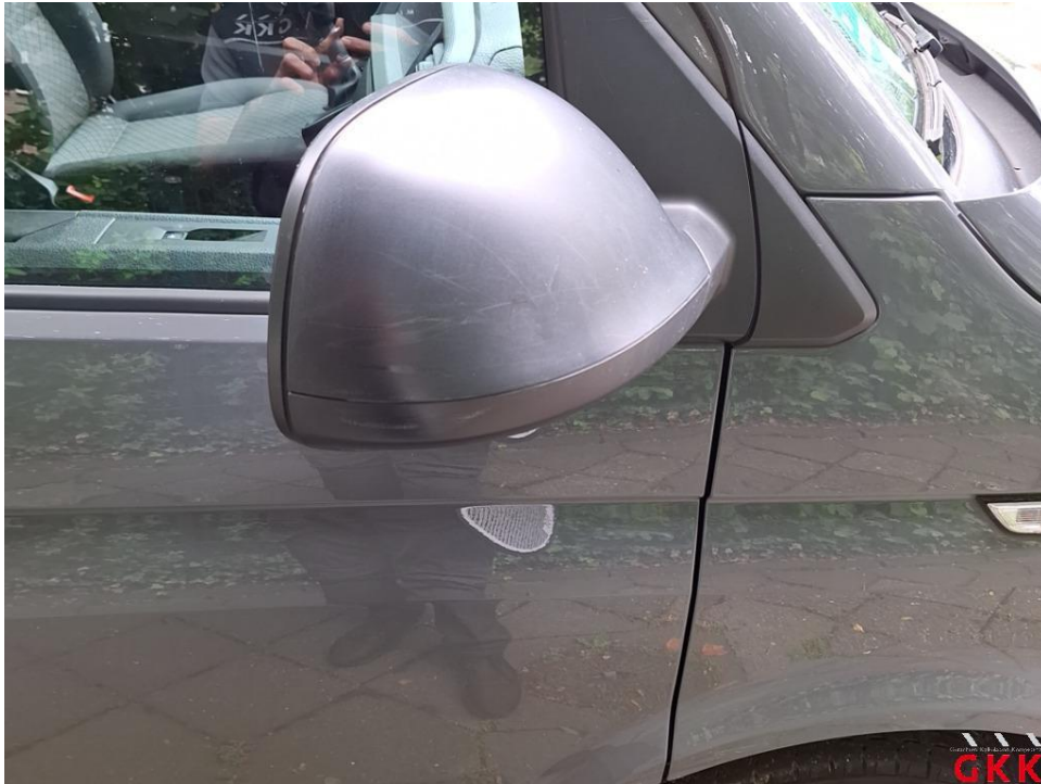
Bild 29. Spiegelgehäuse rechts, Kappe -unlackiert-, verkratzt, Smartrepair
