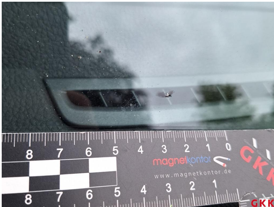
Bild 14. Frontscheibe, wärmedämmend, Steinschlag mit Rissbildung, ersetzen
