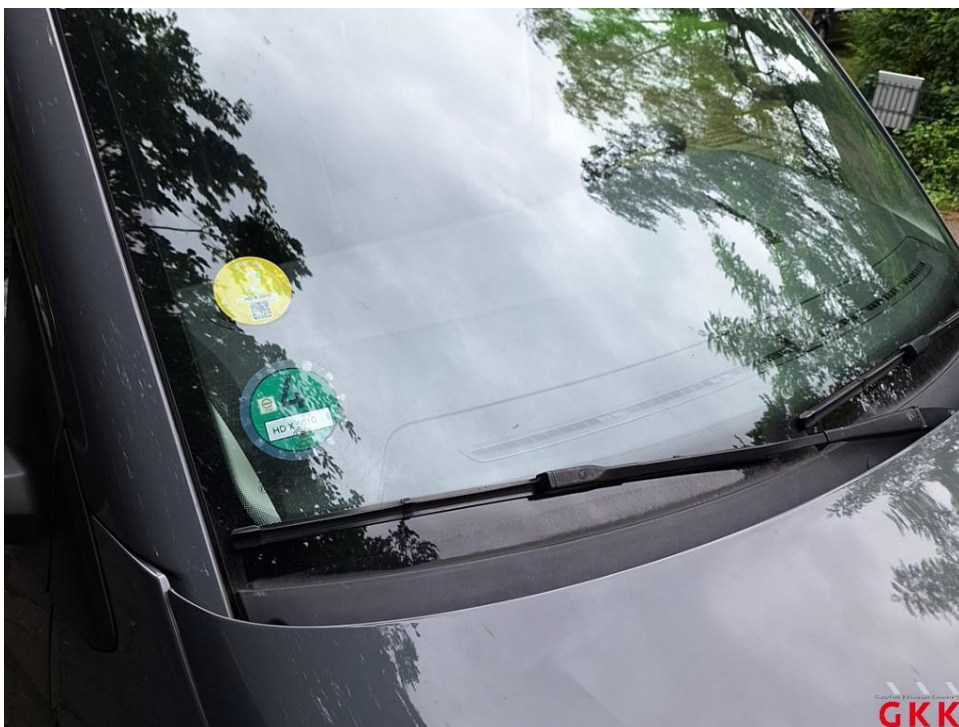
Bild 12. Frontscheibe, wärmedämmend, Steinschlag mit Rissbildung, ersetzen
