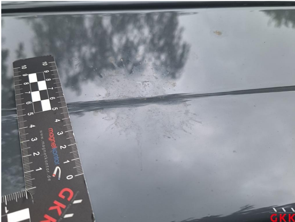
Bild 34. Dach, Lackierung verätzt, aufbereiten
