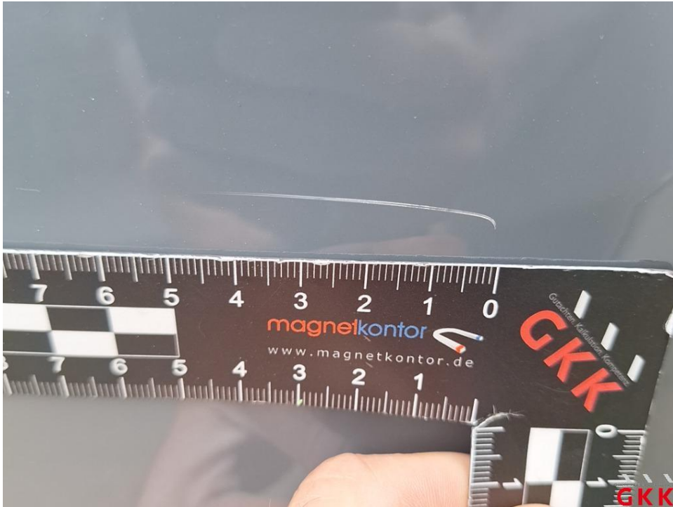
Bild 21. Seitenwand links, verkratzt, auslegen, schleifen, polieren
