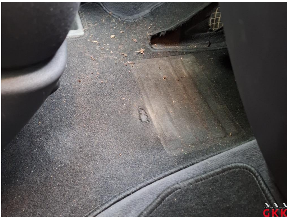
Bild 38. Fußmatte(n), vorne links, beschädigt, ersetzen
