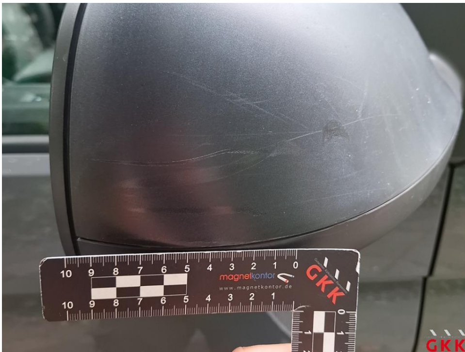
Bild 30. Spiegelgehäuse rechts, Kappe -unlackiert-, verkratzt, Smartrepair
