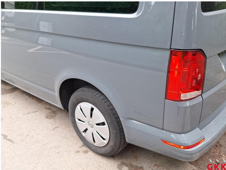
Bild 20. Seitenwand links, verkratzt, auslegen, schleifen, polieren
