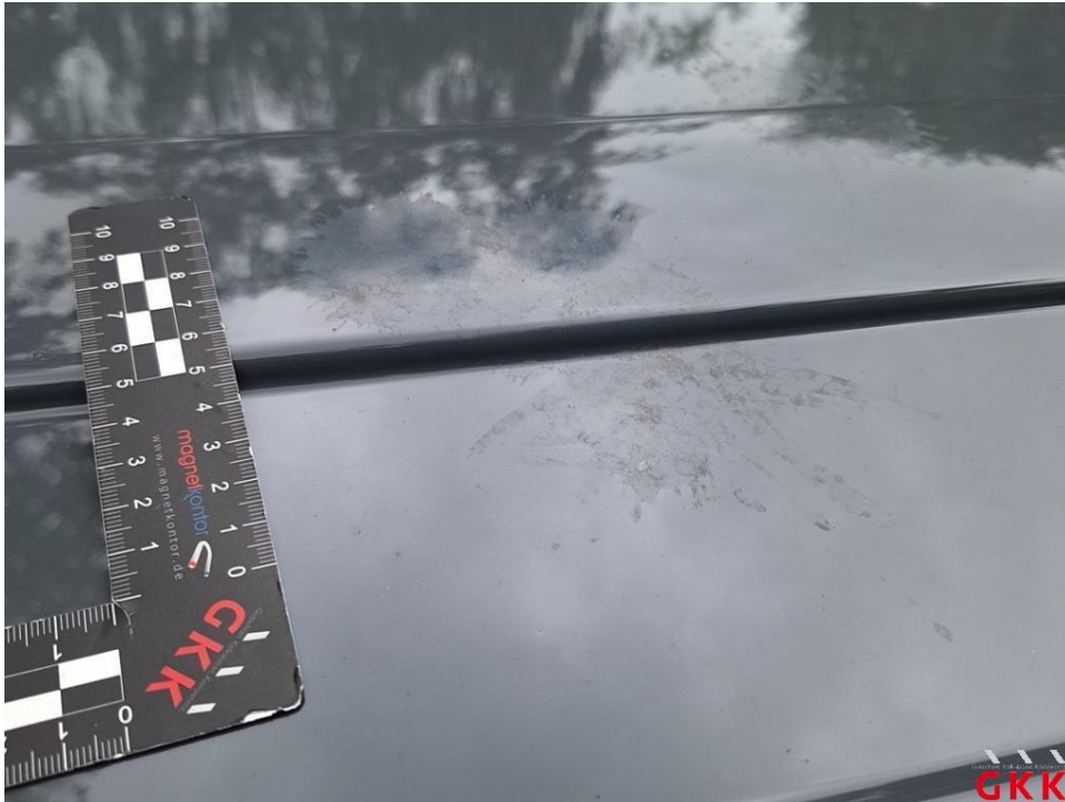
Bild 33. Dach, Lackierung verätzt, aufbereiten
