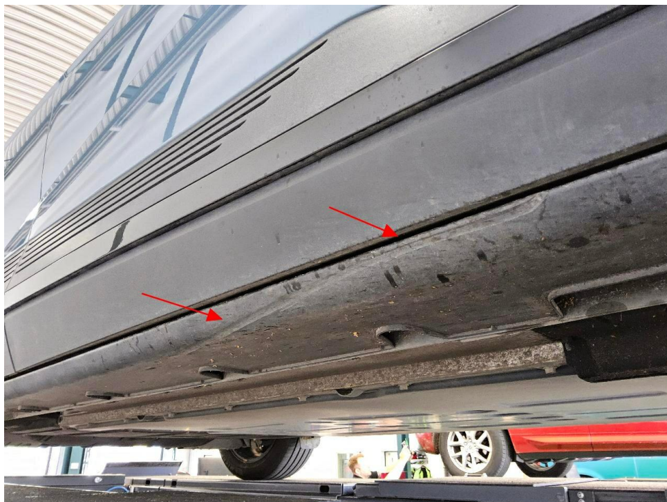
Bild 10 : Schwellerverkleidung rechts verschrammt
