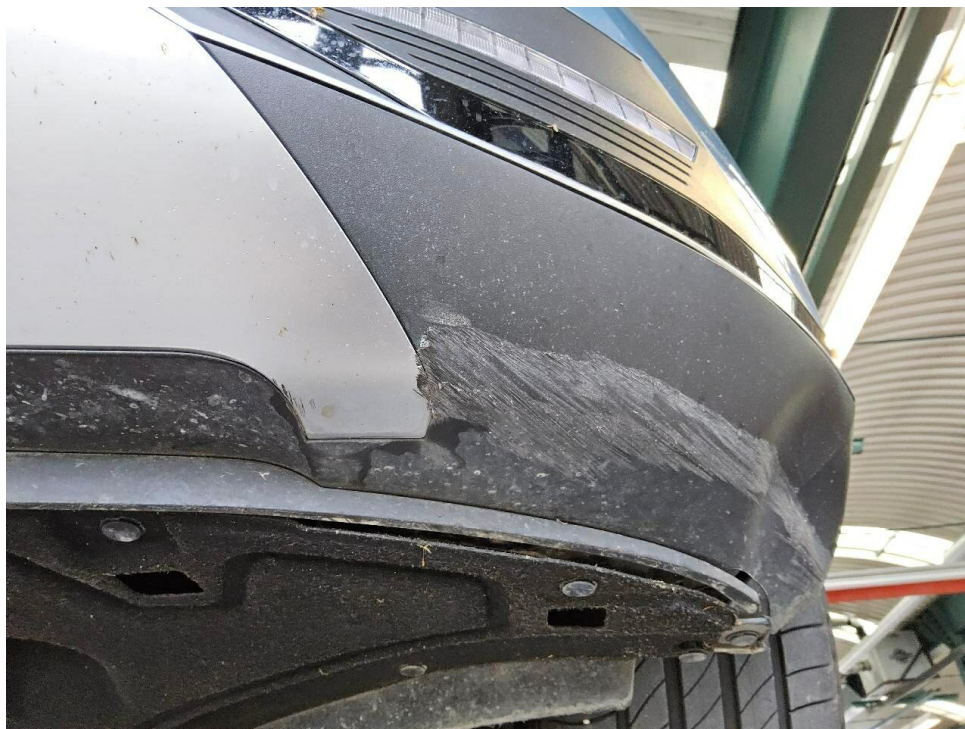
Bild 9 : Frontspoiler vorne links verformt/ destrukturiert/ verschrammt
