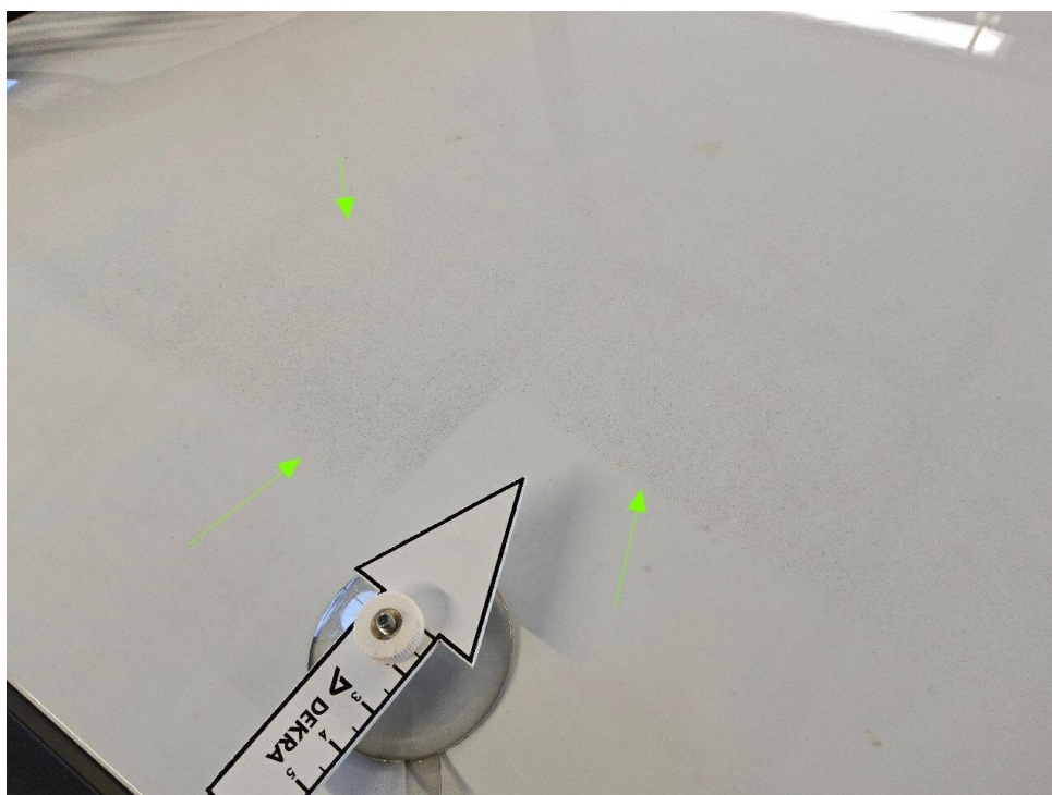
Bild 12 : Dach, Restspuren aus Instandsetzung, noch Dellen vorhanden Lacknebel
